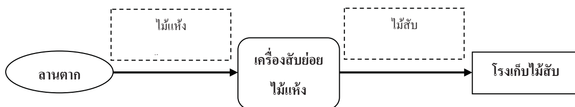
ภาพที่ 2.10 ขั้นตอนการสับย่อยไม้แห้ง (ความชื้นเฉลี่ยร้อยละ 25)
