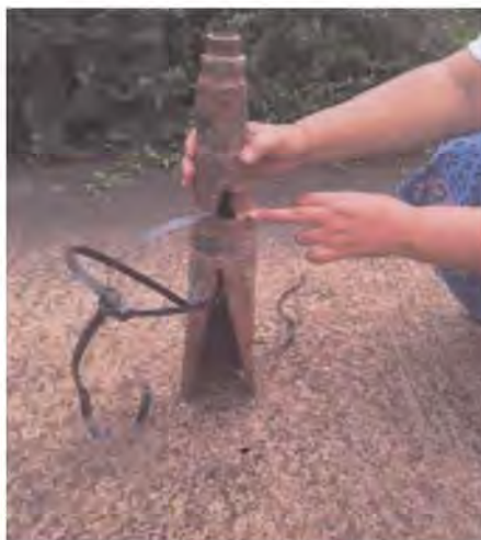
รูปที่ 16 เสียมของลุงอุดมที่ขุดน้ำบาดาลด้วยตัวเอง
