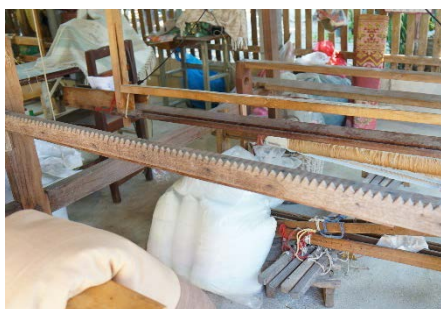
ฟันปลา ใช้สำหรับขยายเส้นฝ้ายไม่ให้พันกัน
