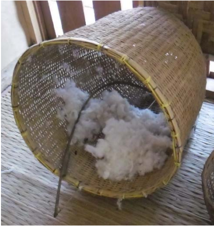
ก้งปดฝ้าย (ก้งตีดฝ้าย) ใช้สำหรับตีดดอกฝ้ายให้ฟูเป็นปุย
