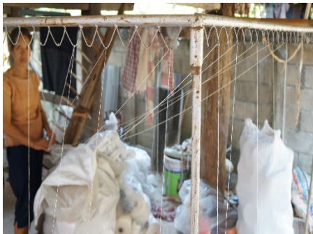
บันไดลิง ใช้สำหรับเรียงเส้นฝ้ายเพื่อกำหนดสี และลายตามที่ต้องการ
