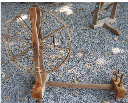
ก้งปั่นฝ้าย (ก้งผัดหลอด) ใช้สำหรับปั่น(ผัด)หลอดฝ้าย
