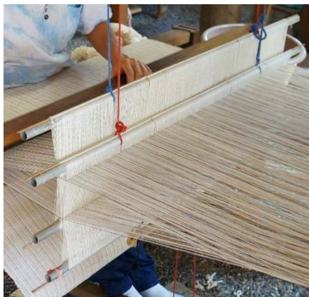
เขา (ตะกอล) ใช้สำหรับสอดเส้นยืนและสลับเส้นยืนกับเส้นพุ่ง
