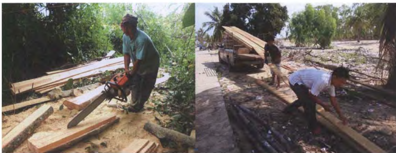
ภาพที่ 61: ภาพช่างตัดไม้กำลังตัดไม้ตามขนาดของแต่ละส่วนที่ใช้ในการต่อเรือ
