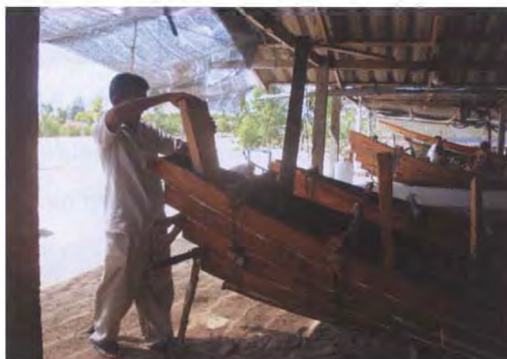
ภาพที่ 67: ภาพการใส่แผ่นไม้เพื่อใช้ยึดรูปทรงของเรือ
