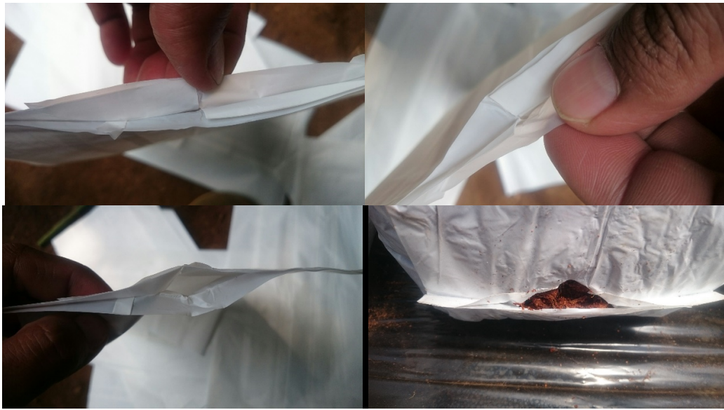
ภาพ 22 การลอกและหลุดบริเวณรอยซีลของถุง Single Seal
