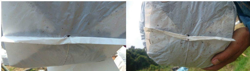
ภาพ 24 ลักษณะการฉีกขาดของถุง Double Seal (DS)
