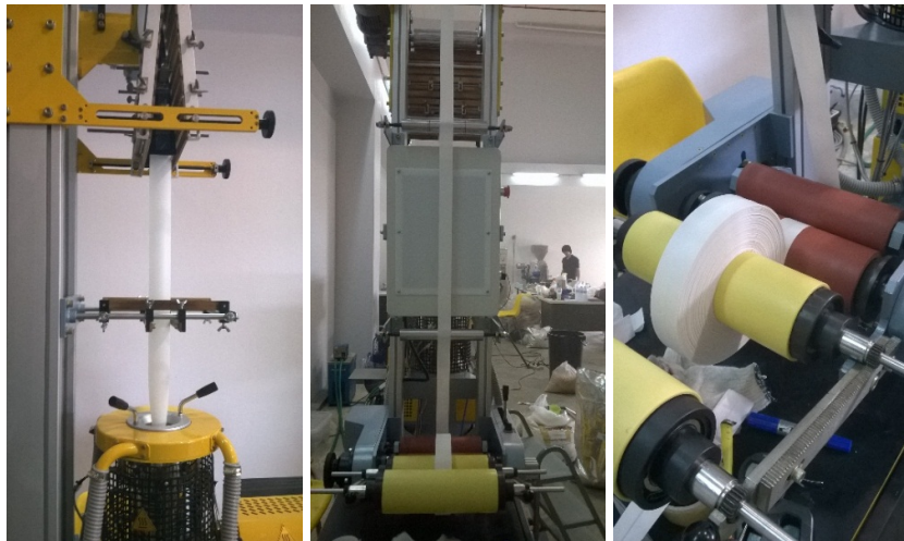
ภาพ 11 ขั้นตอนการเป่าฟิล์มถุงเพาะสูตร13R 3%
