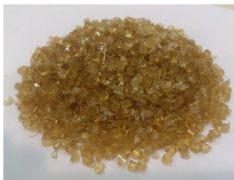
ภาพ 7 เม็ด thermoplastic starch (TPS)
