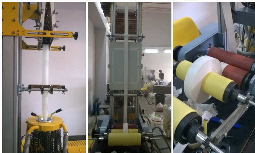
ภาพ 2 ขั้นตอนการเป่าฟิล์มถุงเพาะสูตร 13R
