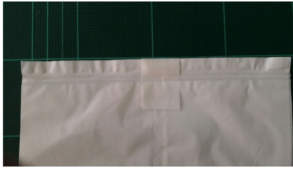
ภาพ 25 ลักษณะรอยซีลของถุง Special Double Seal (SDS)
