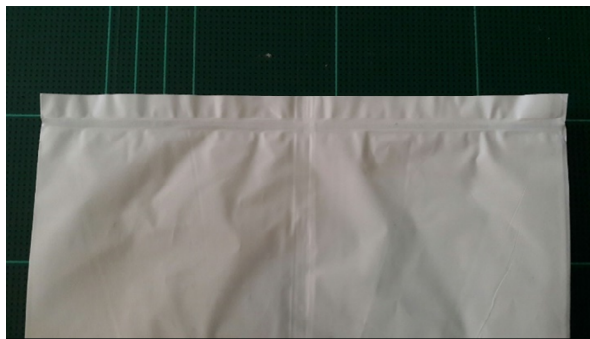
ภาพ 23 ลักษณะรอยซีลของถุง Double Seal (DS)
