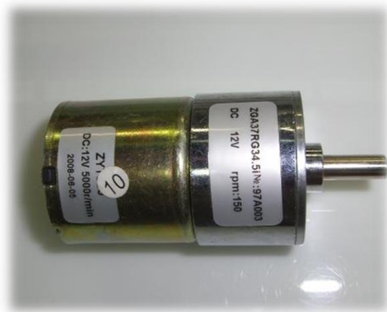
รูปที่ 3.21 มอเตอร์สำหรับชุดอุปกรณ์เขย่าสารเคมี
