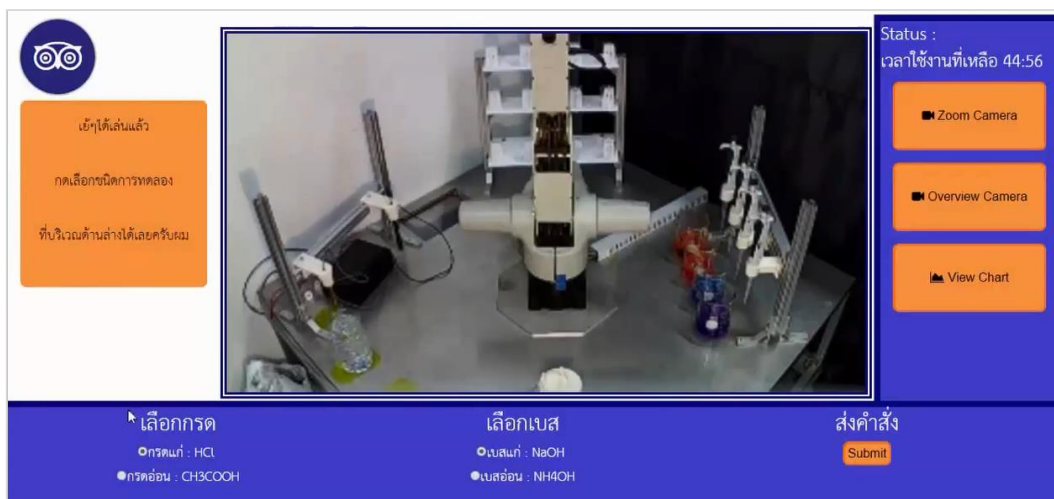
รูปที่ 24 การเลือกชนิดสารเคมีที่จะนำมาทดลองโดยสารที่เตรียมไว้มี 4 ชนิด หลังจากเลือกสารแล้วสั่งให้หุ่นยนต์ทำงาน โดยกดปุ่ม “Submit”
