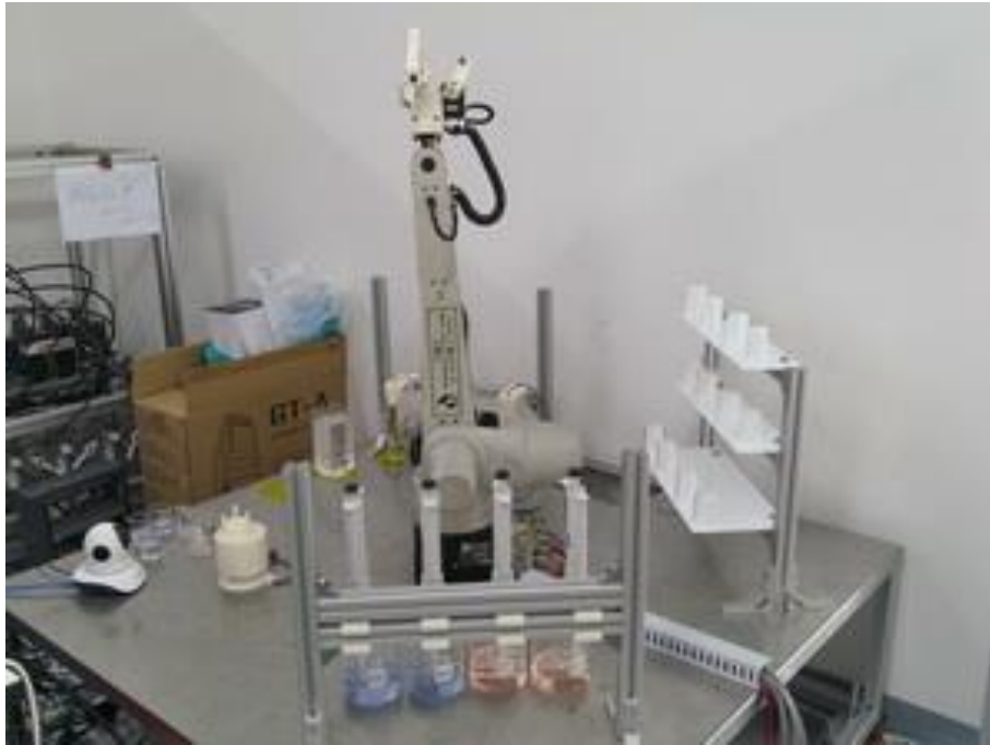
รูปที่ 3 ระบบควบคุมหุ่นยนต์ระยะไกลสำหรับการเรียนรู้การผสมสารเคมี
