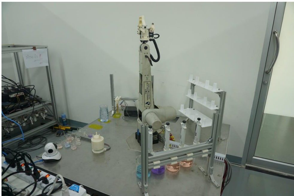
รูประบบควบคุมหุ่นยนต์ระยะไกลสำหรับการเรียนรู้การผสมสารเคมี ถูกติดตั้งไว้ที่ชั้น 2 ของตึกฟิโม่
