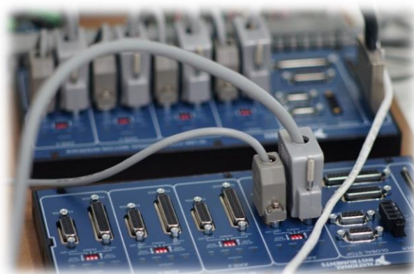
รูปที่ 3.31 ชุดกล่องควบคุมสำหรับเชื่อมต่อสายไฟฟ้าจากหุ่นยนต์กับชุดควบคุมการเคลื่อนที่
