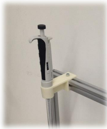
รูปที่ 3.17 ที่วางไมโครปีเปตที่ได้ทำการสร้างที่สถาบันฯ
