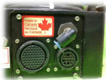
รูปที่ 3.25 ชุดคอนเนคเตอร์แบบ CPC-57 และ CPC-14 ของหุ่นยนต์ซีอาร์เอส (CRS Robot)
