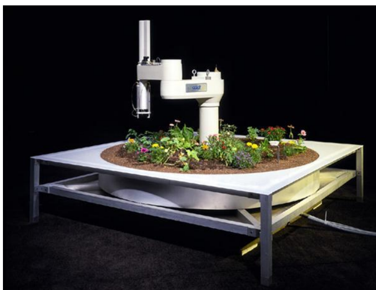
รูปที่ 2.2 ระบบควบคุมหุ่นยนต์ระยะไกลเพื่อการทำสวนขนาดเล็ก
