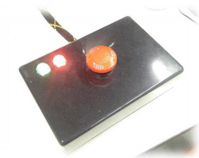
รูปที่ 3.35 ปุ่มหยุดฉุกเฉิน
