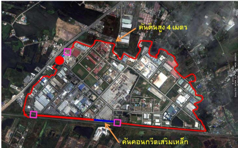
ภาพที่ 7 ระบบป้องกันน้ำท่วมของโครงการปรับปรุงระบบป้องกันน้ำท่วมในนิคมอุตสาหกรรมบางปะอิน
