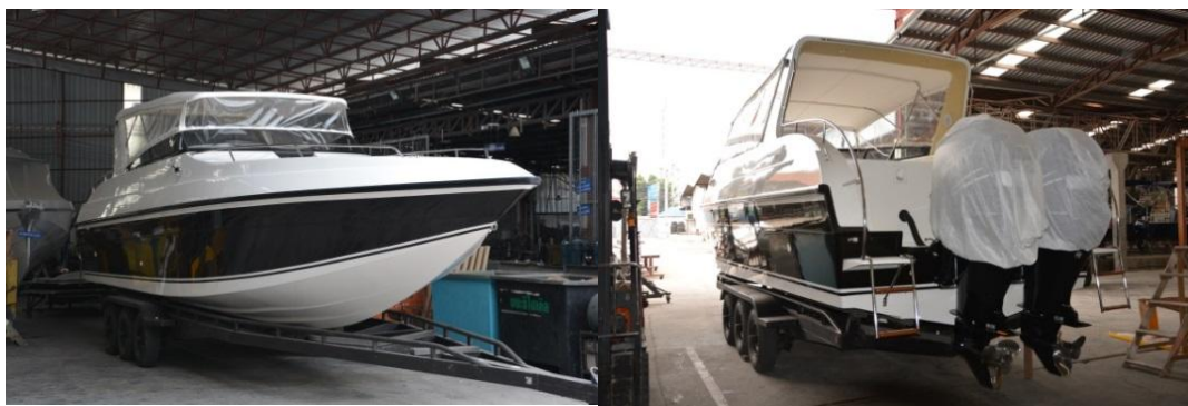
รูปที่ 3.1 ลักษณะของเรือเร็วที่มีโครงสร้างเป็นไฟเบอร์กลาส
