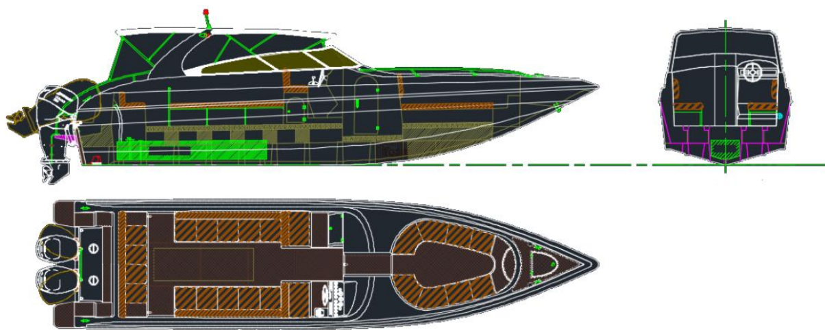
รูปที่ 3.3 แบบจำลอง 3 มิติ ของเรือเร็วที่มีโครงสร้างเป็นไฟเบอร์กลาส
