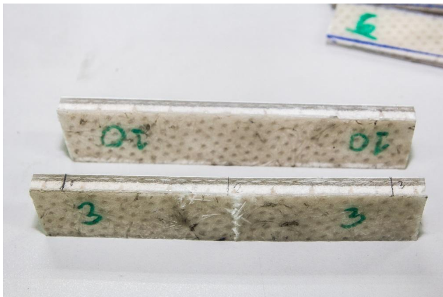
รูปที่ 3.12 แสดงถึงวัสดุที่แตกหัก (ชิ้นล่าง) กับวัสดุที่ไม่แตกหัก (ชิ้นบน)
