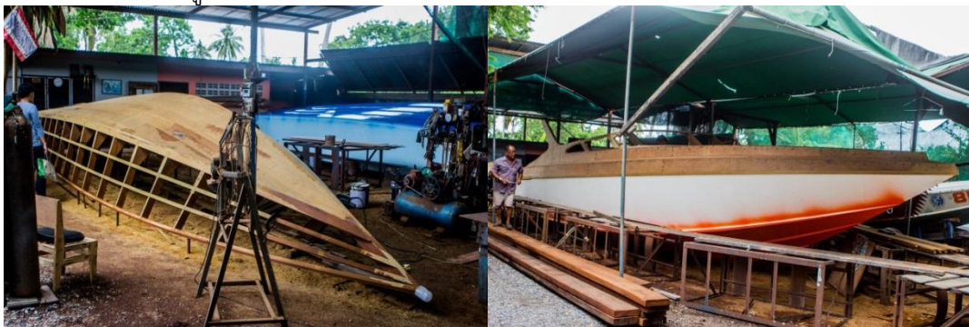
รูปที่ 3.2 ลักษณะของเรือเร็วที่มีโครงสร้างเป็นไม้
