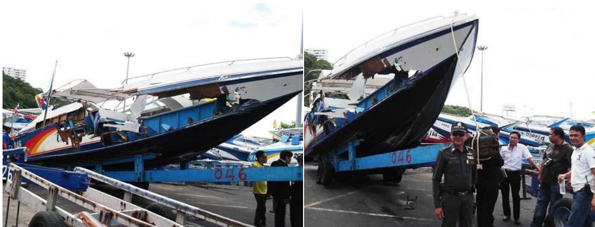
รูปที่ 2.1 ความเสียหายของเรือเร็วในกรณีเกิดเรือโดนกัน [1]
