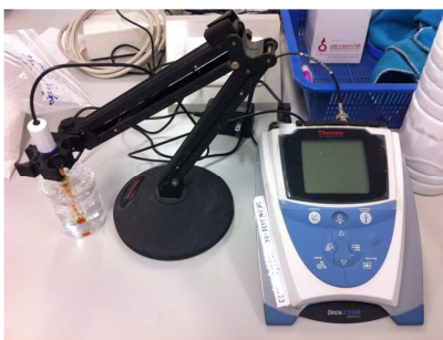
รูปที่ 2.8 pH Meter Orion สำหรับทดสอบความเป็นกรด-ด่างของสารละลายที่สกัดได้จากถุงมือยาง
