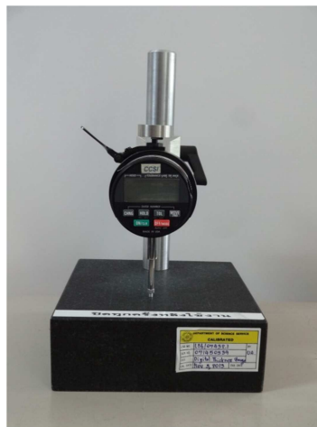
รูปที่ 2.4 Thickness gauge สำหรับวัดความหนาของถุงมือ
