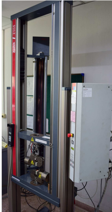
รูปที่ 2.6 Tensile testing machine Zwick Z005 equipped with Optical extensometer สำหรับวัดความต้านแรงดึงและความยืดเมื่อขาดของถุงมือยาง
