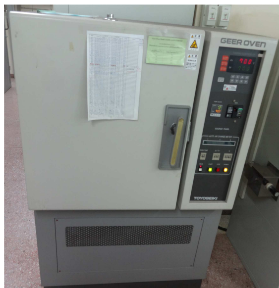
รูปที่ 2.7 Geer oven Toyoseiki Model ACR-45A สำหรับการบ่มแรงตัวอย่างถุงมือยาง
