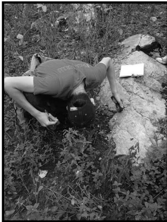
ภาพที่ 6.2 ทำการวัดทิศทางการวางตัวของหิน พิกัด 47Q 0440663 UTM 2125846
