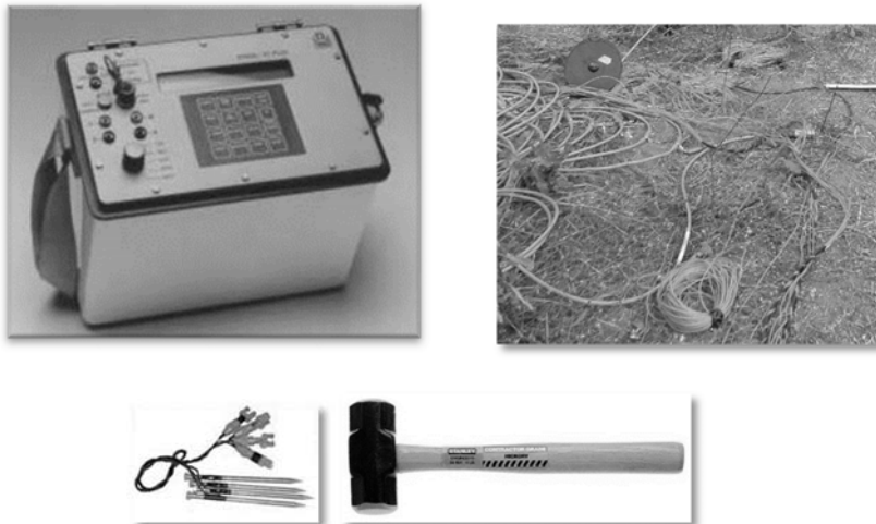
ภาพที่ 3.19 เครื่องมือวัดสภาพต้านทานไฟฟ้า IRIS รุ่น R1 PLUS 48 channel ( www.ipgp.fr ) สายเคเบิล ตัวคีบ ขั้วอิเล็กโทรด( http://new.wtsgco.com/en/product/optional-accessories-of-electronic-instruments.html ) และค้อน ( www.stanley-thailand.com )
