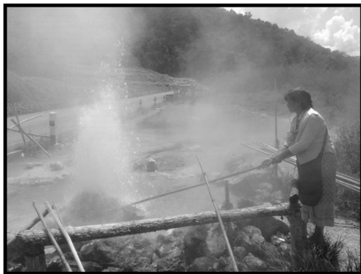
ภาพที่ 6.8 การเก็บตัวอย่างน้ำพุร้อนโดยใช้ถังน้ำ
