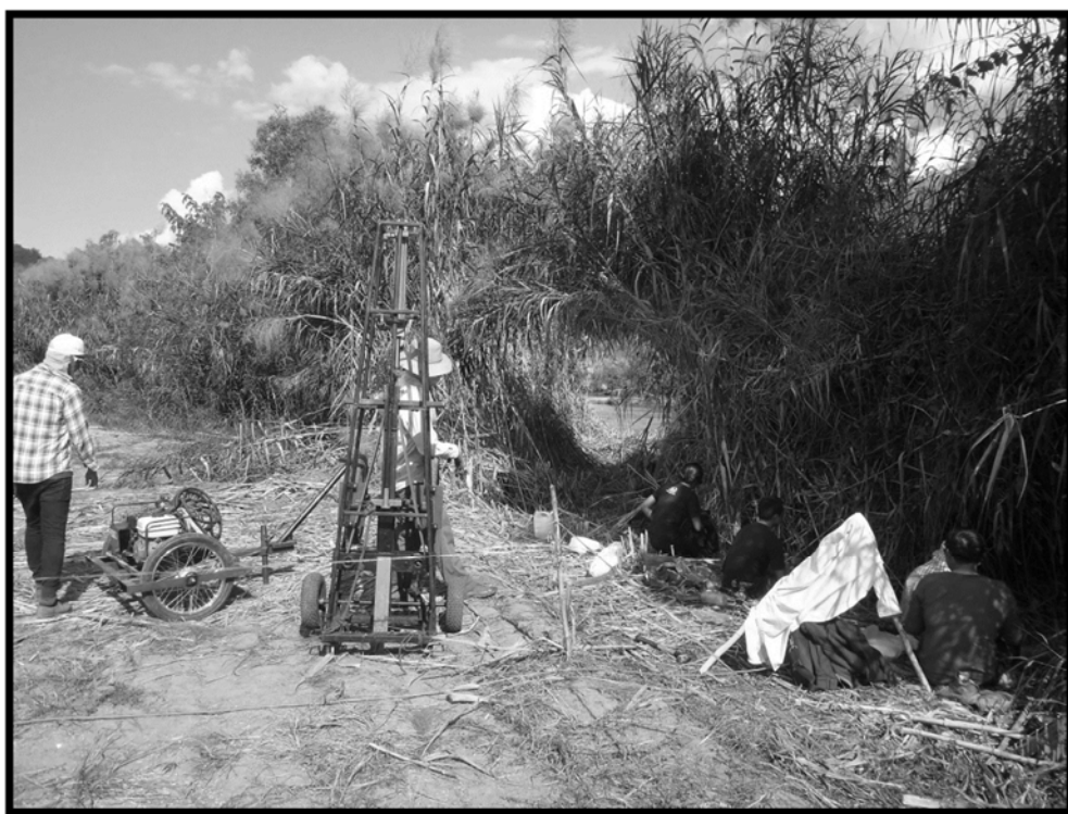
ภาพที่ 6.28 การเตรียมเครื่องให้กำเนิดคลื่นไหวสะเทือน (weight drop)
