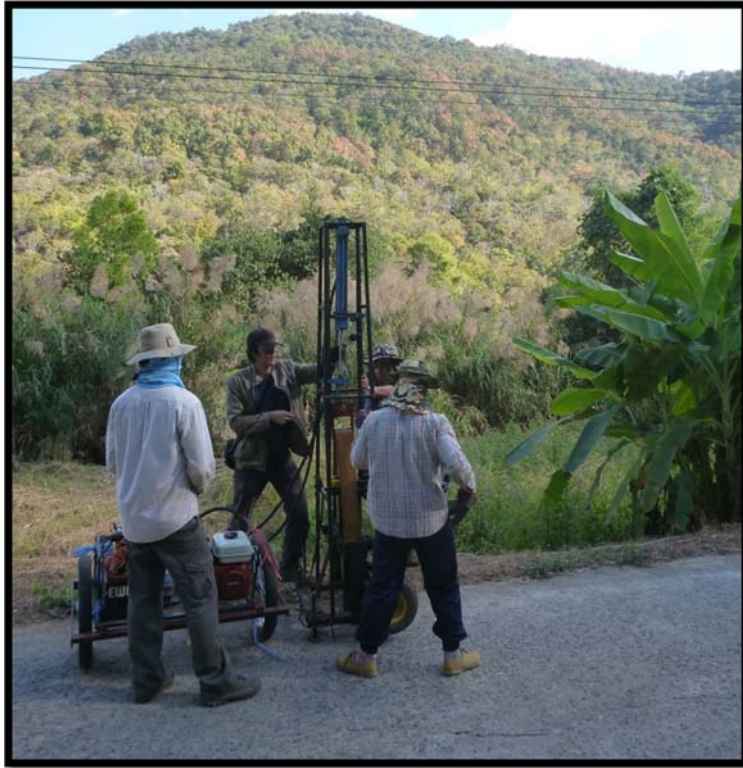
ภาพที่ 3.34 การทำงานของเครื่องมือกำเนิดคลื่นไหวสะเทือนแบบกระแทก (weight drop) ที่สำรวจตามแนวถนน
