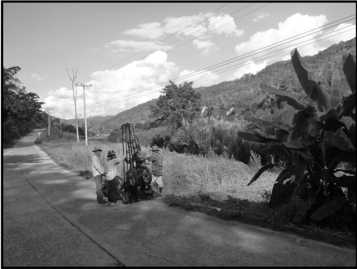
ภาพที่ 6.29 การกำเนดคลื่นไหวสะเทือนบนถนนจากเครื่องให้กำเนดคลื่นไหวสะเทือน (weight drop)
