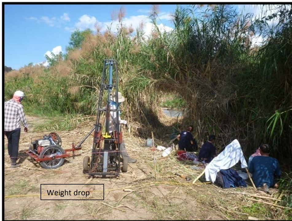
ภาพที่ 3.33 เครื่องมือแหล่งกำเนิดคลื่นไหวสะเทือนแบบกระแทก (weight drop) ที่ทำงานในภูมิประเทศ
