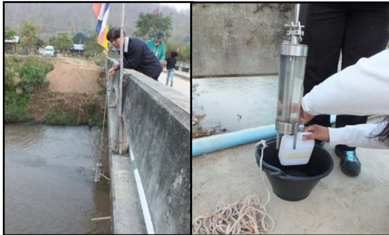
ภาพที่ 3.50 (ภาพซ้าย)การเก็บตัวอย่างน้ำโดยใช้กระบอกลอยเก็บน้ำ (water sampler) และ(ภาพขวา)บรรจุใส่ขวดเก็บตัวอย่าง
