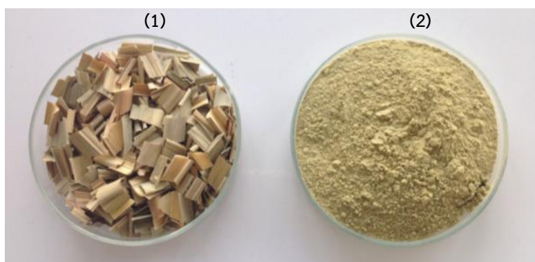
ภาพที่ 1 ตัวอย่างใบอ้อยที่ตัดขนาดประมาณ 1 cm. (1) และผ่าน hammer mill sieve ขนาด 0.2 mm. (2)
