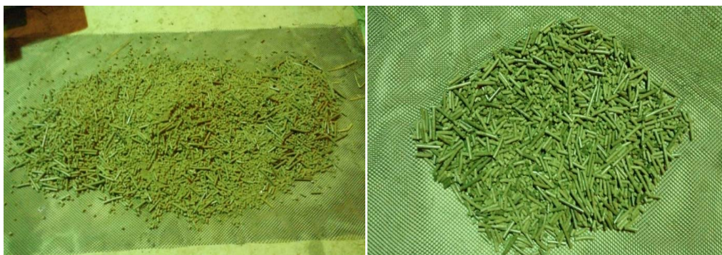
รูปภาพที่ 4.12 ผลผลิตเม็ดเชื้อเพลิงชีวมวลยอดและใบอ้อยที่ได้จากการทดสอบ
