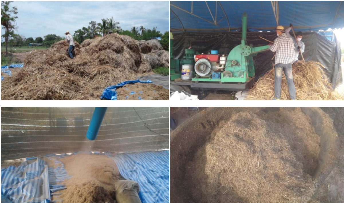
รูปภาพที่ 4.13 แสดงผลการทดสอบอัตราการผลิตของเครื่องจักรดียวชีวมวลยอดและใบอ้อย
