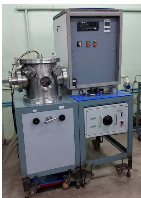
รูปที่ 4-4 ลักษณะและไดอะแกรมของเครื่องเคลือบระบบสปัตเตอร์ริงในโครงการย่อยที่ 3
