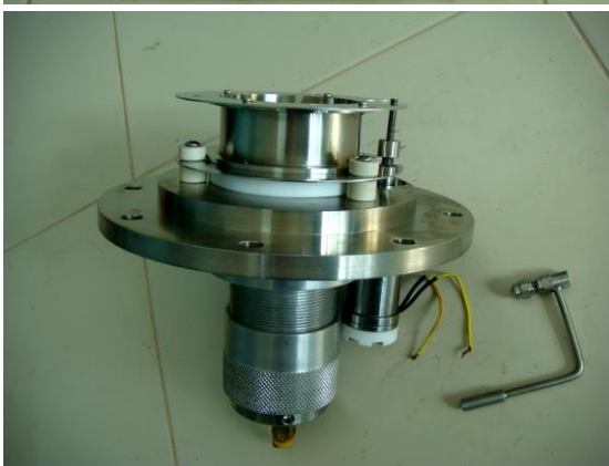
รูปที่ 2-12 ส่วนประกอบและลักษณะของแหล่งกำเนิดสารเคลือบแบบคาโทดิกอาร์ค
