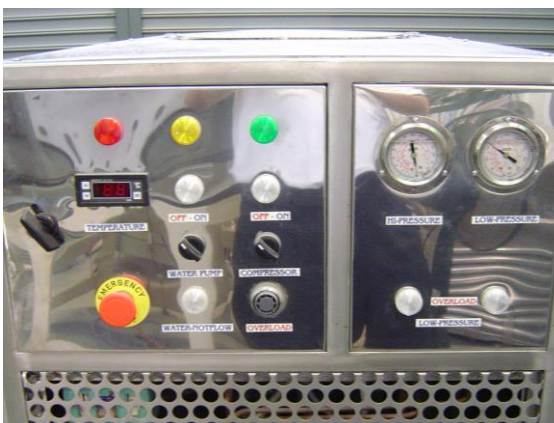
รูปที่ 2-9 ระบบน้ำหล่อเย็นของแหล่งกำเนิดสารเคลือบแบบคาโทดิกอาร์ค
