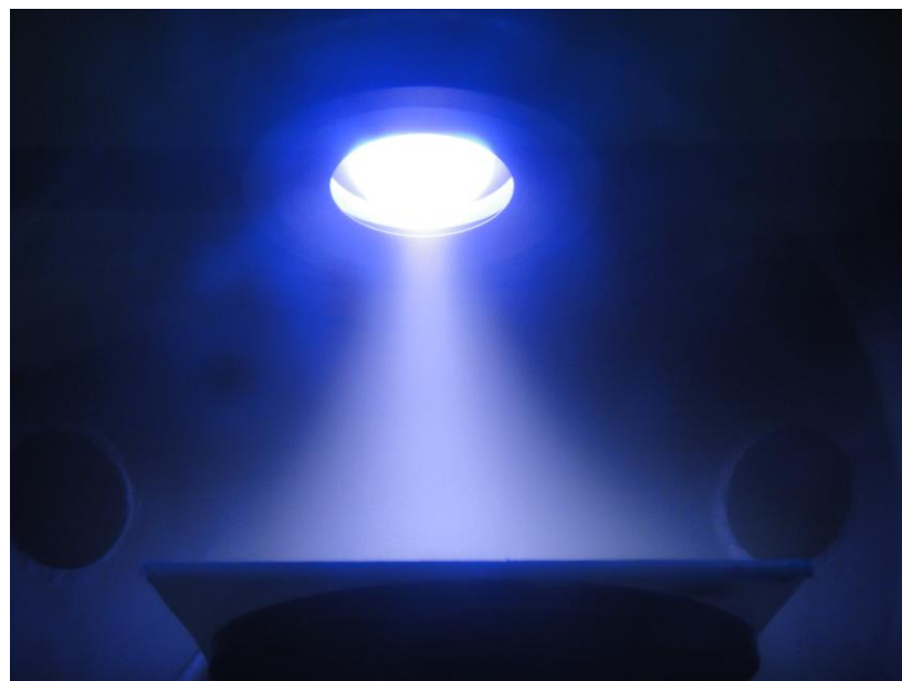
รูปที่ 3-4 ลักษณะพลาสมาของเครื่องเคลือบระบบสปัตเตอร์ริงในโครงการวิจัยย่อยที่ 2
