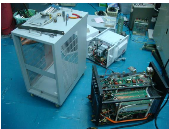
รูปที่ 2-8 ภาคว่างไฟฟ้าของแหล่งกำเนิดสารเคลือบแบบคาโทดิกอาร์ค
