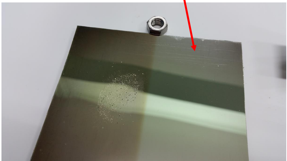
รูปที่ 4-25 ผลการทดสอบการขีดขีดของฟิล์มอะลูมิเนียมออกไซด์
