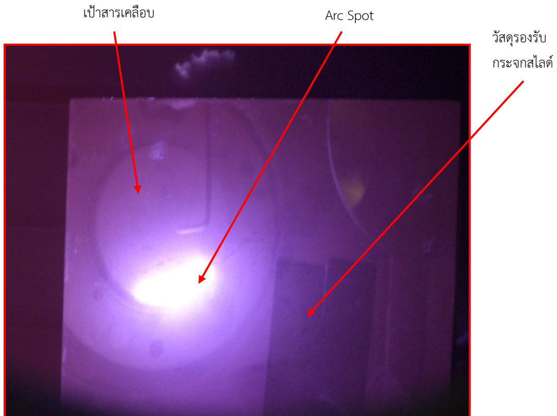
รูปที่ 2-19 ลักษณะการวางวัสดุรองรับและตำแหน่งของ Arc Spot ที่เกิดขึ้นบริเวณหน้าเป้าสารเคลือบ ที่เคลื่อนที่ไปรอบๆ หน้าเป้าสารเคลือบ เนื่องจากสนามแม่เหล็กที่ติดตั้งไว้หลังเป้าสารเคลือบ
