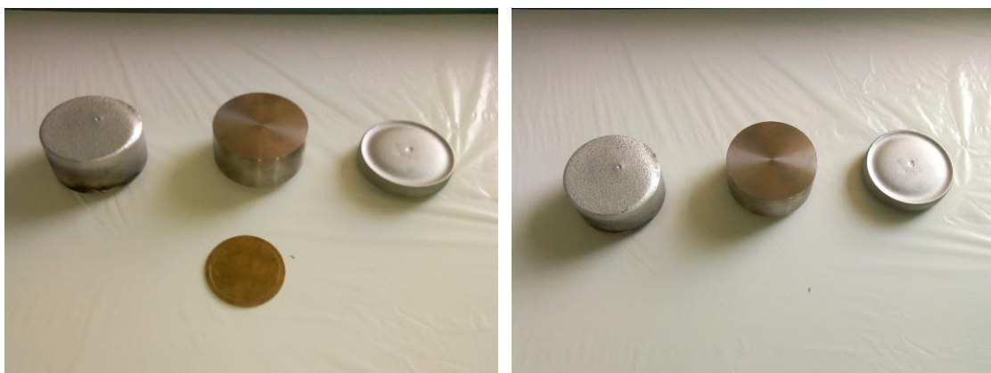
รูปที่ 2-14 ลักษณะสารเคลือบของแหล่งกำเนิดสารเคลือบแบบคาโทดิกอาร์ค
