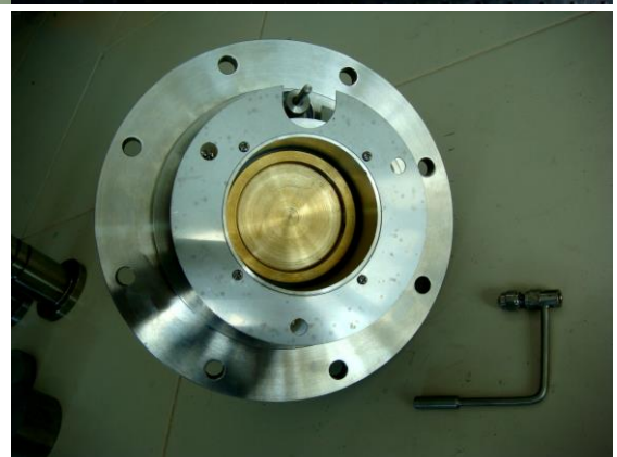
รูปที่ 2-12 ส่วนประกอบและลักษณะของแหล่งกำเนิดสารเคลือบแบบคาโทดิกอาร์ค
