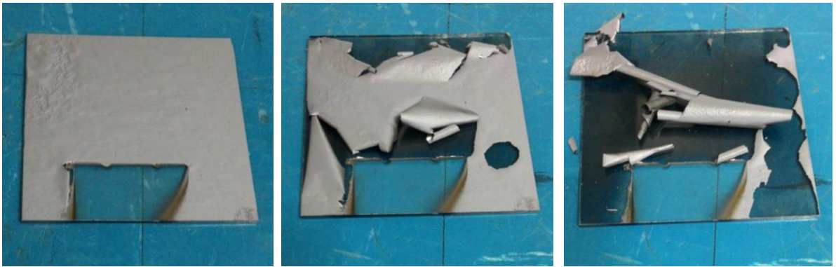
รูปที่ 2-21 ลักษณะฟิล์มที่เคลือบได้บนกระจกแผ่นเรียบที่ใช้ทดสอบการเคลือบ
