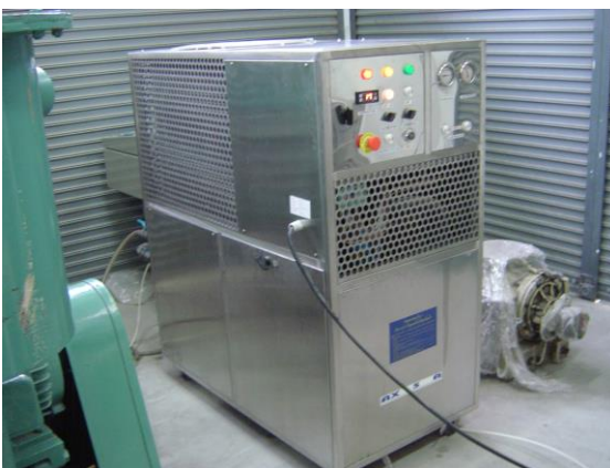
รูปที่ 2-9 ระบบน้ำหล่อเย็นของแหล่งกำเนิดสารเคลือบแบบคาโทดิกอาร์ค
