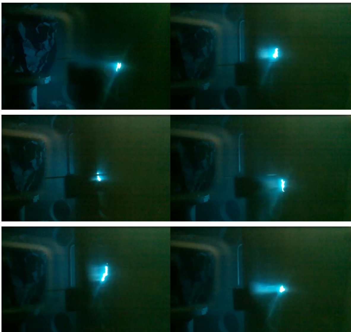
รูปที่ 2-18 การอาร์คของแหล่งกำเนิดสารเคลือบแบบคาโทดิกอาร์คขณะทำงาน
