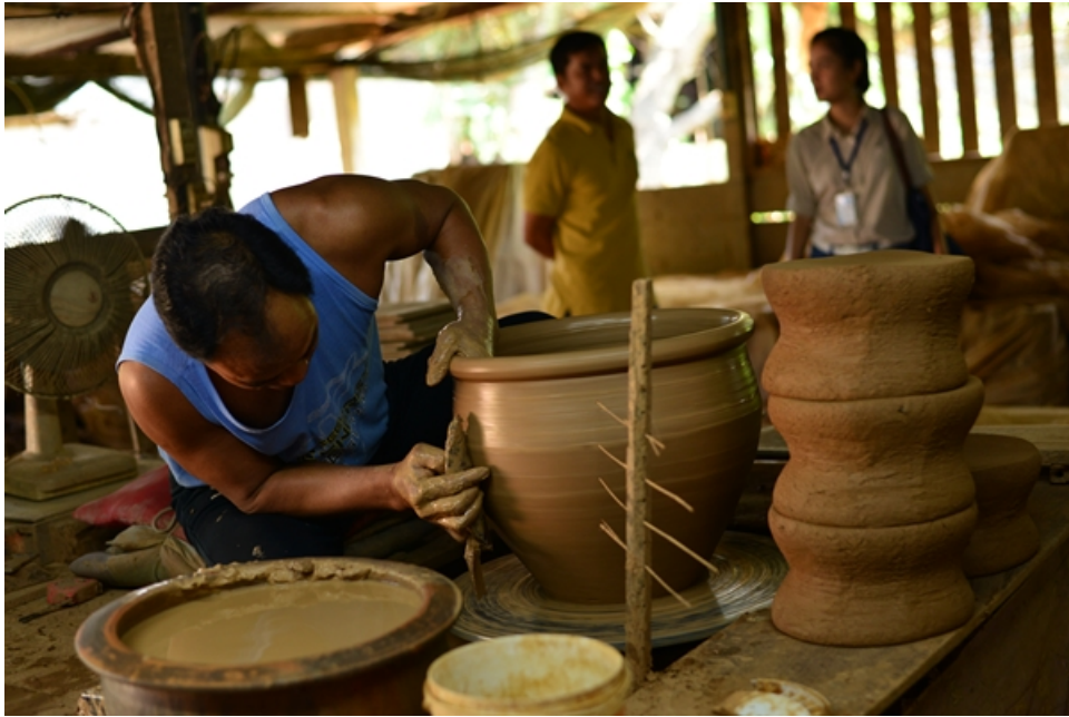
ภาพที่ 7-2 การปั้นขึ้นรูปด้วยแท่นหมุน
