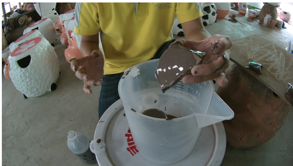
ภาพที่ 8-15 การหุบเคลือบบนชิ้นงานผลิตภัณฑ์ของ โรงงาน
