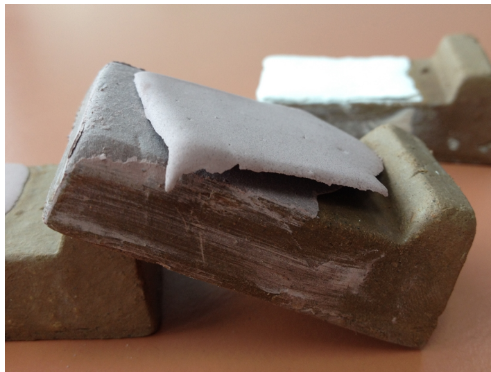
ภาพที่ 8-13 ลักษณะผิวเคลือบบนชิ้นงานทดสอบที่เกิดการหลุดร่อนก่อนการเผาของสูตรเคลือบ 8-2
