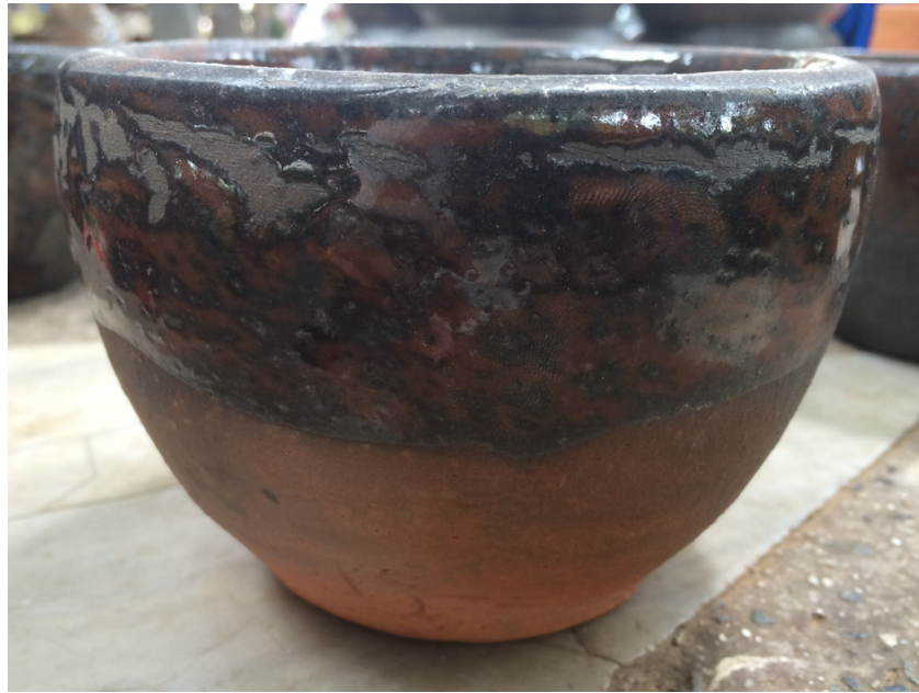
ภาพที่ 6-15 ผลการเผาเคลือบบนชิ้นงานผลิตภัณฑ์ของ โรงงาน หุบเคลือบบนเนื้อดินที่ผ่านการเผาบิสกิตก่อน แล้วจึงเผาเคลือบ
