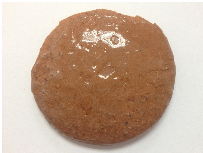
ภาพที่ 7-14 ลักษณะผิวเคลือบ สูตรเคลือบ 7-1 หลังเผาที่อุณหภูมิ 1,000 °C
