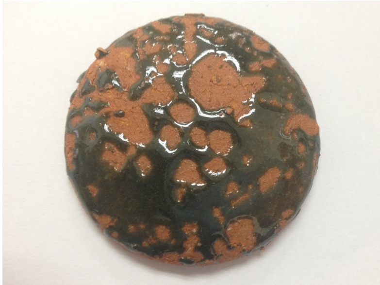
ภาพที่ 8-12 ลักษณะผิวเคลือบ สูตรเคลือบ 8-1 หลังเผาที่อุณหภูมิ 1,000 °C
