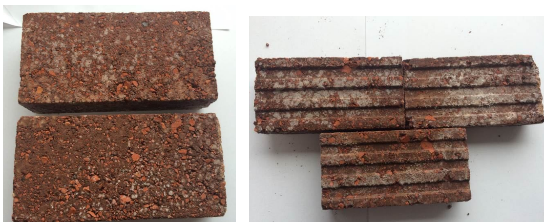
ภาพที่ 2-6 ตัวอย่างผลิตภัณฑ์อิพอลิเมอร์ต้นแบบที่โรงงานทดลองผลิต
