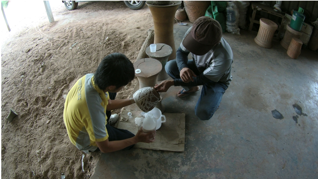
ภาพที่ 7-16 การชูปเคลือบบนชิ้นงานผลิตภัณฑ์ของโรงงาน
