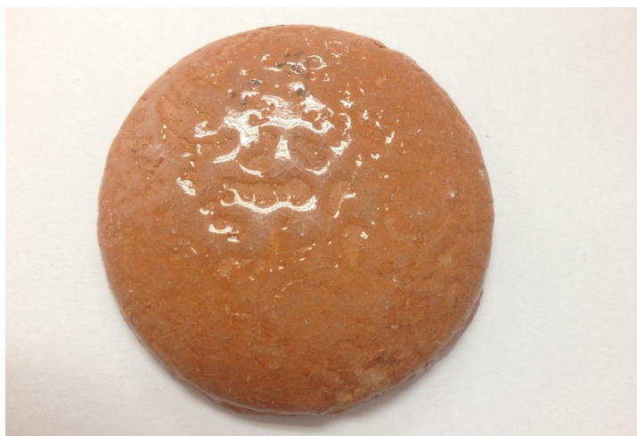
ภาพที่ 6-12 ลักษณะผิวเคลือบ สูตรเคลือบ 6-1 หลังเผาที่อุณหภูมิ 950 °C
