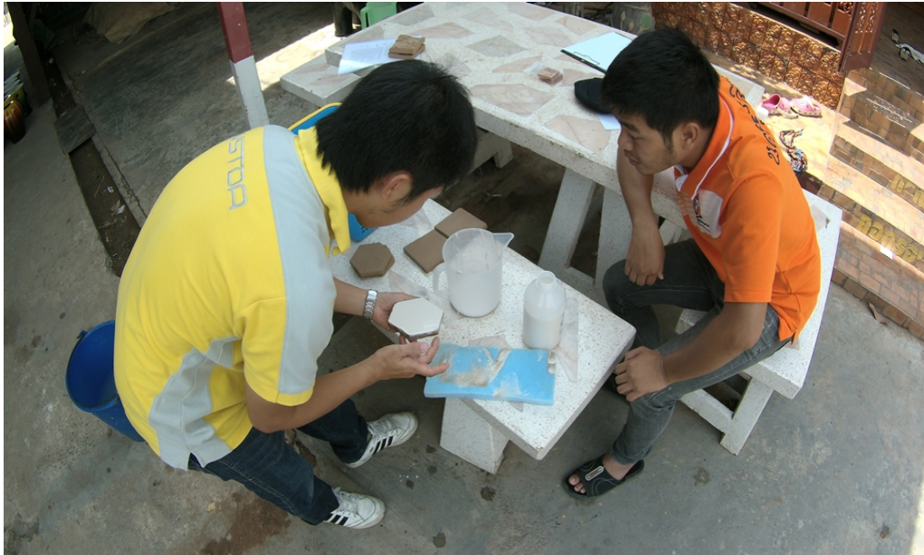
ภาพที่ 5-6 การชูปเคลือบบนชิ้นงานผลิตภัณฑ์ของโรงงาน
