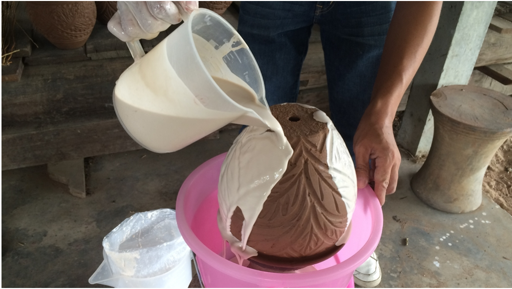
ภาพที่ 7-18 การชุบเคลือบบนผลิตภัณฑ์ของโรงงาน
