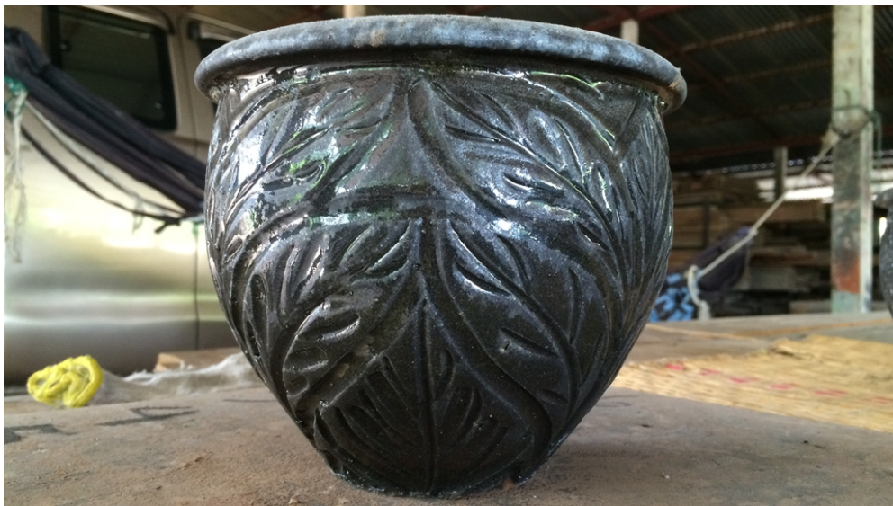
ภาพที่ 7-19 ผลการเผาเคลือบครั้งที่ 2 บนผลิตภัณฑ์ของโรงงาน ที่วางชิ้นงานเข้าเผาในตำแหน่งด้านหน้าเตา
