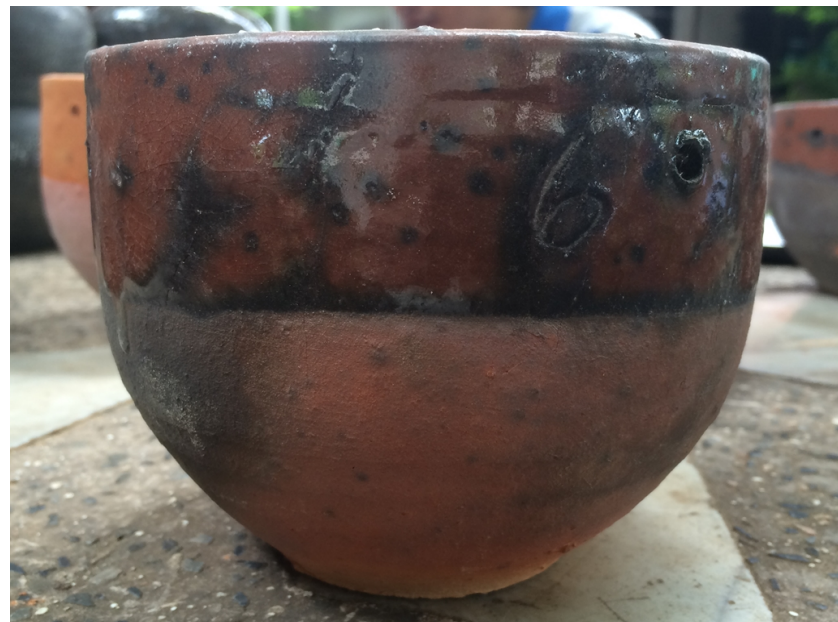
ภาพที่ 6-16 ผลการเผาเคลือบบนชิ้นงานผลิตภัณฑ์ของ โรงงาน หุบเคลือบบนเนื้อดินดิบทั้งหมด เผาครั้งเดียว
