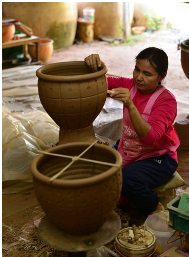
ภาพที่ 7-3 การตกแต่งชิ้นงานขึ้นรูปด้วยวิธีการแกะลาย
