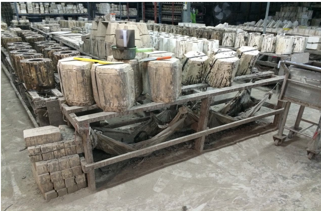
ภาพที่ 2 ขั้นตอนการหล่อน้ำดินของโรงงานลักษิกา 917
