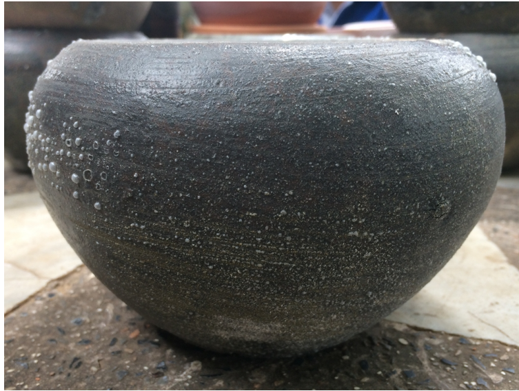
ภาพที่ 6-17 ผลการเผาเคลือบบนชิ้นงานผลิตภัณฑ์ของโรงงาน หุบเคลือบบนเนื้อดินดิบแห่งหมาด เเผาครั้งเดียว
