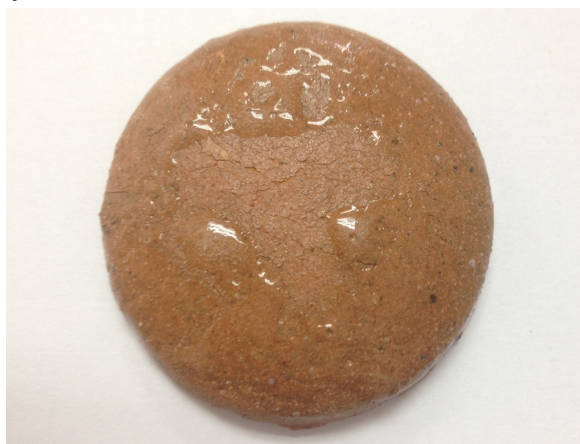
ภาพที่ 5-4 ลักษณะผิวเคลือบ สูตรเคลือบ 5-1 หลังเผาที่อุณหภูมิ 1,050°C
