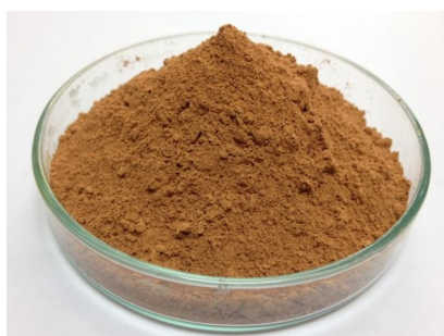
ภาพที่ 2-4 ดินแดงอ่างทองบดละเอียดผ่านตะแกรง 100 เมช หลังเผาแคลไซน์ที่ 600^\circ\text{C}
