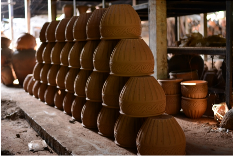
ภาพที่ 7-4 การฝั่งลมชิ้นงานขึ้นรูปก่อนนำไปเผา
