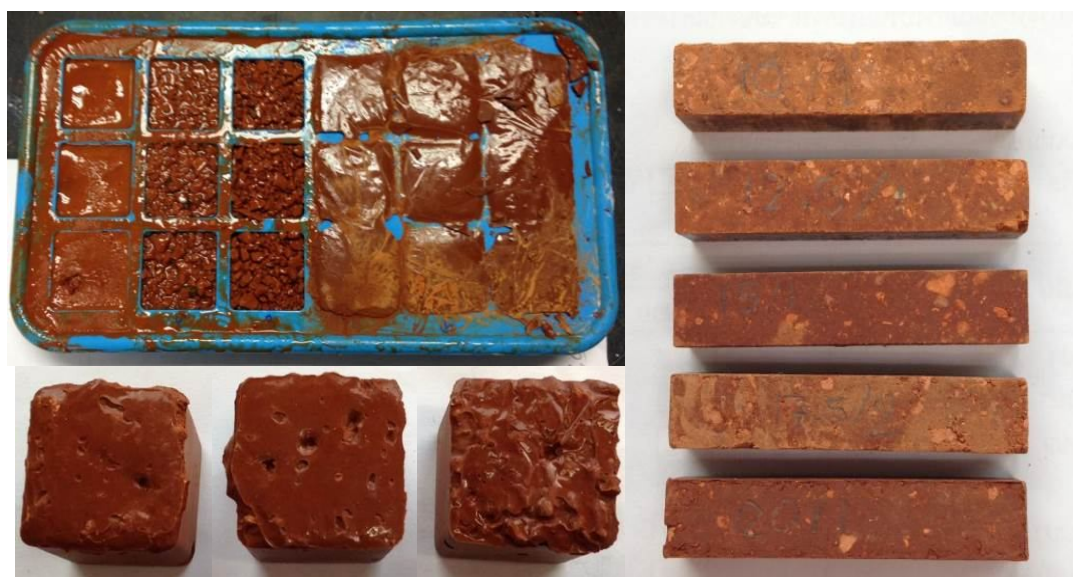
ภาพที่ 2-5 ตัวอย่างชิ้นงานทดลองที่ทำการขึ้นรูปแบบหล่อและแบบอัด
