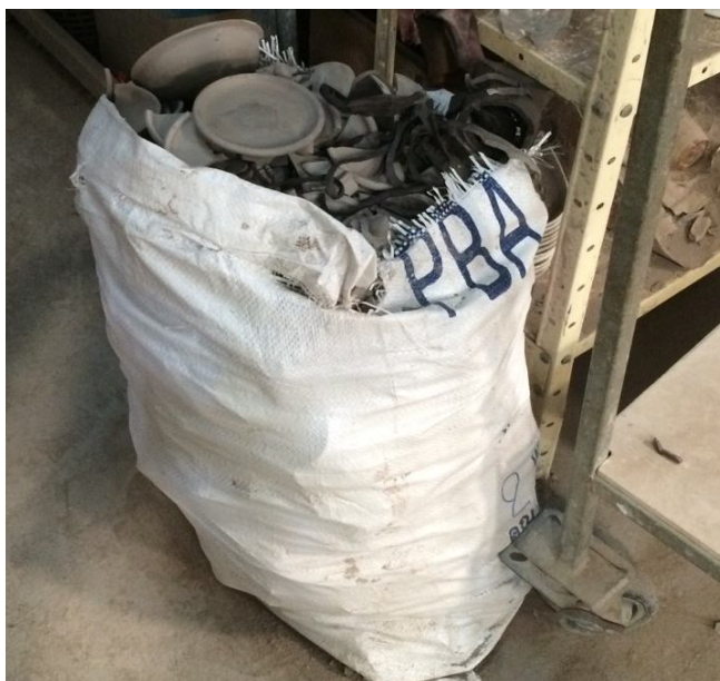
ภาพที่ 1 เศษดินเสียหายจากการขึ้นรูป นำกลับไปผสมรวมกับน้ำดินใหม่
