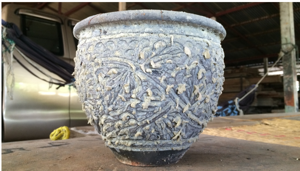
ภาพที่ 7-20 ผลการเผาเคลือบครั้งที่ 2 บนผลิตภัณฑ์ของโรงงาน ที่วางชิ้นงานเข้าเผาในตำแหน่งด้านท้ายเตา
