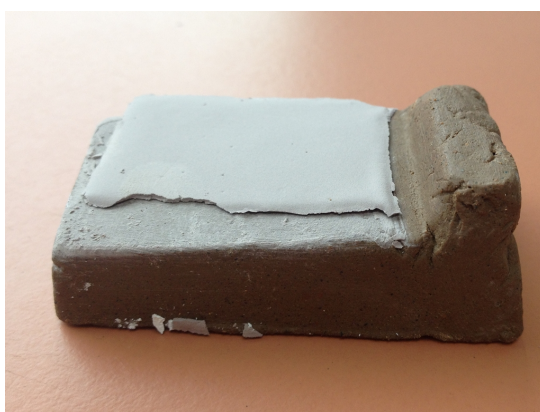
ภาพที่ 7-15 ลักษณะผิวเคลือบบนชิ้นงานทดสอบที่เกิดการหลุดร่อนก่อนการเผาของสูตรเคลือบ 7-2
