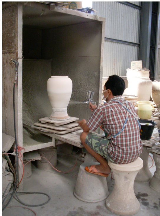
ภาพที่ 6-9 ลักษณะตู้พ่นสีที่ควรทำการปรับปรุง
