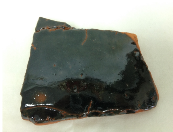
ภาพที่ 8-16 ผลการเผาเคลือบบนชิ้นงานผลิตภัณฑ์ของ โรงงาน
