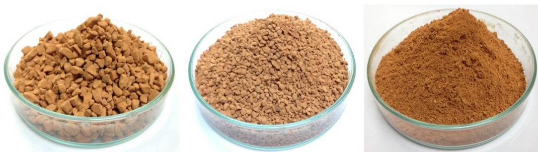
ภาพที่ 2-3 เศษของเสียหลังเผาบดขนาดหยาบ กลาง และละเอียด ซึ่งนำมาใช้ในสูตรผสม
