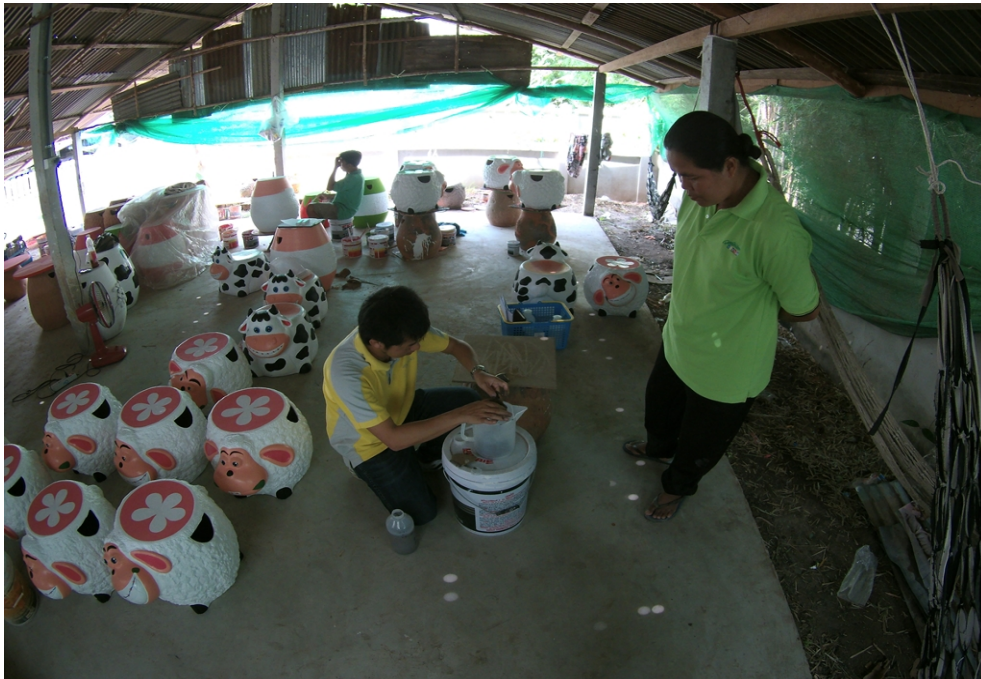
ภาพที่ 8-14 การหุบเคลือบบนชิ้นงานผลิตภัณฑ์ของ โรงงาน
