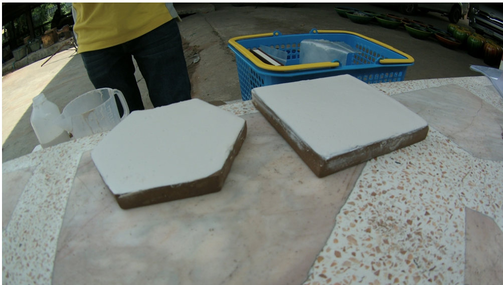
ภาพที่ 5-7 การชูปเคลือบบนชิ้นงานผลิตภัณฑ์ของโรงงาน
