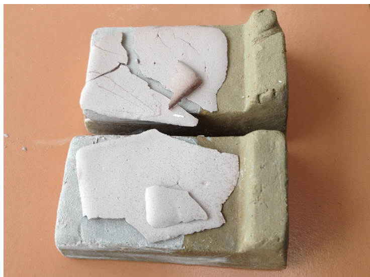
ภาพที่ 5-5 ลักษณะผิวเคลือบบนชิ้นงานทดสอบที่เกิดการหลุดร่อนก่อนการเผา ของสูตรเคลือบ 5-2
