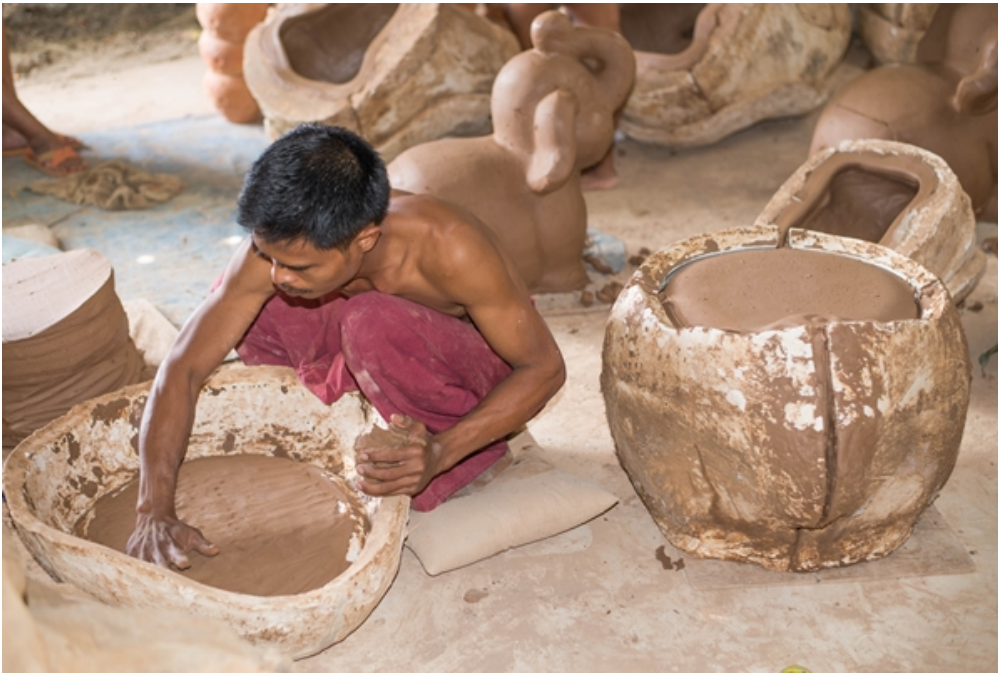
ภาพที่ 8-2 การกดแบบเพื่อขึ้นรูปผลิตภัณฑ์
