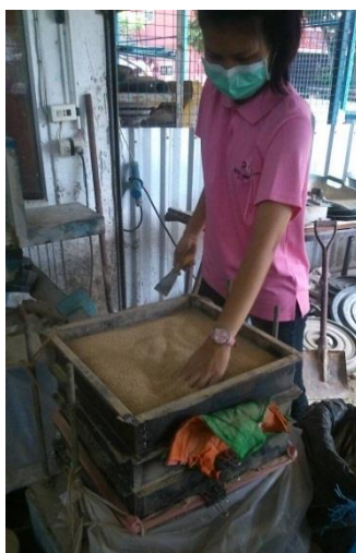
รูปที่ ก.2 ทำการแยกขนาดอนุภาคของชีวมวล โดยใช้เครื่องเขย่า และใช้ตะแกรงขนาด 40, 60 และ 80 Mesh
