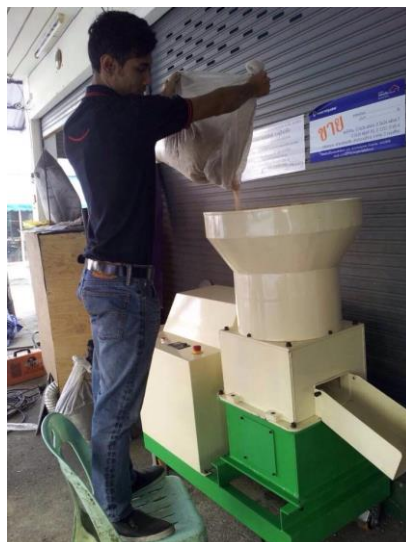
รูปที่ ก.4 แสดงการป้อนวัตถุดิบลงในถังป้อน
