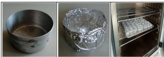
รูปที่ ข.22 นำฟอยล์มาพับเป็นถ้วย แล้วนำเข้าเตาอบ 30 นาที ที่อุณหภูมิ 103 องศาเซลเซียส
