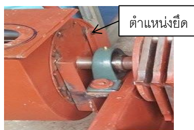
รูปที่ ข.14 การประกอบพัดลมดูดอากาศ
