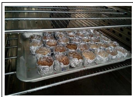
รูปที่ ข.26 นำไปอบทิ้งไว้เป็นเวลา 16 ชั่วโมง ที่อุณหภูมิ 103 องศาเซลเซียส
