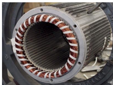
รูปที่ 2.6 แกนเหล็กสเตเตอร์และขดลวดสเตเตอร์ของมอเตอร์เหนี่ยวนำ 3 เฟส [19]
