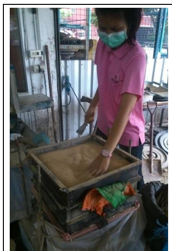
รูปที่ ข.32 ทำการแยกขนาดอนุภาคของชีวมวล โดยใช้เครื่องเขย่า และใช้ตะแกรงขนาด 40, 60 และ 80 Mesh
