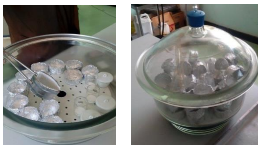
รูปที่ ข.23 นำถ้วยฟอยล์ใส่ในโถดูดความชื้นทิ้งไว้เป็นเวลา 30 นาที
