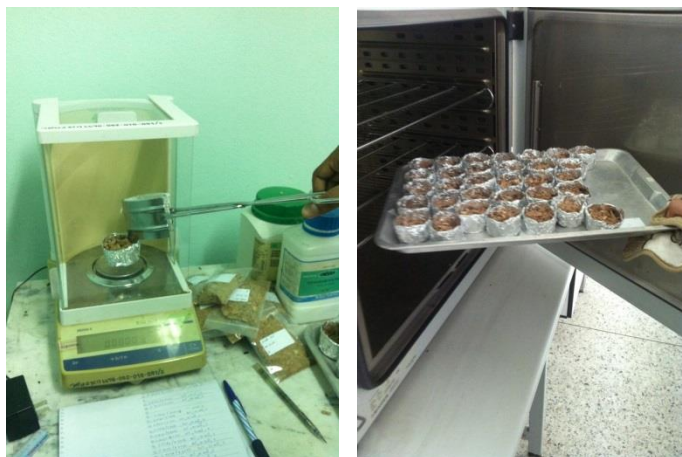
รูปที่ ข.19 นำขี้เลื่อยใส่ถ้วยฟอยด์และชั่งน้ำหนัก และนำเข้าเตาอบ ใช้เวลา 24 ชั่วโมง
