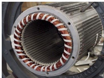
รูปที่ 2.8 แกนเหล็กสเตเตอร์และขดลวดสเตเตอร์ของมอเตอร์เหนี่ยวนำ 3 เฟส [18]
