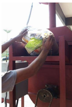
รูปที่ ข.14 นำชี้เลื่อยใส่เครื่องอบ
