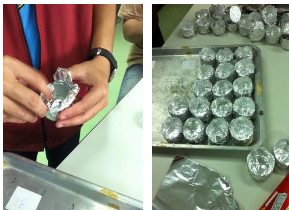
รูปที่ ข.16 นำแผ่นฟอยล์มาพับเป็นถ้วย
