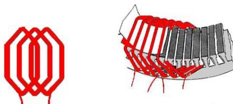
(ก). กลุ่มของขดลวดต่อเฟส (ข). กลุ่มของขดลวด 3 เฟสต่อหนึ่งขั้ว
