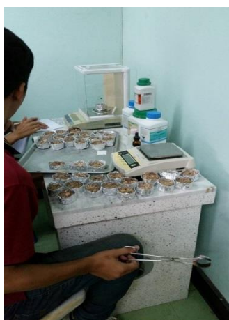
รูปที่ ข.21 นำออกจากโถสุญญากาศแล้วนำมาชั่งน้ำหนัก และจดค่าน้ำหนักที่ได้
