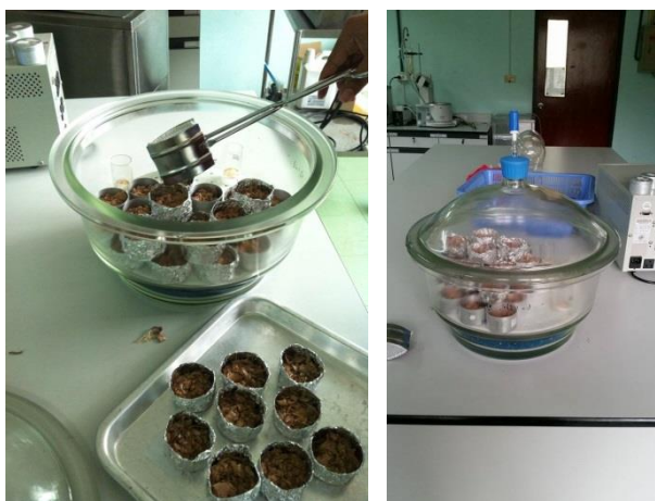
รูปที่ ข.20 เมื่อนำออกมาจากเตาอบ นำมาใส่ในโถสุญญากาศ ใช้เวลา 30 นาที
