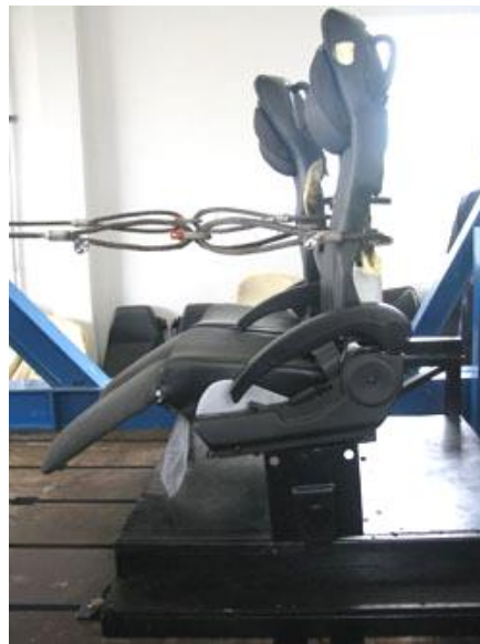
ภาพที่ 1.18 การทดสอบความแข็งแรงของความแข็งแรงของจุดต่อที่นั่งกับโครงสร้างรถ
