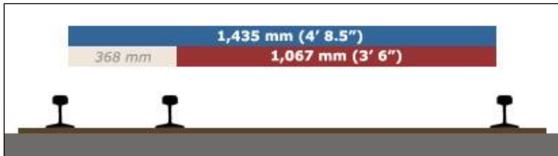
แผนภาพที่ 2.24 ตัวอย่างการพัฒนาโครงสร้างพื้นฐานของระบบรางที่สามารถใช้งานร่วมกันได้ ณ ด้านศุลกากรที่มีพรมแดนระหว่าง 2 ประเทศที่มีขนาดระยะรางรถไฟที่แตกต่างกัน แต่สามารถใช้รางรถไฟร่วมกันได้ ที่มา: Liftam, 2004
