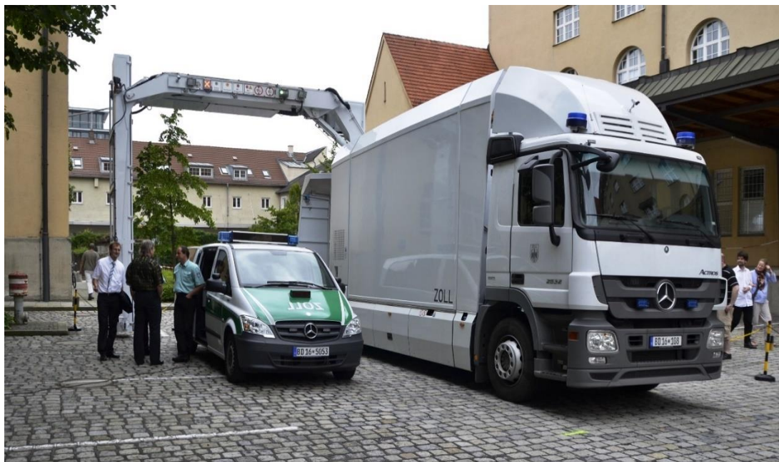
แผนภาพที่ 2.16 แสดงการตรวจสินค้า ณ เมืองมิวนิค, เยอรมัน โดยใช้ระบบ Mobile X-Ray ที่มา: Creative Commons Attribution 3.0 Germany licence
