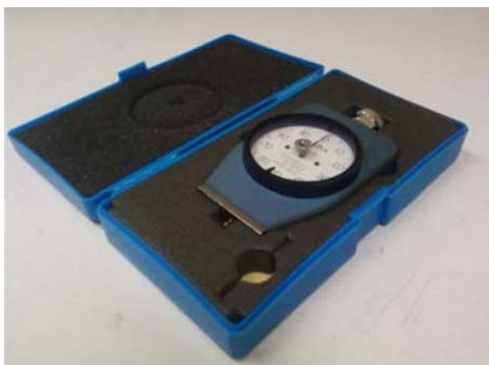
รูปที่ 3.9 เครื่องทดสอบความแข็ง (Durometer)
