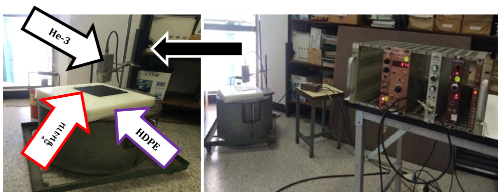
รูปที่ 3.5 เครื่องทดสอบความต้านทานต่ออนุภาคนิวตรอน
