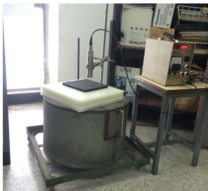
รูปที่ 3.6 เครื่องทดสอบความต้านทานต่อรังสีแกมมา
