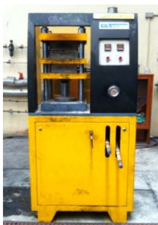
รูปที่ 3.4 เครื่องอัดขึ้นรูปร้อนระบบแรงดัน (Compression moulding machine)
