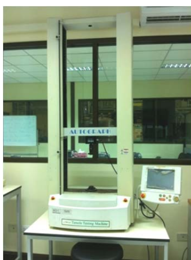
รูปที่ 3.8 เครื่อง Universal Testing Machine
