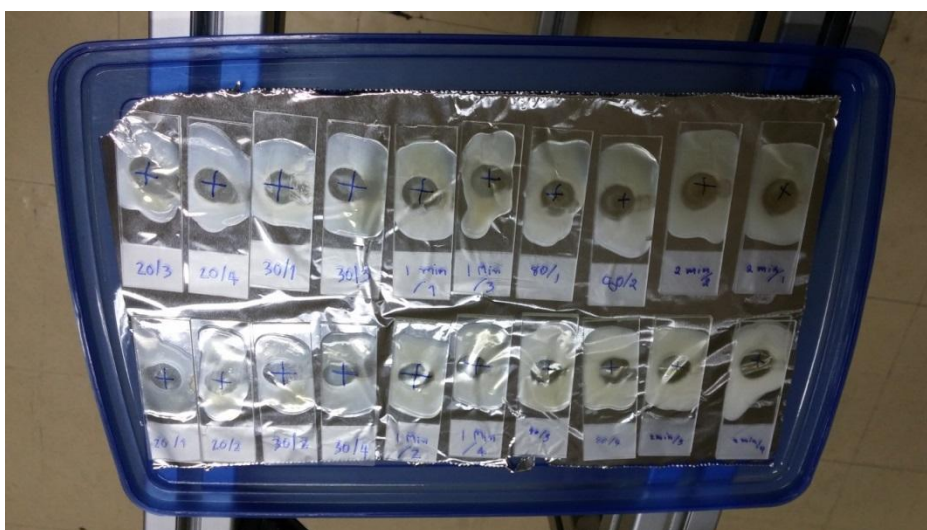
ภาพที่ 4.5 ตัวอย่างฟิล์มยางธรรมชาติปราศจากโปรตีนภูมิแพ้เพื่อเตรียมบำบัดด้วยพลาสมาที่เวลาต่างๆ
