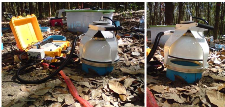
รูปที่ 2-16 เครื่องวัดอัตราการหายใจของดิน (Soil CO 2 Flux System) รุ่น LI-8100 ® (LI-COR, Inc., Ltd., U.S.A.)
