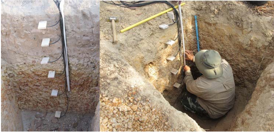
รูปที่ 4-5 การติดตั้งชุดอุปกรณ์วัดความชื้นและอุณหภูมิของดินที่ระดับความลึกต่างๆ จากผิวดิน
