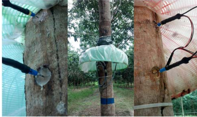
รูปที่ 4-3 การติดตั้งชุดอุปกรณ์ Sap flow บนต้นยางพารา
