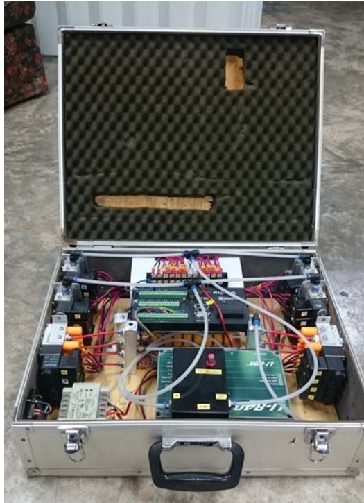
รูปที่ 2-20 ระบบควบคุมการสู่มอากาศและ ระบบวัดการหายใจของดิน ที่ติดตั้งในกล่องกันกระแทก ของชุดอุปกรณ์วัดอัตราการหายใจของดินแบบอัตโนมัติที่พัฒนาขึ้น สำหรับติดตั้ง ณ Site ที่ 2 แปลงปลูกยางของเกษตรกร จังหวัดบึงกาฬ
