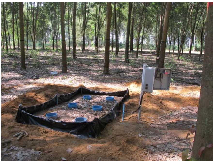
รูปที่ 2-15 Trench plot ที่เสร็จเรียบร้อยแล้ว พร้อมกับชุดอุปกรณ์บันทึกอุณหภูมิดินและปริมาณน้ำในดินแบบอัตโนมัติ
