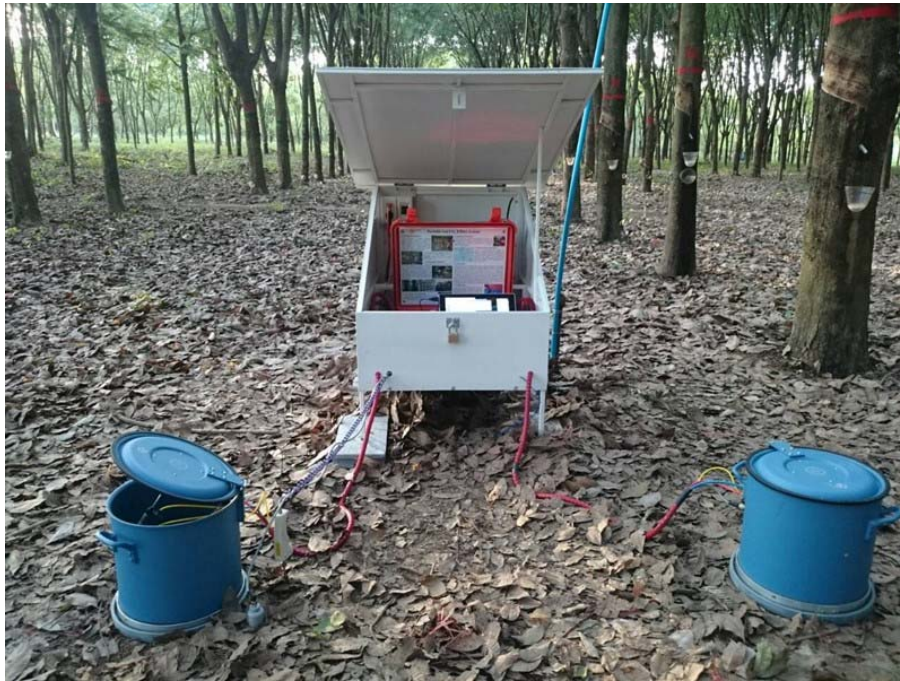
รูปที่ 2-19 การติดตั้งเครื่องวัดอัตราการหายใจของดินแบบอัตโนมัติขนาด 2 chamber ที่พัฒนาร่วมกับ National Institute for Environmental Studies ในสภาพแปลงจริงในประเทศไทย ณ Site ที่ 1 ศูนย์วิจัยยางฉะเชิงเทรา จังหวัดฉะเชิงเทรา
