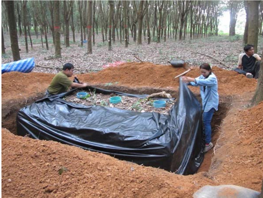
รูปที่ 2-13 การนำพลาสติกพันรอบพื้นผิวด้านข้างของ Trench plot เพื่อป้องกันไม่ให้รากเจริญเข้ามาใน Trench plot
