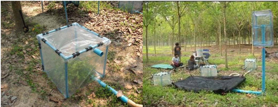
รูปที่ 2-23 การวัดอัตราการสังเคราะห์ด้วยแสงของเรือนฟุ่มของวัชพืชในสวนยางพารา
