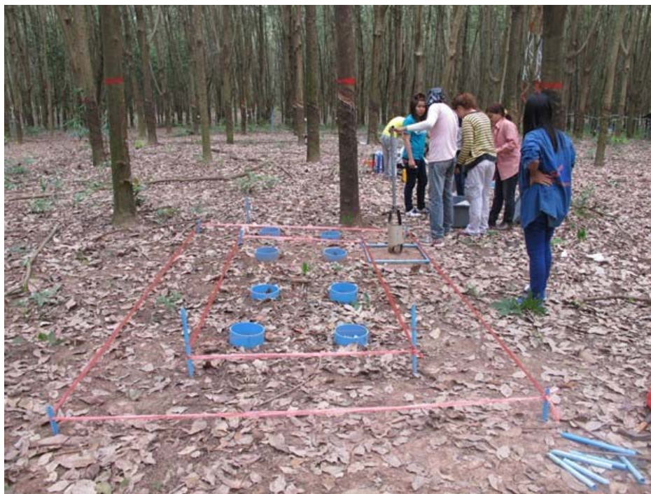
รูปที่ 2-10 การกำหนดพื้นที่ในการขุดดินเพื่อทำ Trench plot และเก็บตัวอย่างราก และดิน
