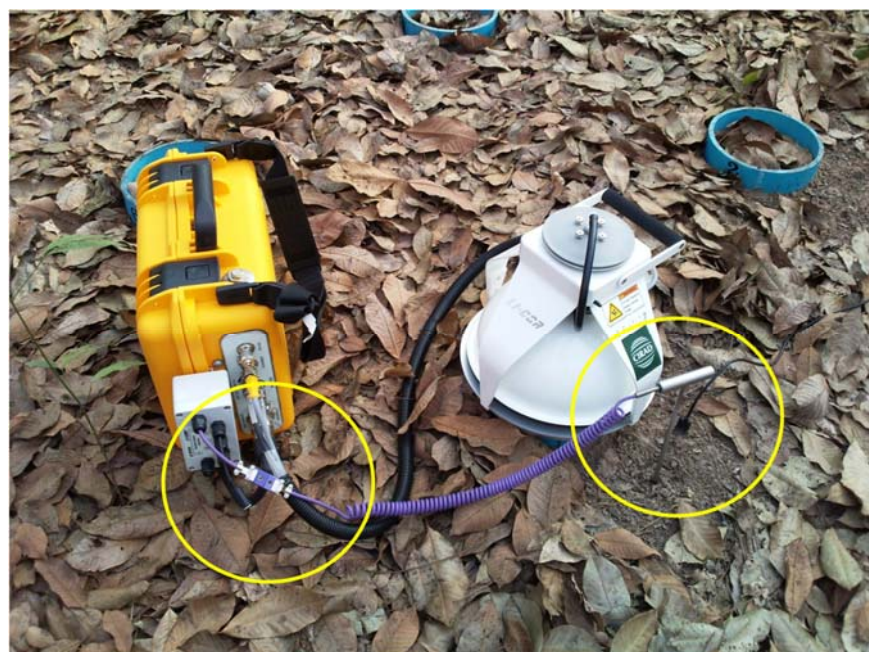
รูปที่ 2-17 อุปกรณ์วัดอุณหภูมิดิน (T handle thermocouple) ซึ่งสามารถเชื่อมต่อกับเครื่องวัดอัตราการหายใจของดินได้
