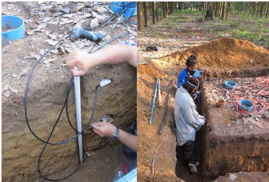
รูปที่ 2-12 การติดตั้ง sensor วัดอุณหภูมิดินและปริมาณน้ำในดิน (ภาพซ้าย) และ การหาซากที่อยู่ที่ภายใน Trench plot (ภาพขวา)
