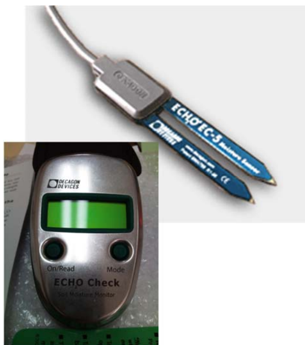
รูปที่ 2-18 อุปกรณ์วัดปริมาณน้ำในดิน (Soil moisture sensor) รุ่น EC-5 (Decagon Devices, Inc.m U.S.A.) ซึ่งอ่านค่าที่วัดได้โดยใช้ ProCheck (Decagon Devices, Inc. U.S.A.)
