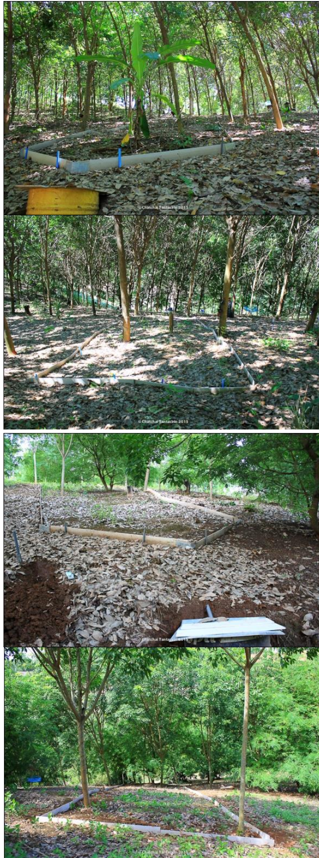
ภาพที่ 3 - 18 ลักษณะแปลงทดลองน้ำไหลบ่าหน้าดินและการสูญเสียดิน
