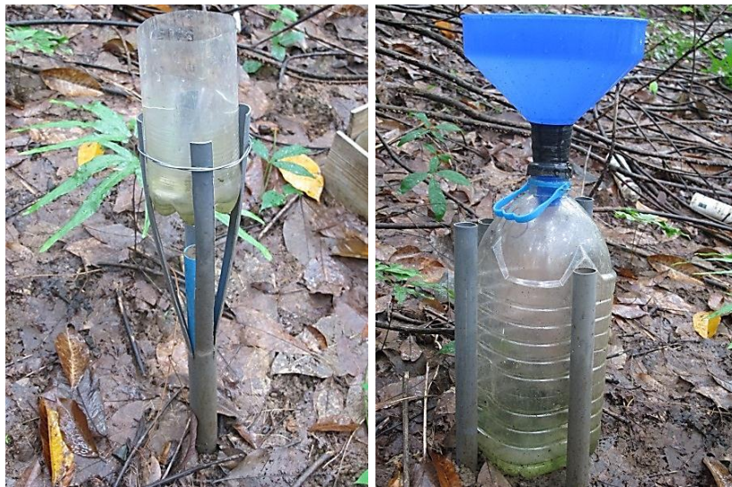
ภาพที่ 3-8 เครื่องวัดน้ำฝนทั้งหมดและเครื่องวัดน้ำฝนผ่านเรือนยอด ขนาดเส้นผ่าศูนย์กลาง 3 นิ้ว (ซ้าย) และ 8 นิ้ว (ขวา)
