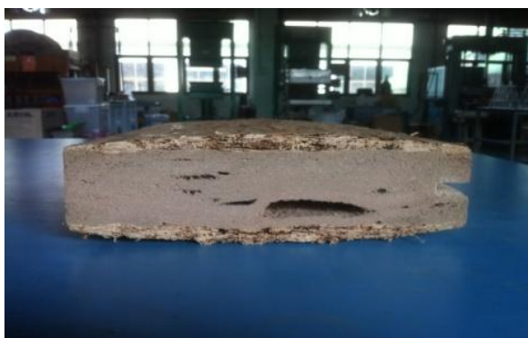
รูปที่5.14 แสดงลักษณะแผ่นผนังที่ได้จากการขึ้นรูปโดยการขยายแบบพิมพ์ 4 ช่วง: (ซ้าย) แผ่นผนังที่อัดขึ้นรูปด้วยช่วงระยะเวลา 5:9:9:9 นาที่ ซึ่งเกิดโพรงอากาศในบริเวณชั้นยางโฟมแกนกลาง และ (ขวา) แผ่นผนังที่อัดขึ้นรูปด้วยช่วงระยะเวลา 8:8:8:8 นาที่
