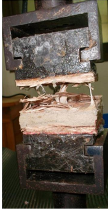
รูปที่ 5.9 แสดงการประลัยของชิ้นตัวอย่างที่เกิดจากการทดสอบ IB ซึ่งพบว่า เกิดขึ้นระหว่างแถบไม้ในชั้นผิว OSB
