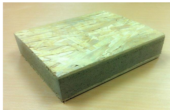
รูปที่5.14 แสดงลักษณะแผ่นผนังที่ได้จากการขึ้นรูปโดยการขยายแบบพิมพ์ 4 ช่วง: (ซ้าย) แผ่นผนังที่อัดขึ้นรูปด้วยช่วงระยะเวลา 5:9:9:9 นาที่ ซึ่งเกิดโพรงอากาศในบริเวณชั้นยางโฟมแกนกลาง และ (ขวา) แผ่นผนังที่อัดขึ้นรูปด้วยช่วงระยะเวลา 8:8:8:8 นาที่
