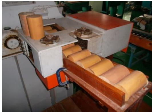
รูปที่ 4.1 แสดงลักษณะของท่อนไม้สดกลมที่กำลังป้อนเข้าสู่เครื่อง disc flaker
