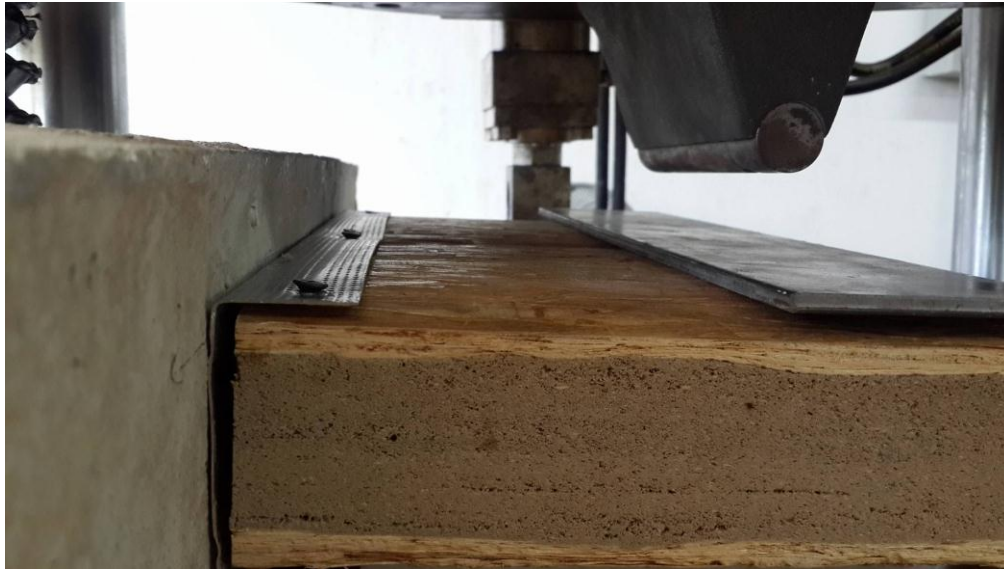
รูปที่ 5.20 แสดงการทดสอบค่าการรับแรงของรอยต่อ แผ่น-พื้น (Panel-To-Floor) ด้วยเครื่อง UTM
