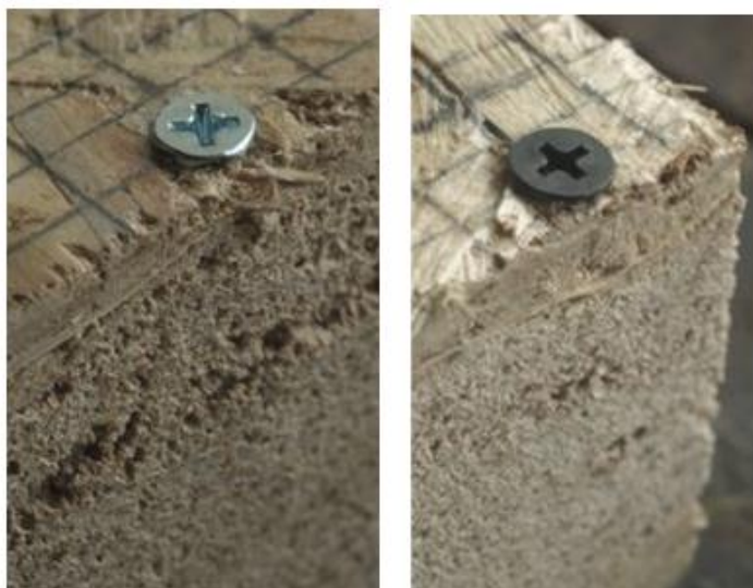
รูปที่ 5.7 แสดงลักษณะของแผ่นผนังที่มียางธรรมชาติผสมผงไม้เป็นแกนกลางเมื่อยึดเจาะแผ่นด้วย ตะปูเกลียวแบบมีปลายส่วน (ซ้าย) และตะปูเกลียวสีดำ (ขวา)
