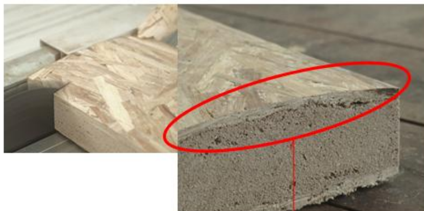
ไม่รอยแยกของชั้นผิวและแกนกลาง และสามารถตัดแต่งขึ้นใส่ได้
