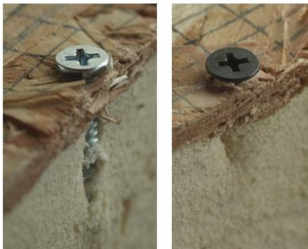
รูปที่ 5.4 แสดงลักษณะของแผ่นผนังที่มียางธรรมชาติเป็นแกนกลางเมื่อยึดเจาะแผ่นด้วยตะปูเกลียวแบบมีปลายสว่าน (ซ้าย) และตะปูเกลียวสีดำ (ขวา)
