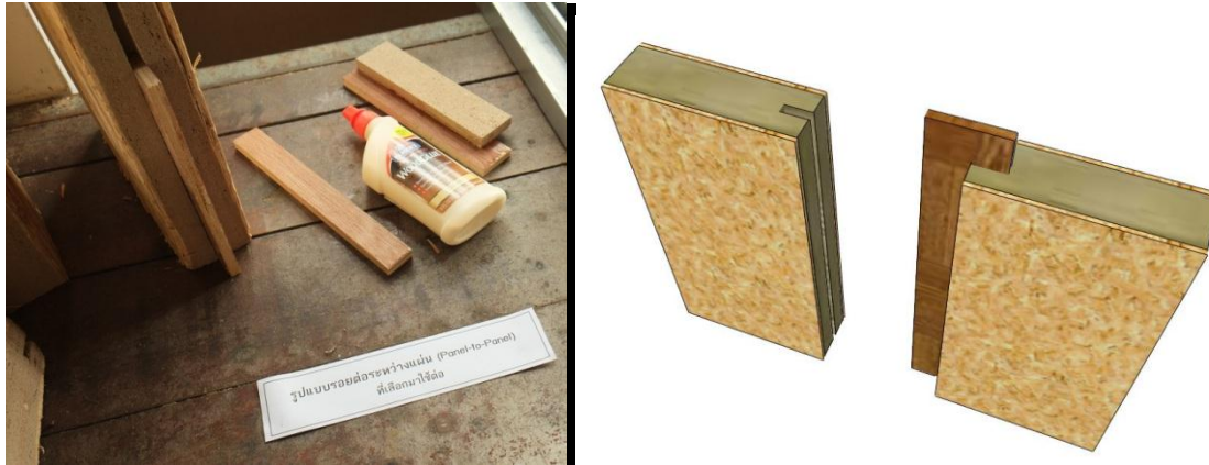
รูปที่ 5.16 รูปแบบของรอยต่อระหว่างแผ่น-แผ่น (Panel-To-Panel) แบบ B
