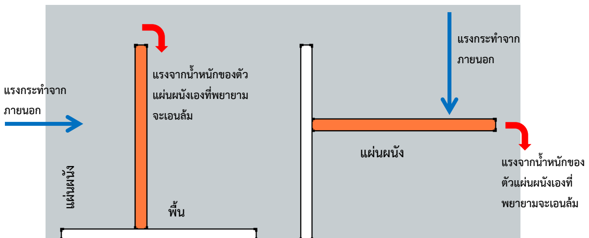
รูปที่ 5.17 แสดงการรับแรงของแผ่นผนังเปรียบเสมือนพฤติกรรมของคานยื่น
