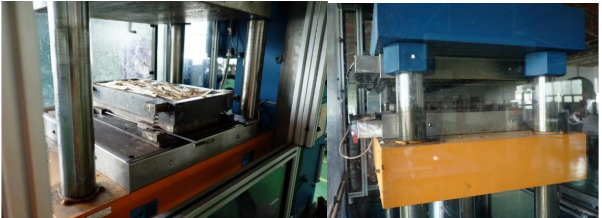
รูปที่ 4.6 การขึ้นรูปแผ่นผนังประหยัดพลังงานที่มียางธรรมชาติเป็นแกนกลาง
