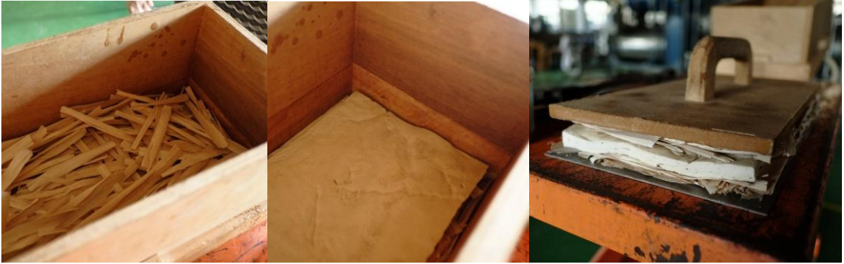
รูปที่ 4.5 การขึ้นรูปแผ่นผนังประหยัดพลังงานที่มียางธรรมชาติเป็นแกนกลาง
