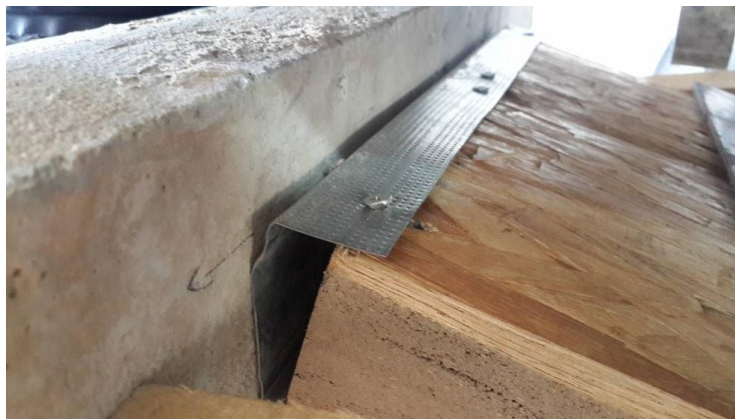
รูปที่ 5.22 ลักษณะการพังของรอยต่อแผ่น-พื้น (Panel-To-Floor) จากการทดสอบค่าการรับแรงด้วยเครื่อง UTM โดยจะสังเกตแนวฉีกระหว่างตะปูเกลียวและแนวการเรียงตัวของแถบขึ้นไม้
