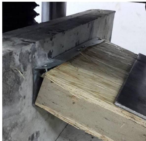
รูปที่ 5.21 แสดงลักษณะการพังของรอยต่อแผ่น-พื้น (Panel-To-Floor) จากการทดสอบค่าการรับแรงด้วย เครื่อง UTM
