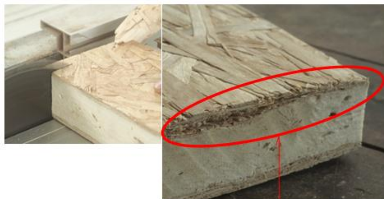
รอยแยกของชั้นผิวและ แกนกลาง และไม่สามารถตัดแต่งชิ้นได้
