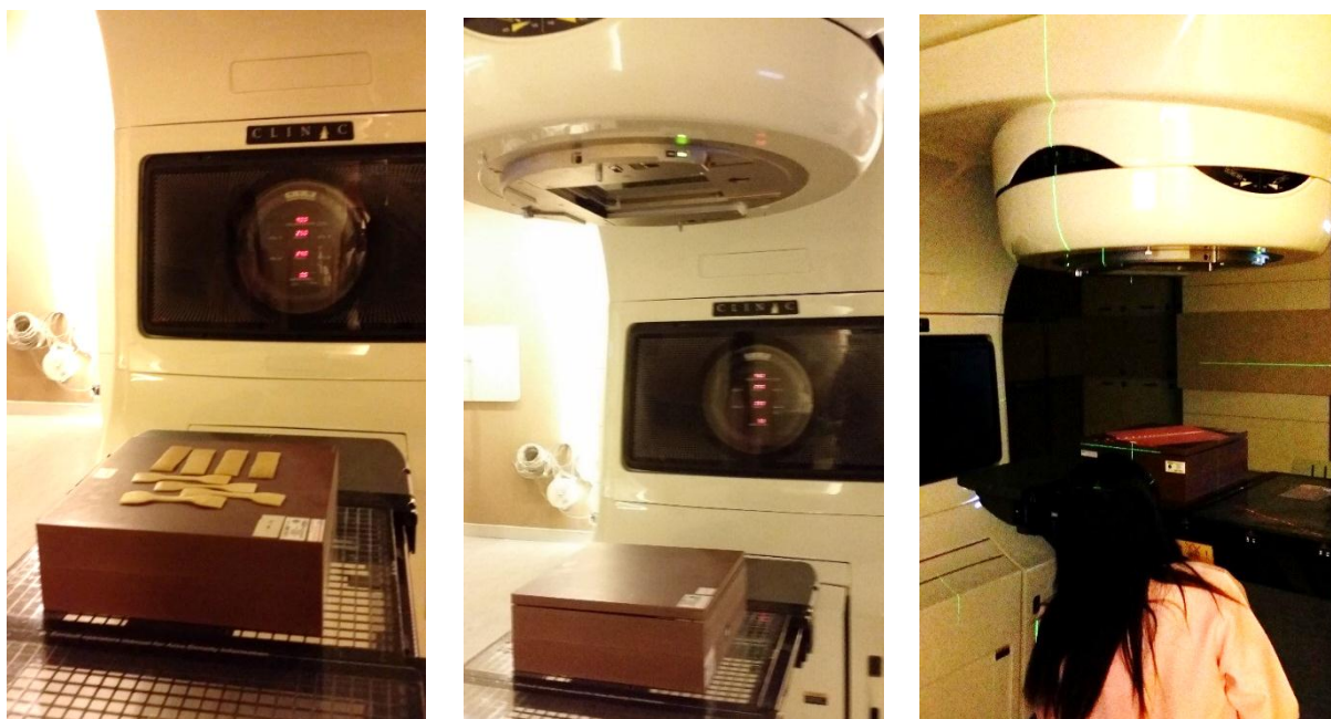
ภาพที่ 57 การฉายรังสีด้วยเครื่องเร่งอนุภาค (LINAC) พลังงาน 6 MV ปริมาณรังสีตั้งแต่ 1,000-6,000 cGy อัตราปริมาณรังสี 300 cGy/minute
