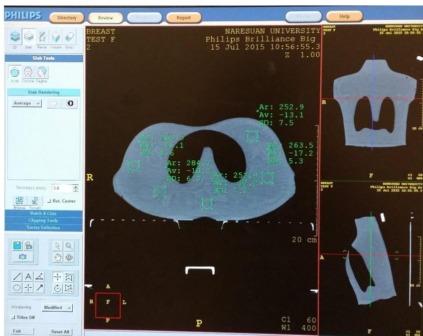
ภาพที่ 104 การประเมินค่าความสม่ำเสมอภาพตัดขวางเอกซเรย์คอมพิวเตอร์จำลองการรักษาหุ่นจำลองทรวงอกที่เนื้อเยื่อระดับเต้านม
