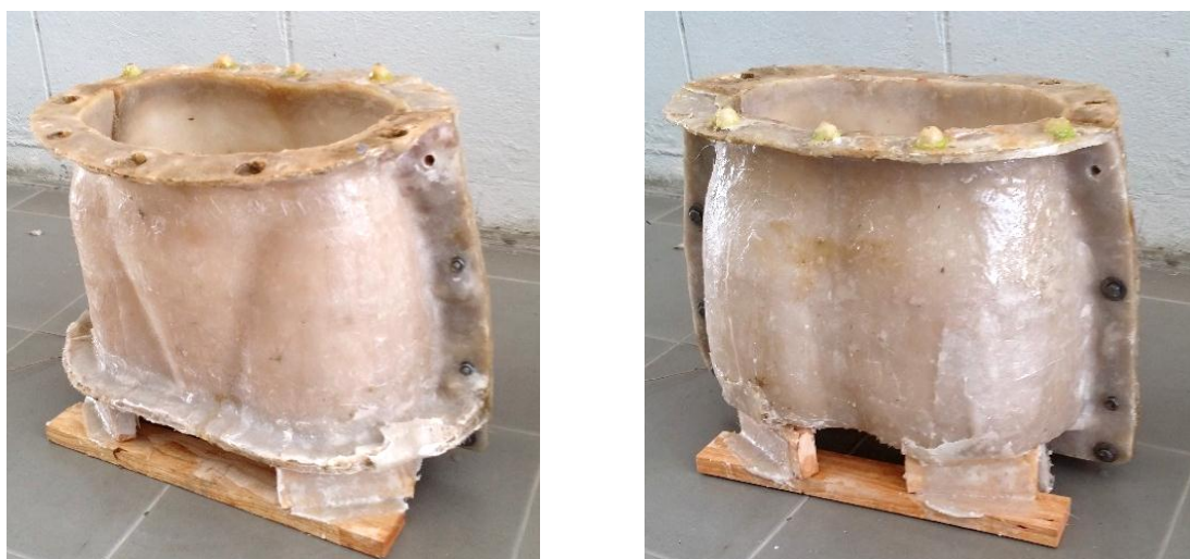
ภาพที่ 99 แม่พิมพ์หุ่นจำลองอุ้งเชิงกรานที่ผลิตจากเรซินและไฟเบอร์
