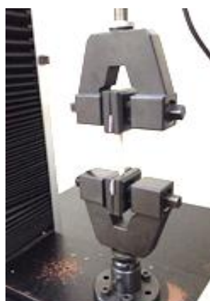
ภาพที่ 24 Trouser Test Specimen สำหรับการทดสอบด้วยเครื่องมือ Tensile Testing
