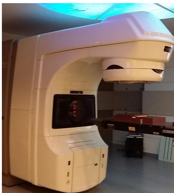
ภาพที่ 25 การฉายรังสีตัวอย่างชิ้นงานยางพาราด้วยเครื่องเร่งอนุภาค (LINAC) พลังงาน 6 MV ด้วยปริมาณรังสีในช่วง 200-6,000 cGy
