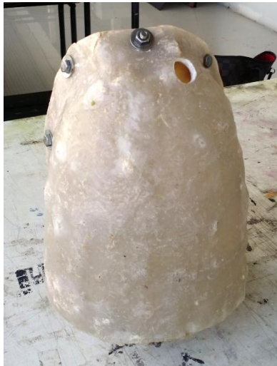
ภาพที่ 96 การยึดแม่พิมพ์ปอดจำลองทั้งสองซีกให้แนบสนิทด้วยน๊อต
