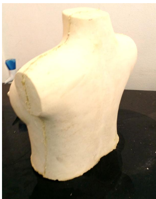
ภาพที่ 93 หุ่นจำลองทรงออกยาวพาราก่อนการตกแต่งและทำสีที่ได้จากการขึ้นรูปด้วยแม่พิมพ์เรซิน
