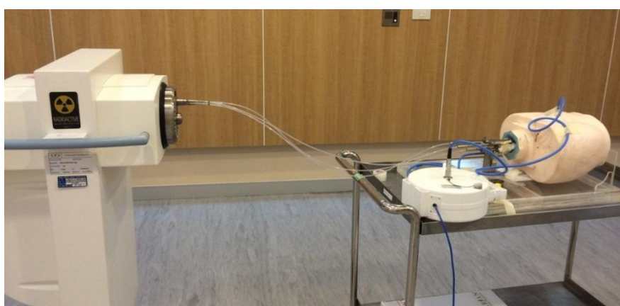
ภาพที่ 38 การจัดอุปกรณ์เพื่อการวัดค่าปริมาณรังสีจากการใส่แร่ในหุ่นจำลอง
