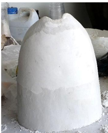
ภาพที่ 94 การสร้างแม่แบบหุ่นปอดจำลองจากปูนปลาสเตอร์
