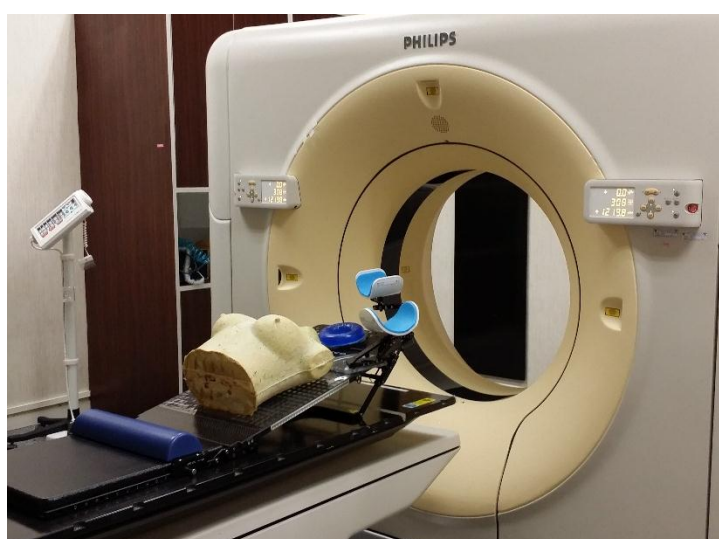
ภาพที่ 103 การประเมินค่าความสม่ำเสมอของหุ่นจำลองทรวงอกจากภาพตัดขวางเอกซเรย์คอมพิวเตอร์จำลองการรักษา
