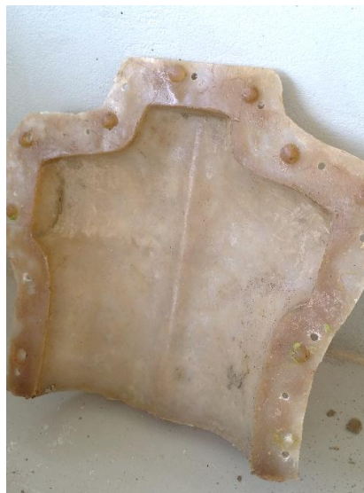
ภาพที่ 91 แม่พิมพ์หุ่นจำลองทรงอกจากเรซินผสมไฟเบอร์ด้านหลัง
