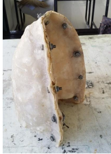
ภาพที่ 96 การยึดแม่พิมพ์ปอดจำลองทั้งสองซีกให้แนบสนิทด้วยน๊อต
