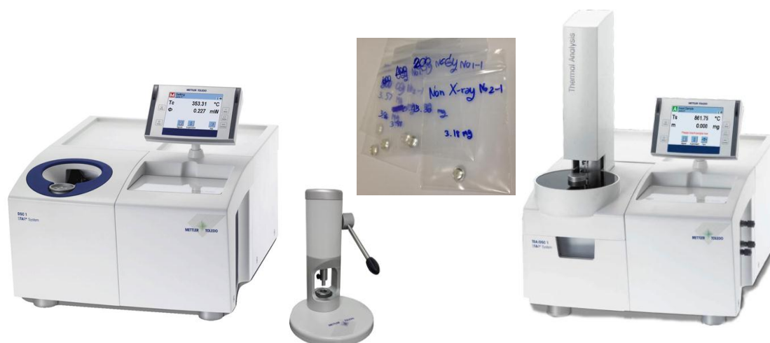
ภาพที่ 26 แสดง Sample crucibles, crucible sealing press, Differential Scanning Calorimetry (DSC) and Thermalgravimeitric Analysis (TGA)
