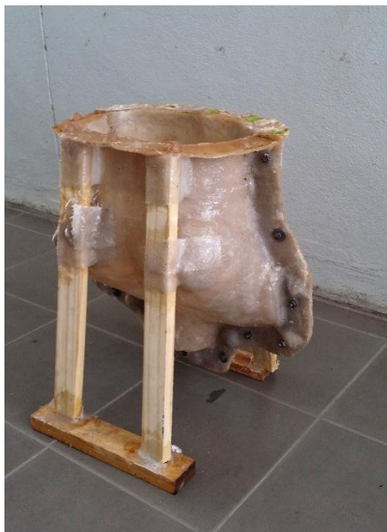
ภาพที่ 92 แม่พิมพ์หุ่นจำลองทรงอกจากเรซินผสมไฟเบอร์ที่สามารถประกบกันอย่างพอดี
