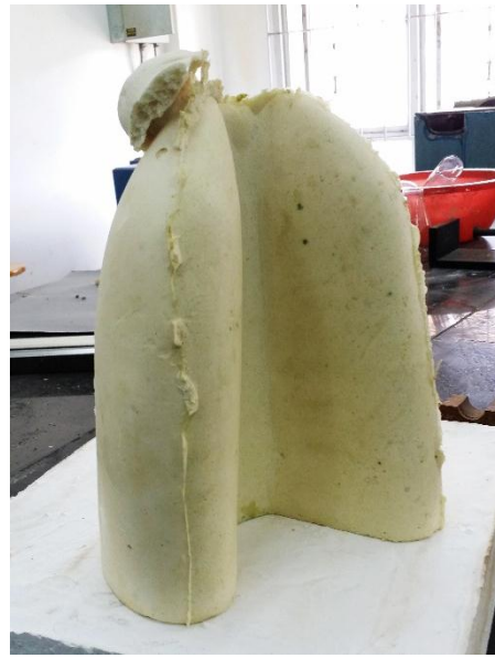
ภาพที่ 97 ปอดจำลองยางพาราที่ขึ้นรูปด้วยแม่พิมพ์เรซินผสมไฟเบอร์
