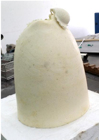
ภาพที่ 97 ปอดจำลองยางพาราที่ขึ้นรูปด้วยแม่พิมพ์เรซินผสมไฟเบอร์
