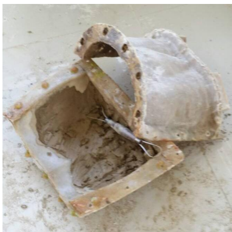
ภาพที่ 28 ขั้นตอนการแกะแม่พิมพ์ออกจากหุ่นต้นแบบ
