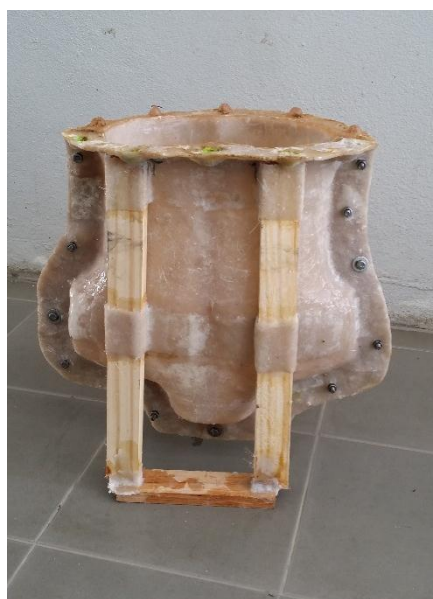
ภาพที่ 92 แม่พิมพ์หุ่นจำลองทรงอกจากเรซินผสมไฟเบอร์ที่สามารถประกบกันอย่างพอดี
