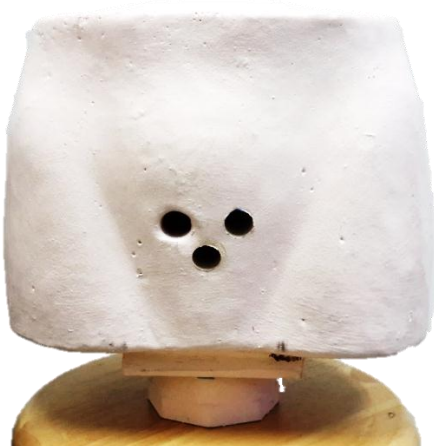
ภาพที่ 100 หุ่นจำลองอุ้งเชิงกรานจากยางพารา ในทำด้านหน้า โดยจะมีรู 3 รู สำหรับใส่หัววัดรังสีเพื่อวัดปริมาณรังสีที่ตำแหน่งจุด Point A และ Bladder point
