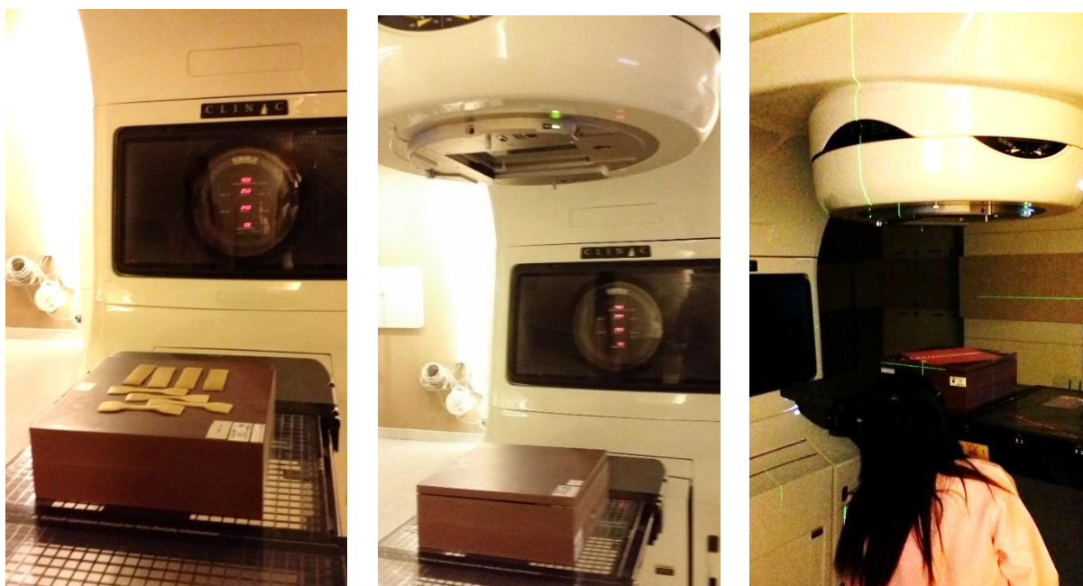
ภาพที่ 51 การฉายรังสีด้วยเครื่องเร่งอนุภาค (LINAC) พลังงาน 6 MV อัตราปริมาณรังสี 300 cGy/minute ปริมาณรังสีตั้งแต่ 1,000-6,000 cGy
