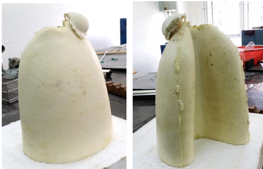
ภาพที่ 66 ปอดจำลองยางพาราที่ขึ้นรูปด้วยแม่พิมพ์เรซินผสมไฟเบอร์
