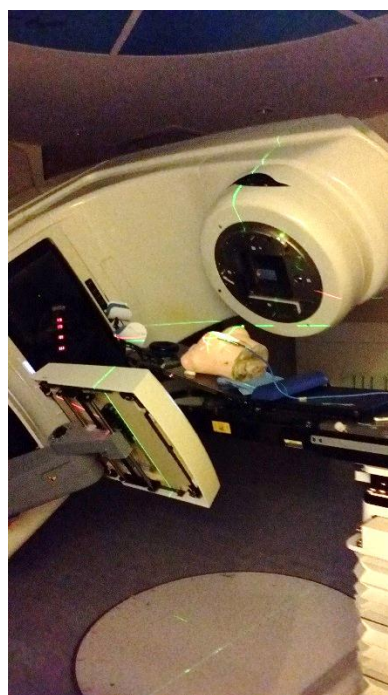
ภาพที่ 79 การฉายรังสีหุ่นจำลองทรวงอกในทิศทาง lateral และ medial tangential ด้วยเครื่องอนุภาค
