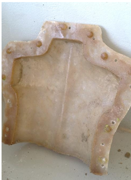
ภาพที่ 60 ผลการสร้างแม่พิมพ์หุ่นจำลองทรงอกจากเรซินผสมไฟเบอร์ด้านหลัง
