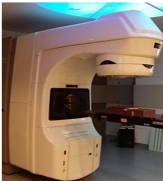
ภาพที่ 17 การฉายรังสีตัวอย่างชิ้นงานด้วยเครื่องเร่งอนุภาค (LINAC) พลังงาน 6 MV ด้วยปริมาณรังสีในช่วง 200-6,000 cGy
