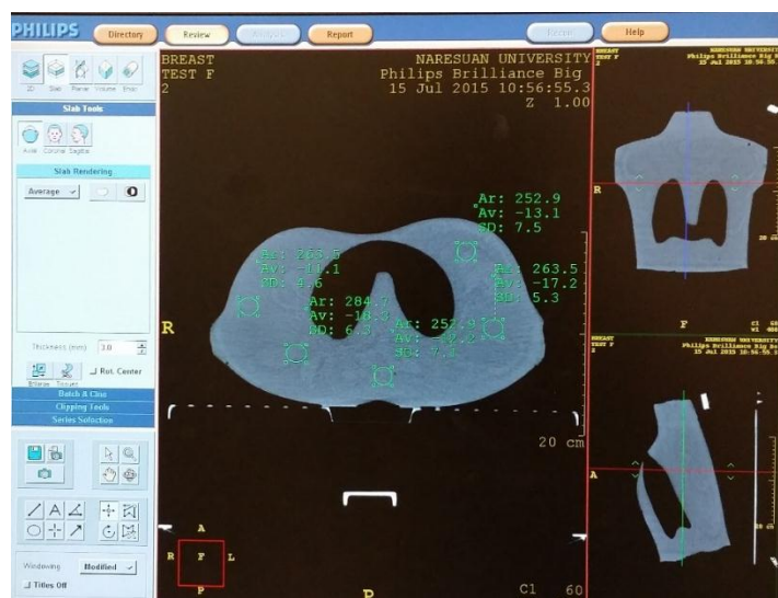
ภาพที่ 68 การประเมินค่าความสม่ำเสมอภาพตัดขวางเอกซเรย์คอมพิวเตอร์จำลองการรักษาหุ่นจำลองทรวงอกที่เนื้อเยื่อระดับเต้านม
