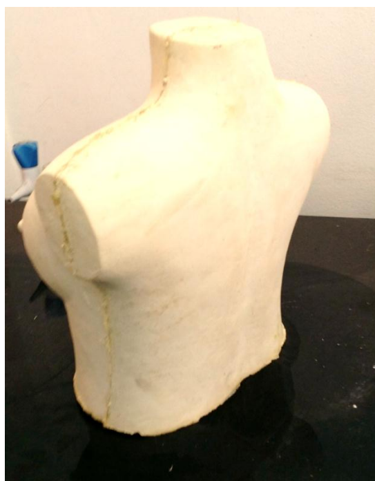
ภาพที่ 62 หุ่นจำลองทรงออกยาราก่อนการตกแต่งและทำสีที่ได้จากการขึ้นรูปด้วยแม่พิมพ์เรซิน
