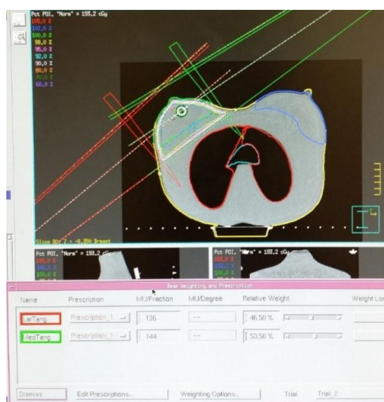
ภาพที่ 75 การปรับเปลี่ยนค่าน้ำหนักปริมาณรังสีในแต่ละลำรังสี (beam weighting) ของเทคนิคการแผนการรักษาแบบ 3 มิติ
