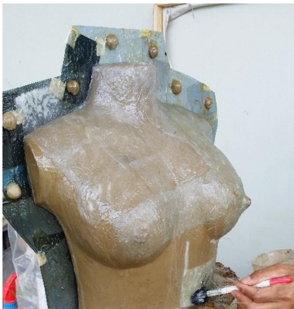
ภาพที่ 59 ผลการสร้างแม่แบบหุ่นจำลองทรงอกที่ทำจากวัสดุเรซินผสมไฟเบอร์
