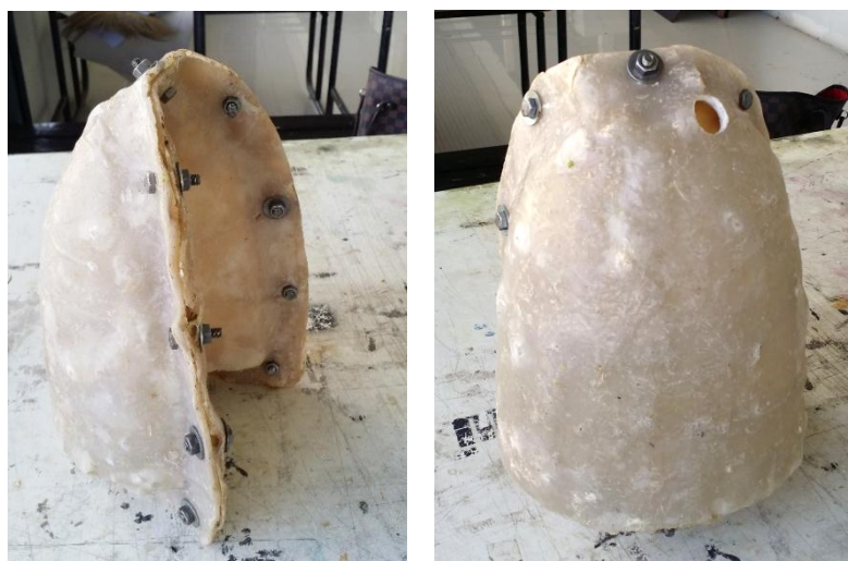
ภาพที่ 65 การยึดแม่พิมพ์ปอดจำลองทั้งสองซีกให้แนบสนิทด้วยน็อต
