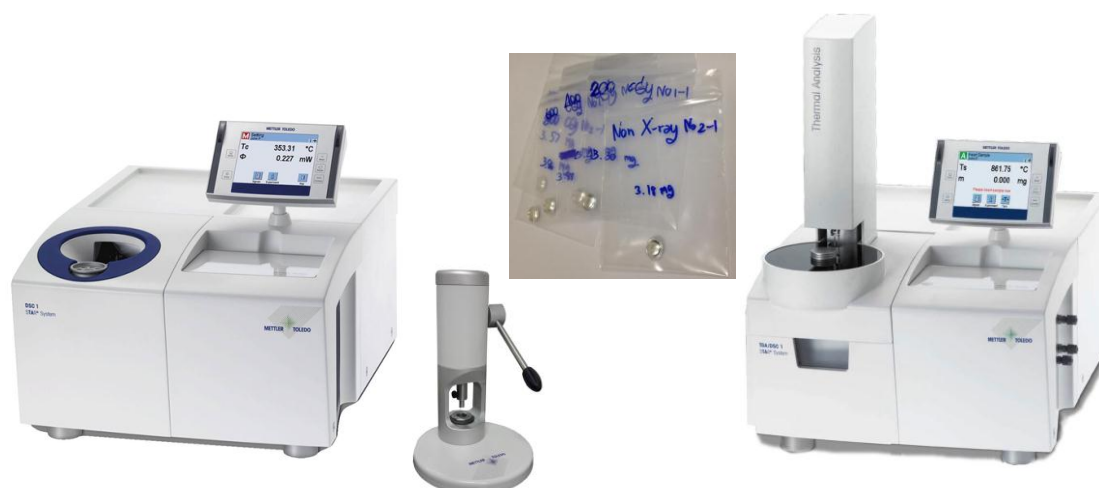
ภาพที่ 16 Sample crucibles, crucible sealing press, Differential Scanning Calorimetry (DSC) and Thermalgravimeitric Analysis (TGA)
