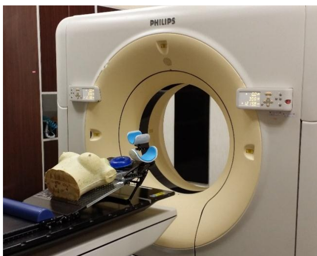
ภาพที่ 67 การประเมินค่าความสม่ำเสมอของหุ่นจำลองทรวงอกจากภาพตัดขวางเอกซเรย์คอมพิวเตอร์จำลองการรักษา
