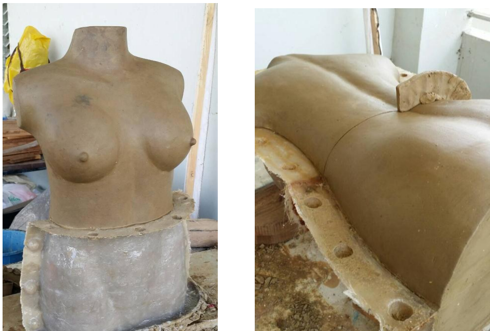
ภาพที่ 25 ขั้นตอนการสร้างแม่พิมพ์จากเรซินและไฟเบอร์
