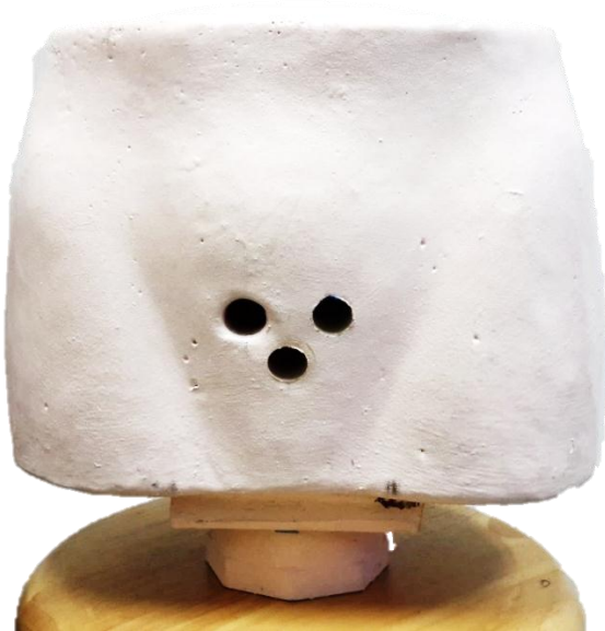
ภาพที่ 87 หุ่นจำลองอั่งเชิงกรานจากยางพาราในท่าด้านหน้า โดยมีช่องสำหรับใส่หัววัดรังสีเพื่อวัดปริมาณรังสีที่ตำแหน่งจุด Point A และ Bladder point
