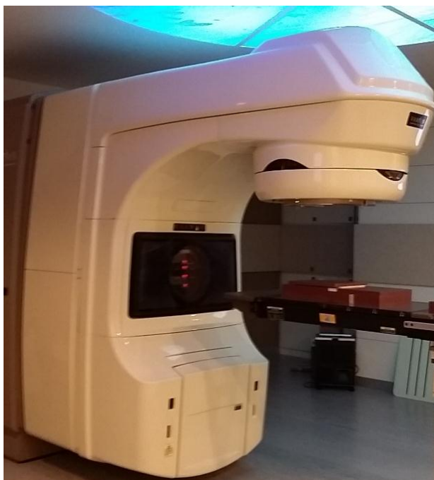
ภาพที่ 24 การฉายรังสีตัวอย่างชิ้นงานด้วยเครื่องเร่งอนุภาค (LINAC) พลังงาน 6 MV ด้วยปริมาณรังสีในช่วง 200 - 6,000 cGy
