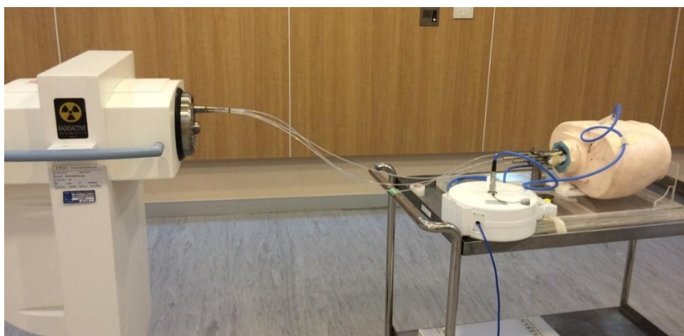
ภาพที่ 36 การจัดอุปกรณ์เพื่อการวัดค่าปริมาณรังสีจากการใส่แร่ในหุ่นจำลอง
