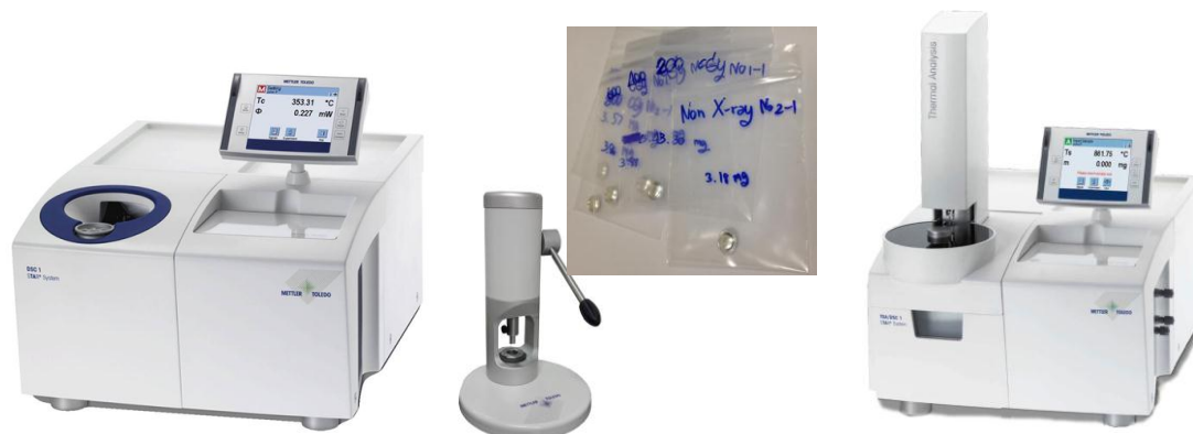
ภาพที่ 23 Sample crucibles, crucible sealing press, Differential Scanning Calorimetry (DSC) and Thermal gravimetric Analysis (TGA)
