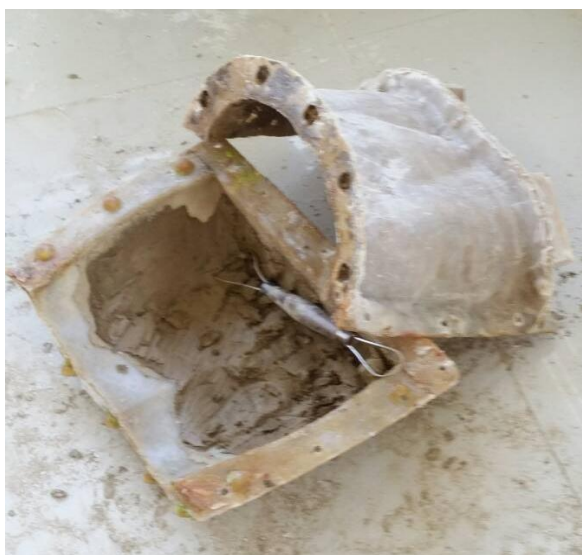
ภาพที่ 26 ขั้นตอนการแกะแม่พิมพ์ออกจากหุ่นต้นแบบ
