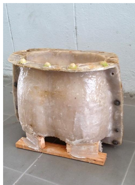
ภาพที่ 86 แม่พิมพ์หุ่นจำลองอู่เชิงกรานที่ผลิตจากเรซินและไฟเบอร์
