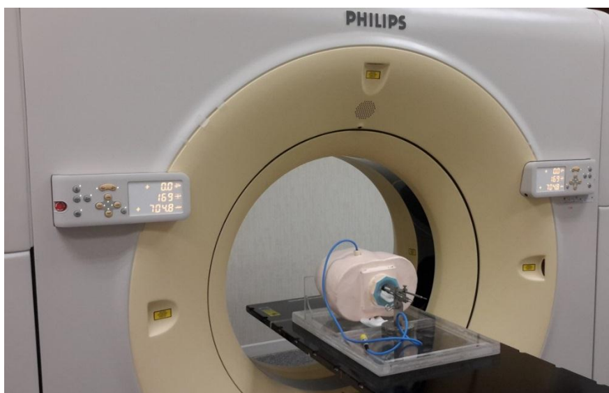
ภาพที่ 31 การจัดตำแหน่งหุ่นจำลองเพื่อสร้างภาพเอกซเรย์คอมพิวเตอร์
