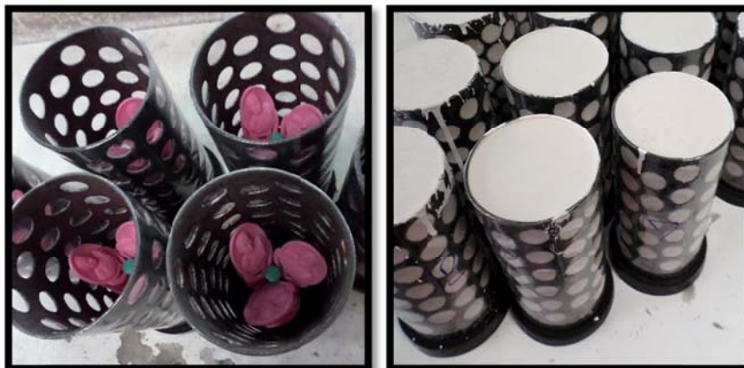
รูปที่ 2.2-4 ต้นเทียนในท่อเหล็กทรงกระบอกก่อนเทปูนพลาสติก (ซ้าย) และหลังเทปูนพลาสติก (ขวา)
