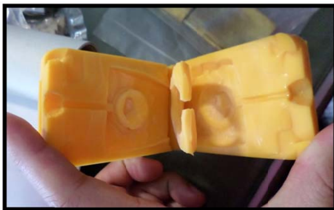
รูปที่ 2.2-2 ตัวอย่างแม่พิมพ์ยางที่ผ่าและแกะต้นแบบชิ้นงานออกแล้ว
