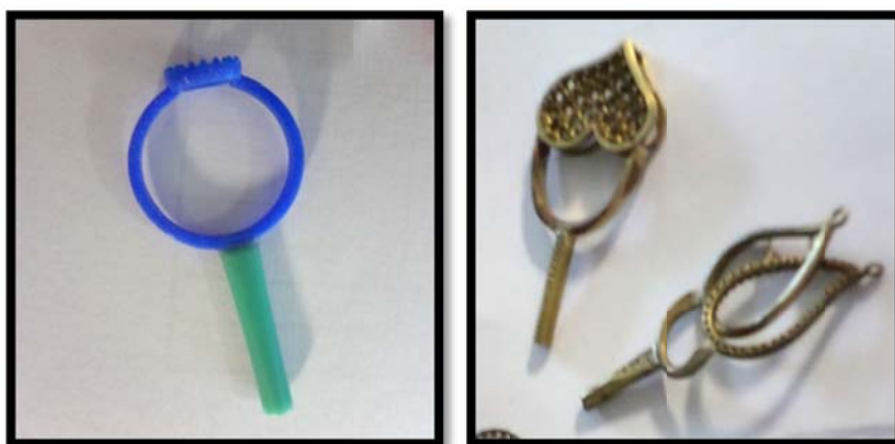
รูปที่ 2.2-1 ตัวอย่างต้นแบบชิ้นงานจากเครื่องพิมพ์สามมิติ (ซ้าย) และตัวอย่างต้นแบบชิ้นงานทองเหลือง (ขวา)
