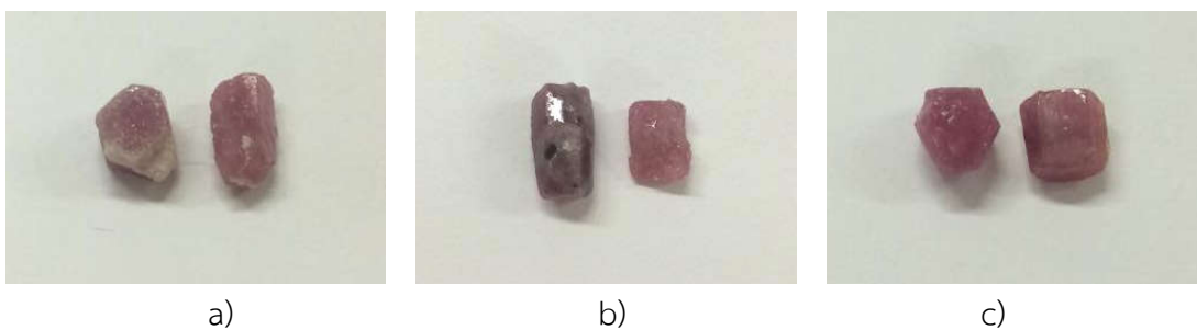
รูปที่ 4.13 ผลอยทับทิมที่นำมาเผาซ้ำที่อุณหภูมิ 1,400 องศาเซลเซียส a) 12 ชั่วโมง b) 18 ชั่วโมง c) 24 ชั่วโมง
