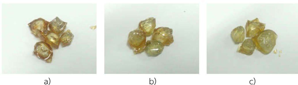
รูปที่ 4.54 พอลอยีซีเอวที่อุณหภูมิ 1,300 องศาเซลเซียส ภายใต้สภาวะรีดักชัน a) 1 กรัม b) 3 กรัม c) 5 กรัม
