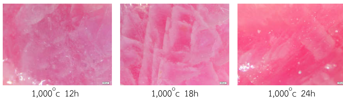
รูปที่ 4.15 ลักษณะทั่วไปโดยการส่องของพลอยทับทิมที่อุณหภูมิ 1,000 องศาเซลเซียส
