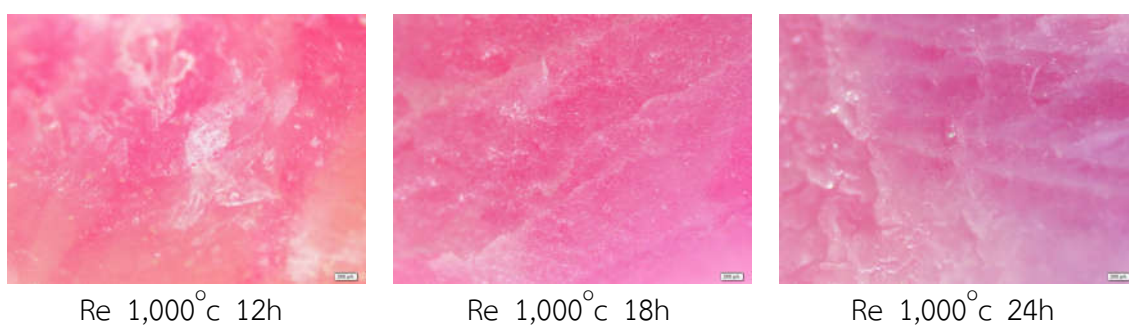
รูปที่ 4.20 ลักษณะทั่วไปโดยการส่องของพลอยทับทิมที่นำมาเผาซ้ำที่อุณหภูมิ 1,000 องศาเซลเซียส
