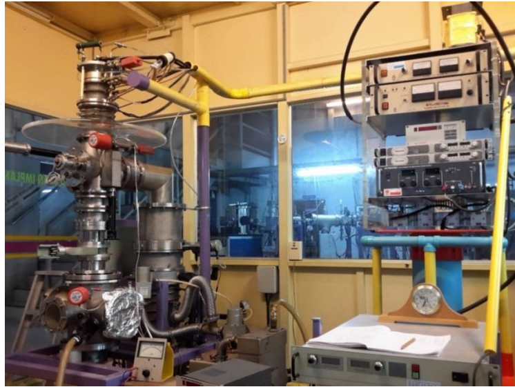
รูปที่ 4-1 เครื่องไอออนอิมพลานเตอร์ และชั้นวาง power supply หลังปรับปรุง
