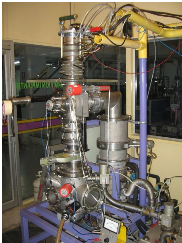
รูปที่ 3-2 เครื่องไอออนอิมพลานเตอร์ต้นแบบสำหรับงานพลอย โดยที่รูปด้านขวาแสดงการติดตั้งพลอย และการเรืองแสงของพลายเมื่อถูกยิงด้วยไอออน
