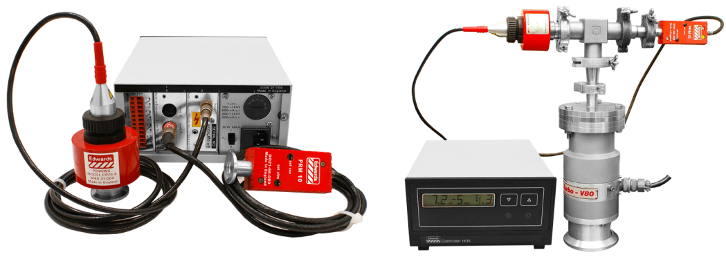
รูปที่ 4-36 การติดตั้งหัววัดและระบบควบคุมการวัดความดันบรรยากาศของบริษัท Edwards
