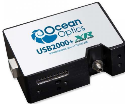
รูปที่ 3-13 Spectrometer USB2000+XR ที่ใช้ในการทดลอง
