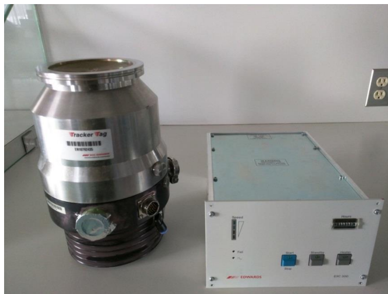
รูปที่ 4-34 ปั๊มสุญญากาศแบบ Turbo-molecular รุ่น EXT 351 ขนาด 350 ลิตร ต่อ วินาที และระบบควบคุม รุ่น EXC 300 ของบริษัท Edwards
