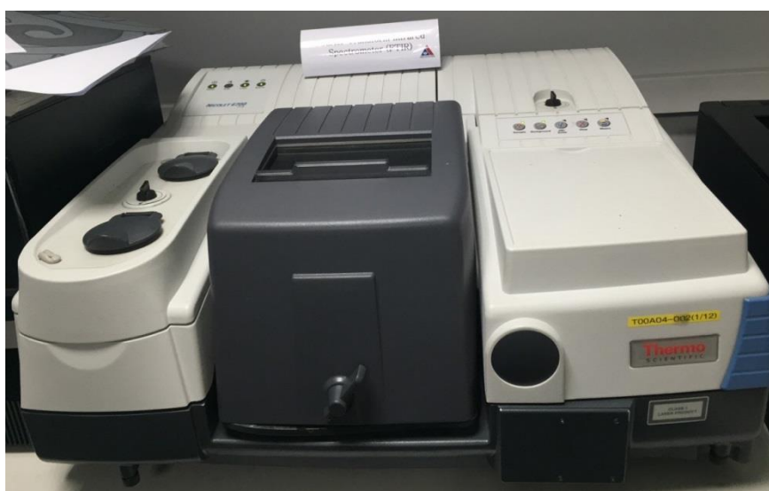
รูปที่ 3-21 เครื่อง FTIR ยี่ห้อ Nicolet รุ่น 6700 ของสถาบันวิจัยและพัฒนาอัญมณีและเครื่องประดับแห่งชาติ (องค์การมหาชน)
