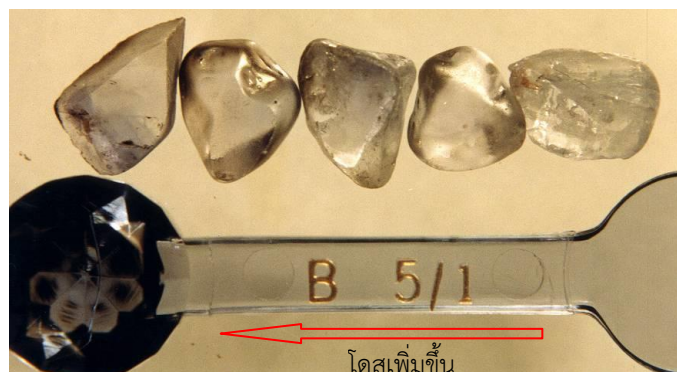
รูปที่ 2.22 แชนป์ไฟร์สีน้ำเงินอ่อนหลังไอออนอิมพลานเตชันที่โดสค่าต่าง ๆ จะมีความโปร่งใสเพิ่มมากขึ้นตามค่าโดสที่เพิ่มขึ้น (จากขวาไปซ้าย) เมื่อเปรียบเทียบกับไม่ได้ไอออนอิมพลานเตชัน (เม็ดขวาสุด)
