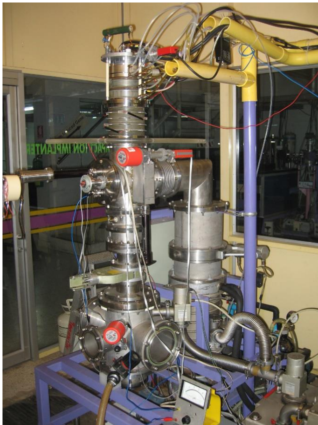
รูปที่ 2-20 ภาพถ่าย และ ไดอะแกรมอย่างง่ายของเครื่องเร่งลำไอออนขนาดกะทัดรัด สำหรับใช้ในงานพลอยคอร์นดัม ของมหาวิทยาลัยเชียงใหม่ [26]
