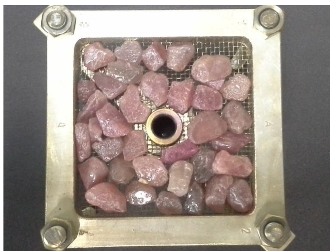
รูปที่ 2-21 ถาดวางพลอยสำหรับยิงไอออน ในเครื่องเร่งลำไอออนขนาดกะทัดรัด ศักย์ไฟฟ้าเร่งไม่เกิน 100 กิโลโวลต์ ของมหาวิทยาลัยเชียงใหม่ [26]
