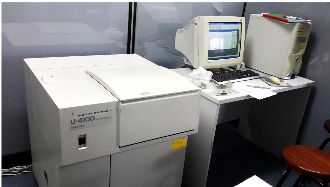
รูปที่ 3-14 UV-VIS-NIR spectrophotometer ยี่ห้อ Hitachi รุ่น U-4100 ของภาควิชาธรณีวิทยา คณะวิทยาศาสตร์ มหาวิทยาลัยเชียงใหม่
