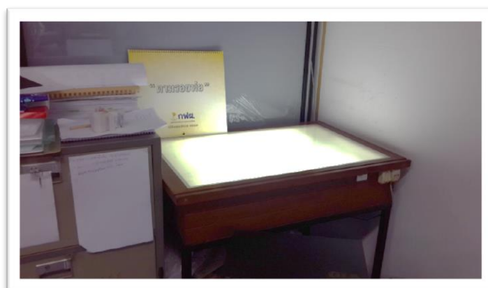
รูปที่ 3-4 โต๊ะแสงที่ใช้ในการทดสอบความโปร่งแสง
