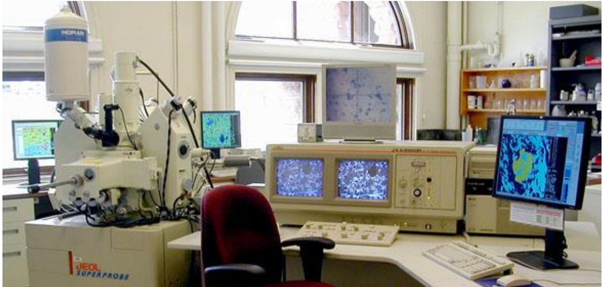
รูปที่ 3-10 EPMA ประกอบด้วย (จากซ้ายไปขวา) electron gun อุโมงค์พร้อมหัววัด control console และ monitors [29]
