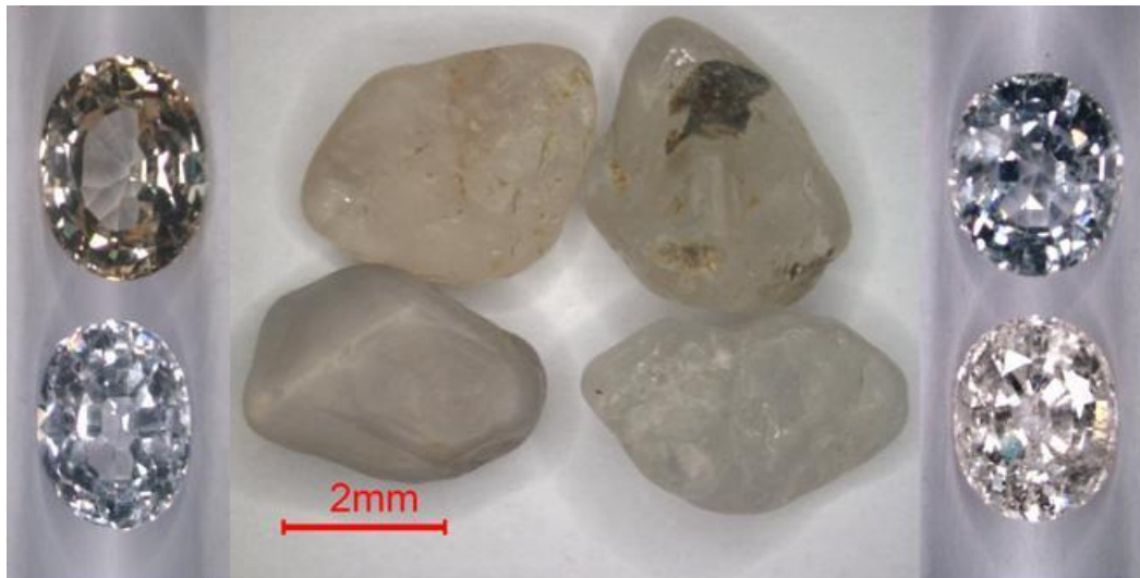
รูปที่ 2.9 พลอยจากศรีลังกา ก่อนการทดลองมีสีขาวขุ่น มลทินสีดำกระจายภายในเนื้อพลอย หลังไอออน อิมพลานเตชัน จะมีลักษณะ ใส แวววาว ทำให้เพิ่มมูลค่าขึ้นได้อีก นอกจากนั้น หลังการเจียรระไนสามารถใช้เป็นเครื่องประดับทางเลือกทดแทนเพชรที่มีราคาสูงกว่ามากได้
