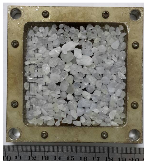
รูปที่ 2.4 เครื่องไอออนอิมพลานเตอร์ต้นแบบสำหรับงานพลอย โดยที่รูปด้านขวาแสดงการติดตั้งพลอย
