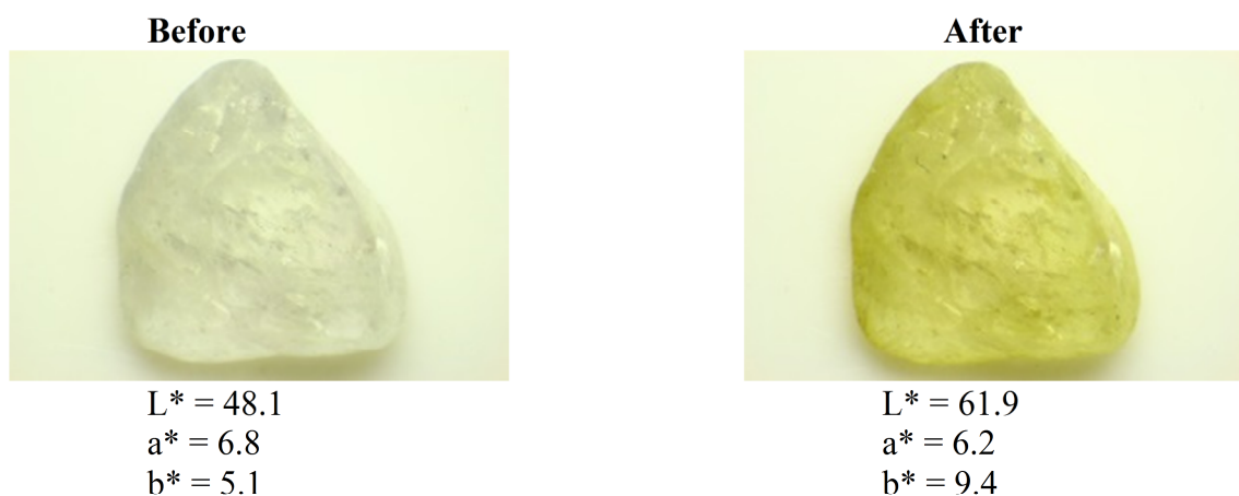
รูปที่ 4.38 พลอยตัวอย่าง Gueda01 แซฟไฟร์ไม่มีสี เนื้อขุน จากแหล่งศรีลังกา ก่อนและหลังการปรับปรุงคุณภาพด้วยเทคนิคไนโตรเจนไอออนออบอ่อน
