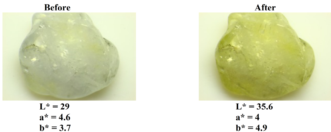
รูปที่ 4.46 พลอยตัวอย่าง Gueda03 แซฟไฟร์ไม่มีสี เนื้อขุนทิบ จากแหล่งศรีลังกา ก่อนและหลังการปรับปรุงคุณภาพด้วยเทคนิคไนโตรเจนไอออนออบอ่อน
