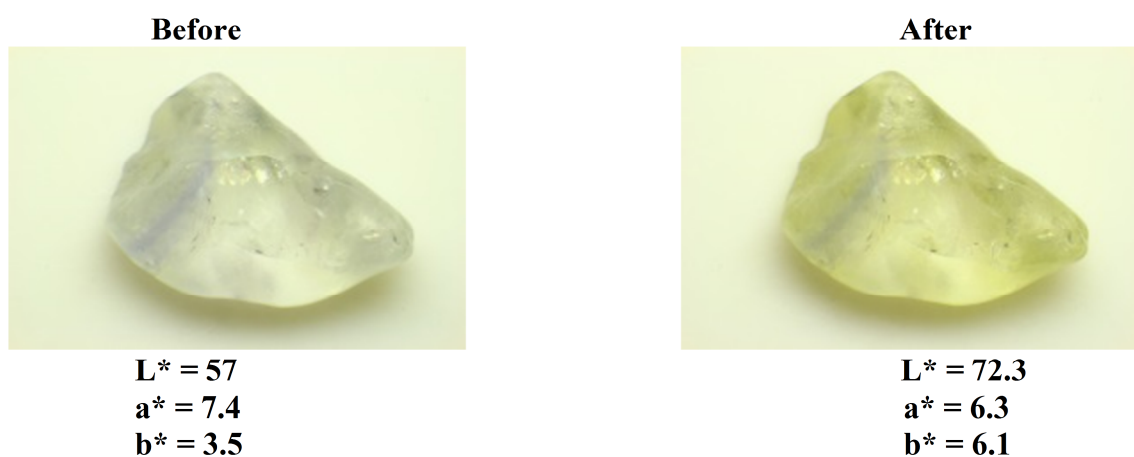
รูปที่ 4.54 พลอยตัวอย่าง Gueda05 แซฟไฟร์ไม่มีสี เนื้อใส จากแหล่งศรีลังกา ก่อนและหลังการปรับปรุงคุณภาพด้วยเทคนิคไนโตรเจนไอออนออบอ่อน
