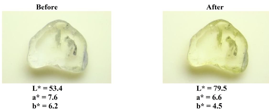
รูปที่ 4.50 พลอยตัวอย่าง Gueda04 แซฟไฟร์ไม่มีสี เนื้อใส จากแหล่งศรีลังกา ก่อนและหลังการปรับปรุงคุณภาพด้วยเทคนิคไนโตรเจนไอออนออบอ่อน
