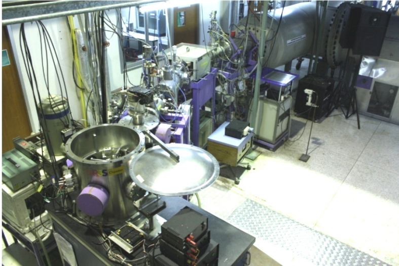
รูปที่ 2.5 เครื่องเร่งอนุภาคแทนเต็มขนาดศักย์ไฟฟ้าแรง 1.7 เมกะอิเล็กตรอนโวลต์ โดยที่รูปด้านขวาแสดง การติดตั้งพลอย และการเรืองแสงของพลอยเมื่อถูกยิงด้วยไอออน
