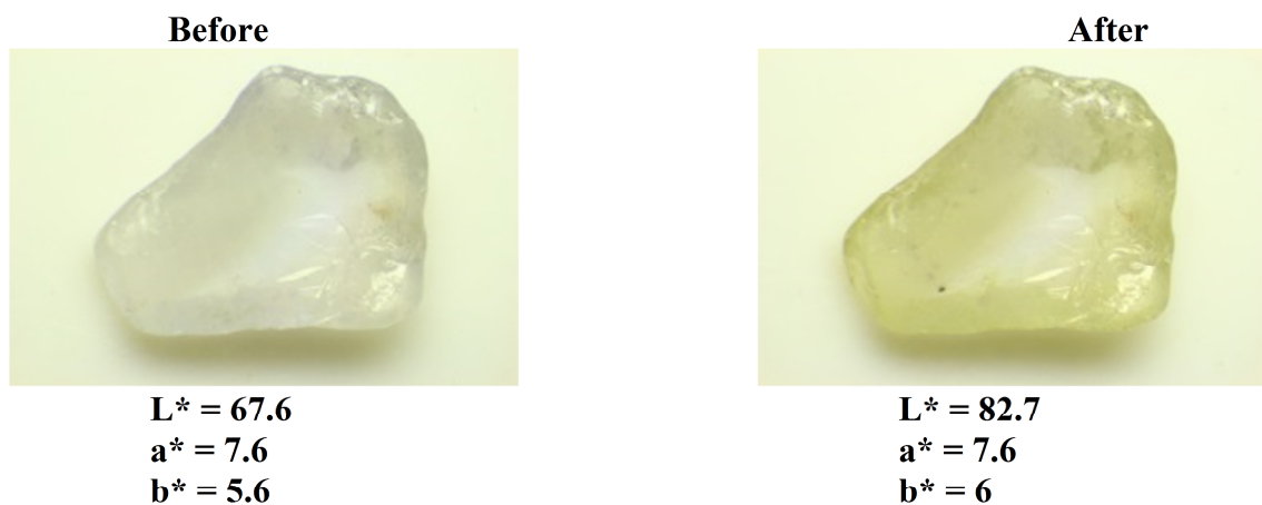
รูปที่ 4.42 พลอยตัวอย่าง Gueda02 แซฟไฟร์ไม่มีสี เนื้อใส จากแหล่งศรีลังกา ก่อนและหลังการปรับปรุงคุณภาพด้วยเทคนิคไนโตรเจนไอออนออบอ่อน
