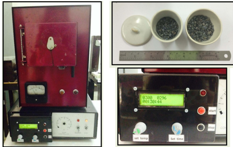
รูปที่ 3.16 เตาเผาขนาดเล็กอุณหภูมิสูงสุด 1,000 °C พัฒนาสำหรับนำมาอบพลอยที่อุณหภูมิต่ำ
