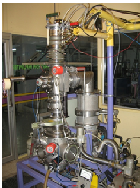
รูปที่ 2.4 เครื่องไอออนอิมพลานเตอร์ต้นแบบสำหรับงานพลอย โดยที่รูปด้านขวาแสดงการติดตั้งพลอย
