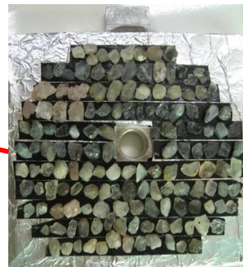
รูปที่ 2.3 เครื่องแวลวีนไอออนอิมพลานเตอร์ ศักย์ไฟฟ้าเร่ง 200 กิโลอิเล็กตรอนโวลต์และแผ่นวางพลอย
