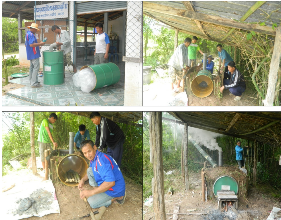
ภาพที่ 7 ; การอบรมสร้างเตาเผาถ่านคุณภาพด้วยถัง 200 ลิตร
