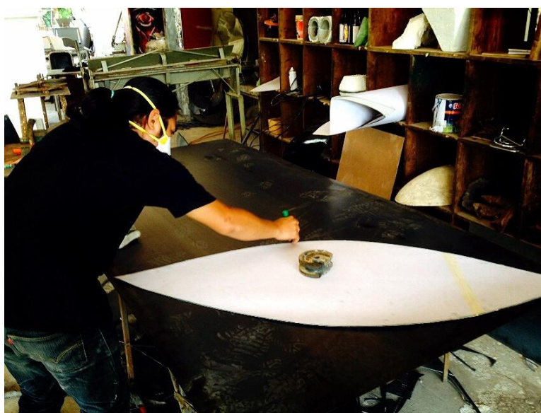
ภาพที่ 34 การถอดแบบขนาดจริงของผลงานลงบนกระดาษแข็งเพื่อเป็นต้นแบบตัดโลหะ ผลงานชิ้นที่ 1
