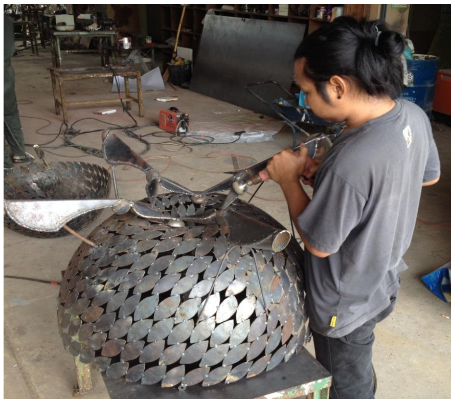
ภาพที่ 71 ประกอบรูปทรงย่อยเป็นรูปทรงที่สมบูรณ์ตามต้นแบบ ผลงานชิ้นที่ 3
