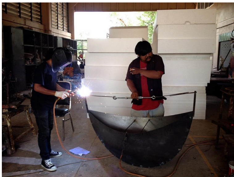
ภาพที่ 35 การประกอบโลหะที่ตัดเป็นรูปทรงย่อยตามต้นแบบ
