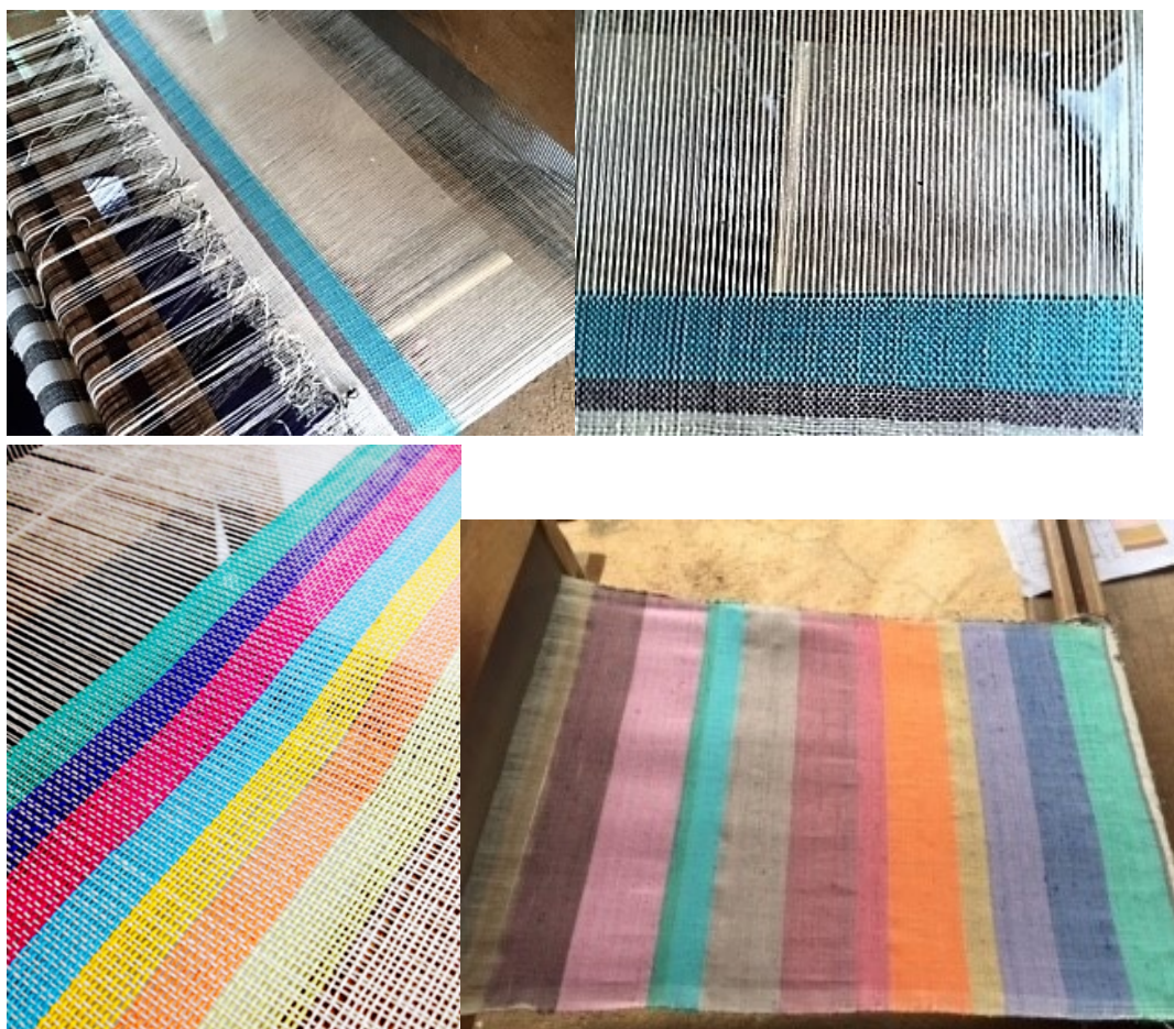
ภาพที่ 3.35 การทดลองทอผ้าทั้งฟิมถี่และฟิมห่าง
