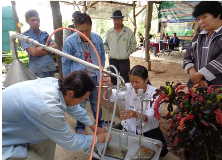
กรรมวิธี แยก น้ำมันหอมระเหย ออกจากน้ำกลั่นสกัดร้อน
