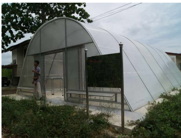
ภาพที่ 4.24 : ภาพผู้ตากพลังงานแสงอาทิตย์เหมาะสำหรับการตากปลาในช่วงที่ฝนตก
