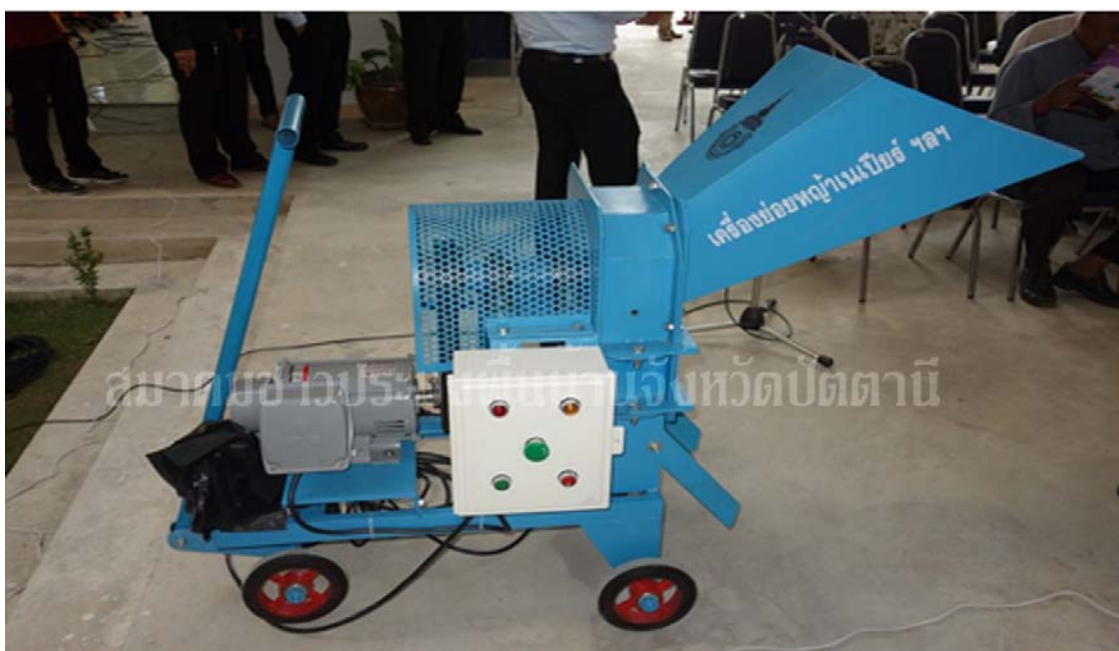
ภาพที่ 5.50: เครื่องต้นแบบในการย่อยกล้วยเนเปียร์ ที่จะมีการปรับวัสดุอุปกรณ์บางส่วนปรับให้เป็นเครื่อง สับปลาเพื่อเป็นเหยื่อในการเลี้ยงปลากระพงขาวในกะชัง
