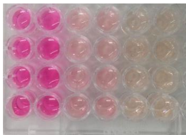
รูปที่ 6 แสดงการทำปฏิกิริยาของ TBARS reagent สีชมพูเข้มที่ปรากฏคือตัวอย่างที่ไม่มีสารต้านออกซิเดชัน และสีชมพูใสเป็นตัวอย่างทดสอบที่มีสารต้านออกซิเดชัน
