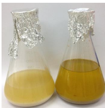
รูปที่ 3 สารสกัดกล้วยที่ผ่านการเขย่าเหวี่ยงนาน 72 ชั่วโมง และกรองสารสกัดออกจากส่วนตะกอนด้วยชุดกรองสุญญากาศ
