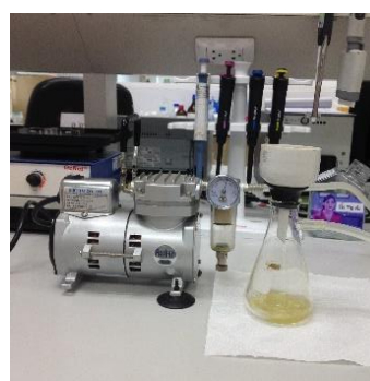
รูปที่ 3 สารสกัดกล้วยที่ผ่านการเขย่าเหวี่ยงนาน 72 ชั่วโมง และกรองสารสกัดออกจากส่วนตะกอนด้วยชุดกรองสุญญากาศ
