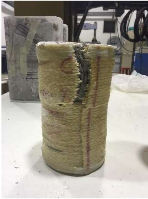
รูปที่ 3.1-51 การวิบัติของเสากลมพันด้วยป่านศรนารายณ์ 4 ชั้น
