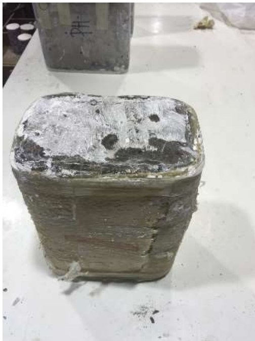
รูปที่ 3.1-58 การวัดของเสาสี่เหลี่ยมผืนผ้าพันด้วยเส้นใยป่านศรนารายณ์ 2 ชั้น
