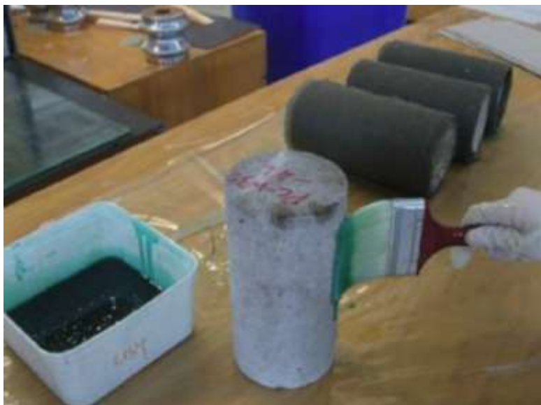
รูปที่ 3.1-14 ขั้นตอนทดสอบแบบแรงกดแกนเดียว
