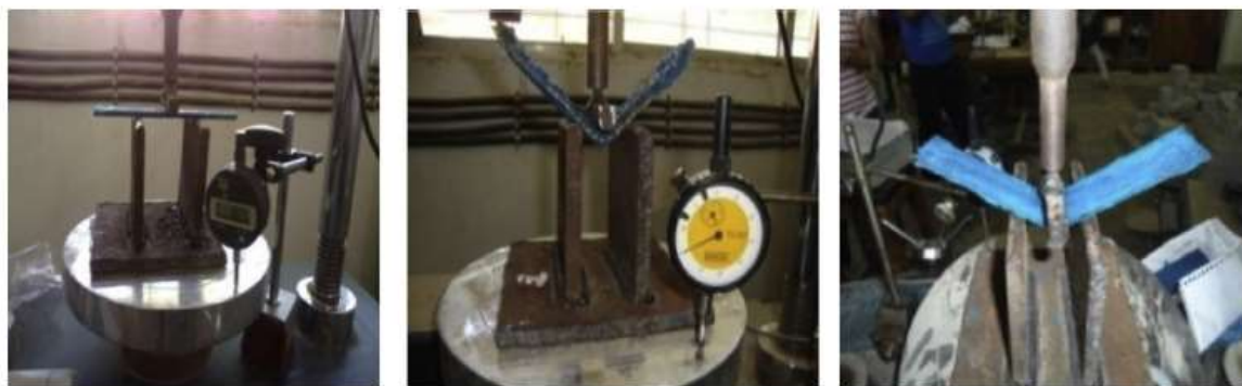
รูปที่ 3.1-8 การทดสอบแรงดัดแบบ 3-point bending test
