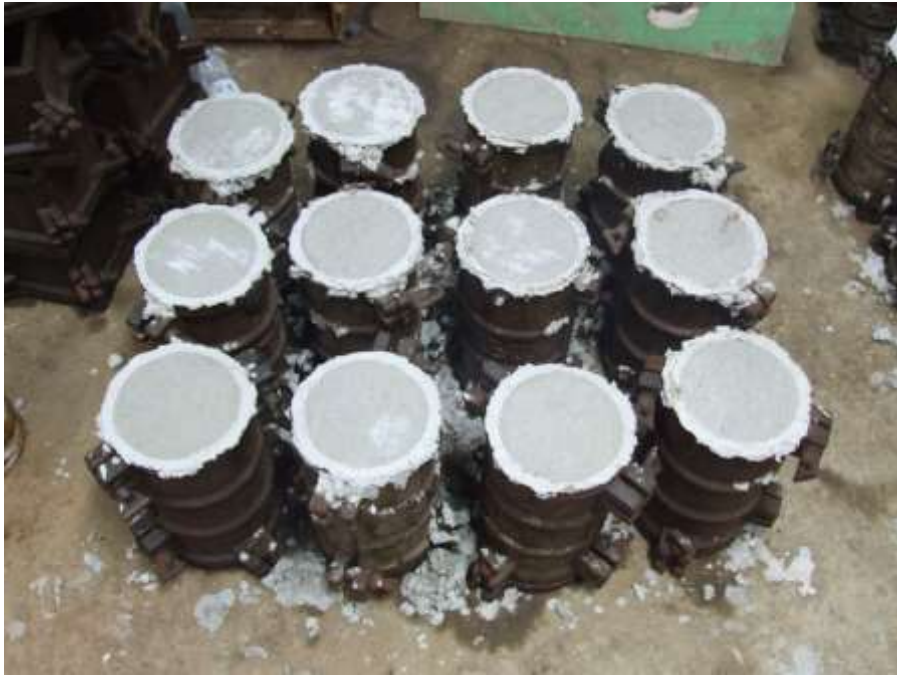
รูปที่ 3.1-38 การเทคอนกรีตในแบบหล่อเสาคอนกรีตหน้าตัดกลมขนาดเล็ก
