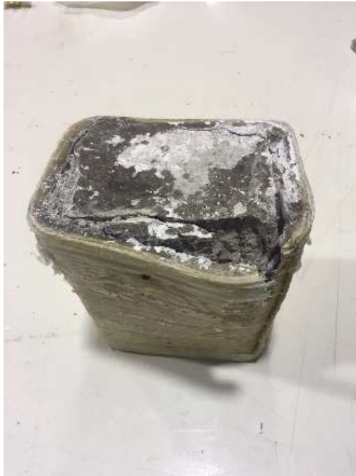
รูปที่ 3.1-59 การวิบัติของเสาสี่เหลี่ยมผืนผ้าพันด้วยเส้นใยป่านทราย 4 ชั้น
