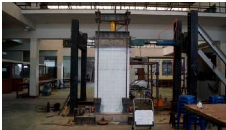
รูปที่ 2.2-21 การทดสอบผนังคอนกรีตสำเร็จรูป [ปรีดา และชยานนท์, 2558]
