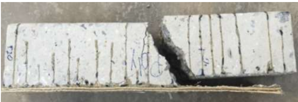
รูปที่ 3.1-72 การวิบัติที่เกิดขึ้นในคานที่เสริมกำลังด้วยเส้นใยปานศรนา-rayon 2 ชั้น
