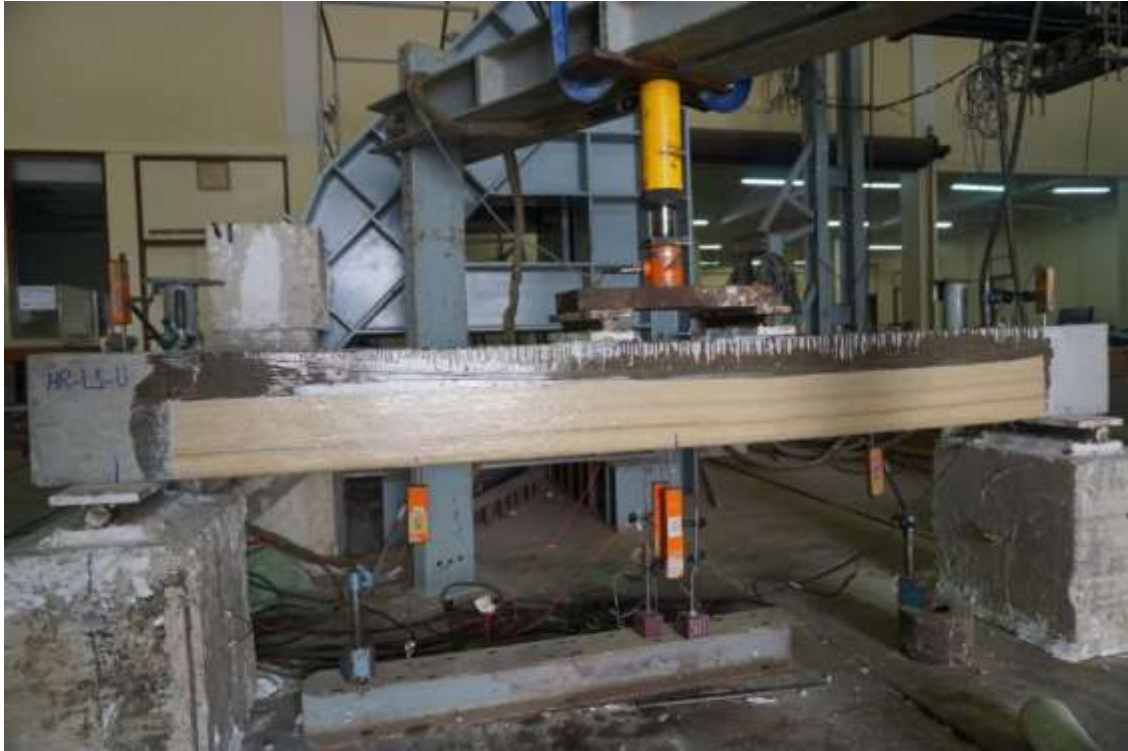
รูปที่ 3.1-80 การทดสอบและการติดตั้งเครื่องมือวัดการแอ่นตัวของคาน
