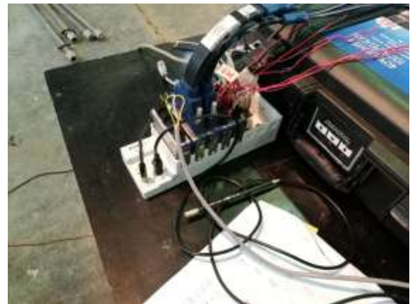
(ข) เครื่อง Data Logger A/D Conversion
