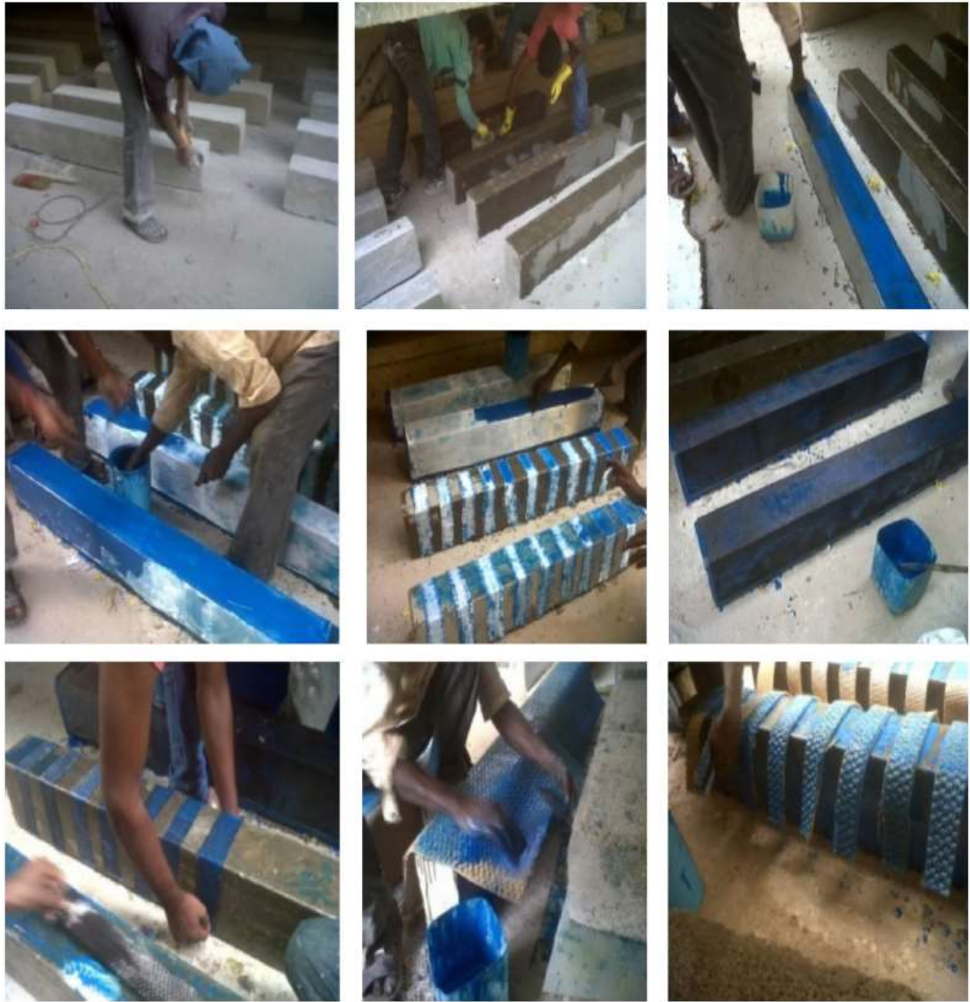
รูปที่ 3.1-11 ขั้นตอนการเสริมกำลังชิ้นตัวอย่างด้วยเส้นใยธรรมชาติ
