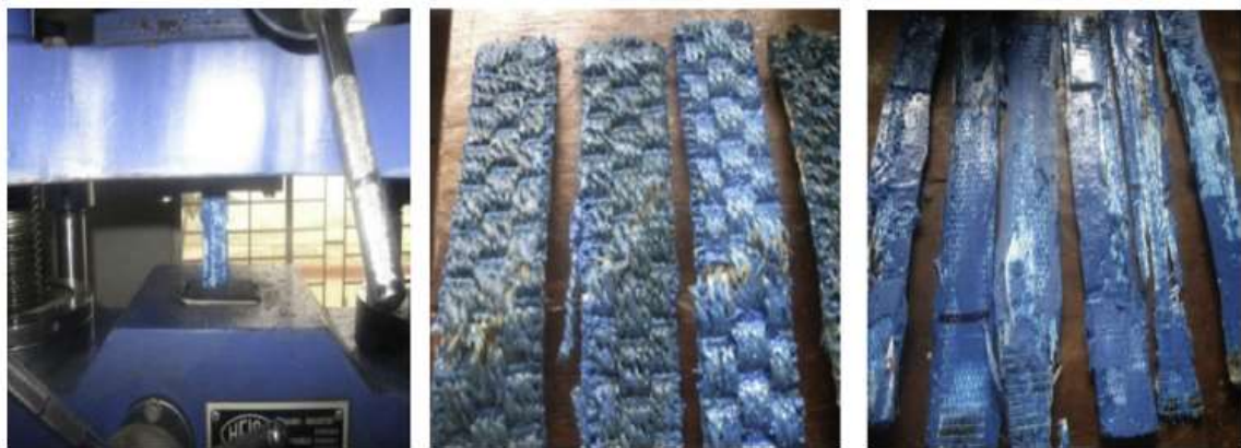
รูปที่ 3.1-7 การทดลองการรับแรงดึงและรูปแบบการวิบัติของชิ้นทดสอบที่เสริมด้วยเส้นใยปานครนารายณ์
