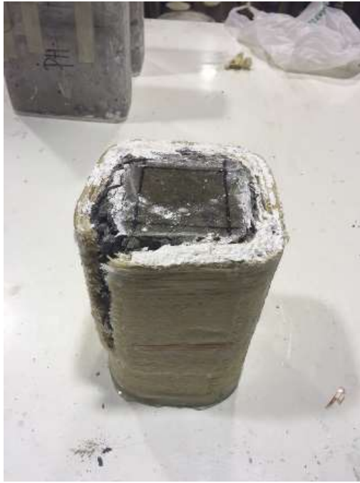
รูปที่ 3.1-55 การวิบัติของเสาสี่เหลี่ยมจตุรัสพันด้วยป่านคาร์บอนรายณ์ 4 ชั้น
