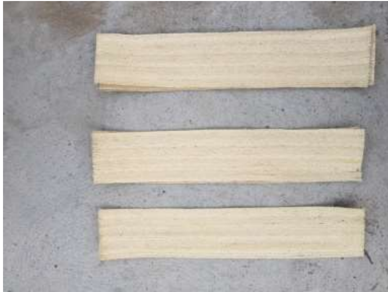
รูปที่ 3.1-64 แผ่นเส้นใยป่านศรนารายณ์ที่ใช้ในการเสริมกำลัง
