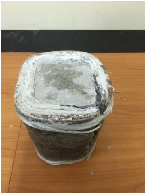
รูปที่ 3.1-57 การวัดของเสาสี่เหลี่ยมจตุรัสพันด้วยเส้นใยแก้ว 4 ชั้น
