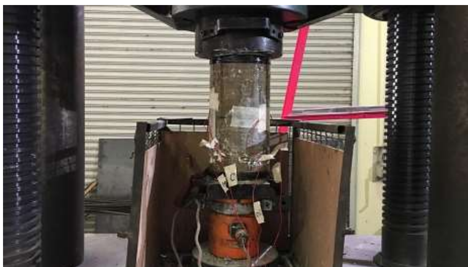
รูปที่ 3.2-7 การทดสอบก้อนปูนมาตรฐานที่มีการพันด้วยเส้นใยธรรมชาติ
