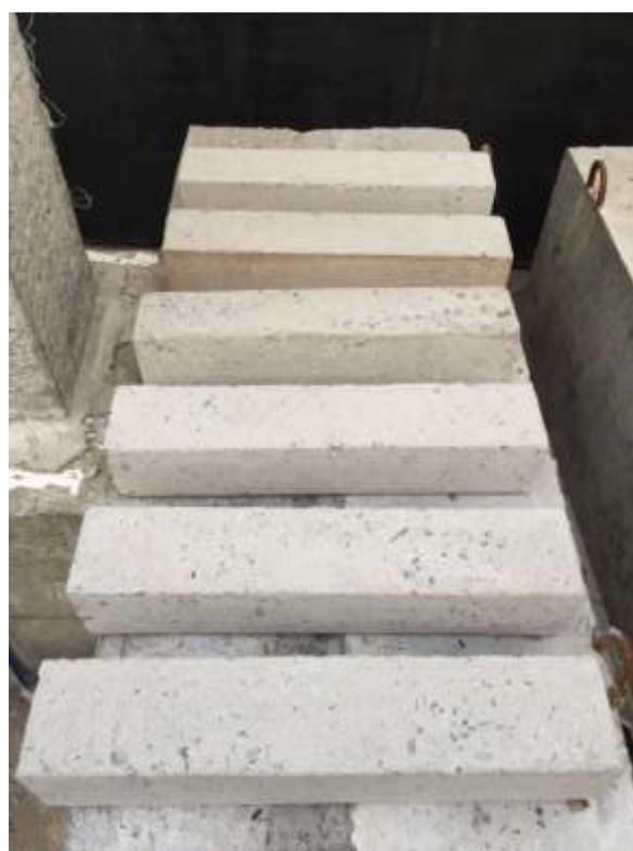
รูปที่ 3.1-63 คานคอนกรีตที่หล่อเรียบร้อยแล้ว
