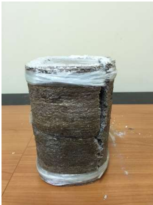
รูปที่ 3.1-56 การวิบัติของเสาสี่เหลี่ยมจตุรัสพันด้วยเส้นใยแก้ว 2 ชั้น
