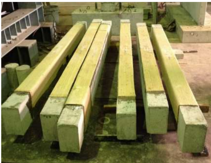
รูปที่ 3.1-79 คานที่ได้เสริมกำลังด้วยแผ่นเส้นใยปानครนารายณ์
