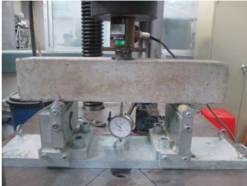
รูปที่ 3.1-66 การติดตั้งเครื่องมือทดสอบ
