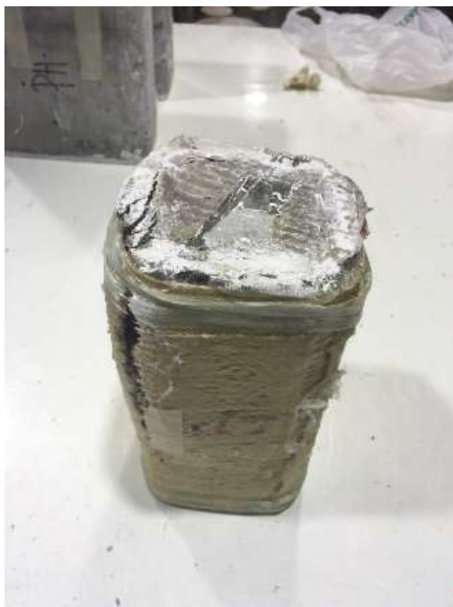
รูปที่ 3.1-54 การหุ้มของเสาสี่เหลี่ยมจัตุรัสพันด้วยป่านศรนารายณ์ 2 ชั้น
