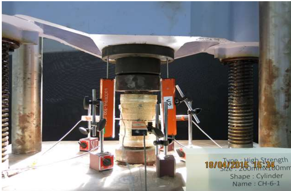
รูปที่ 3.1-43 การติดตั้งชิ้นทดสอบ
