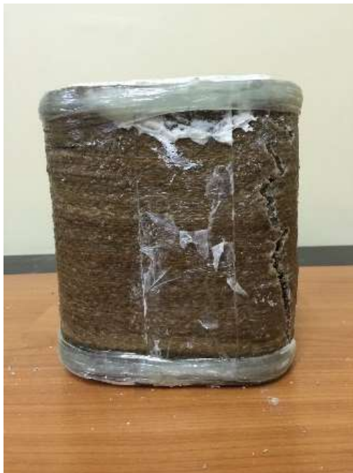
รูปที่ 3.1-60 การวิบัติของเสาสี่เหลี่ยมผืนผ้าพันด้วยเส้นใยกล้วย 2 ชั้น
