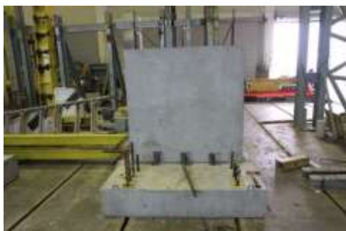
(จ) หลังการติดตั้งผนังเข้ากับฐานราก
