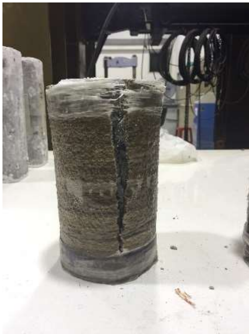
รูปที่ 3.1-52 การวิบัติของเสากลมพันด้วยเส้นใยแก้ว 2 ชั้น
