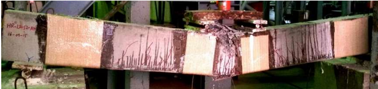
รูปที่ 3.1-94 การวิบัติของคาน HR-2LA-SEM
