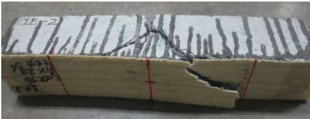
รูปที่ 3.1-71 การวิบัติที่เกิดขึ้นในคานที่เสริมกำลังด้วยเส้นใยปานศรนา-rayon 1 ชั้น
