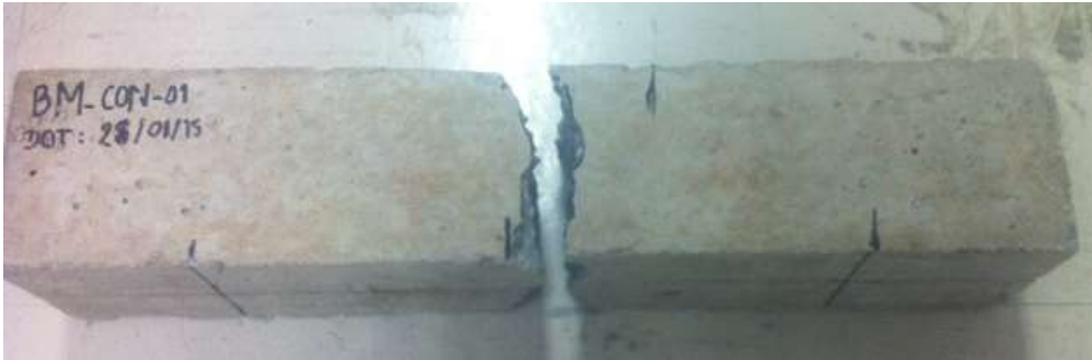
รูปที่ 3.1-70 การวิบัติที่เกิดขึ้นในคานควบคุม
