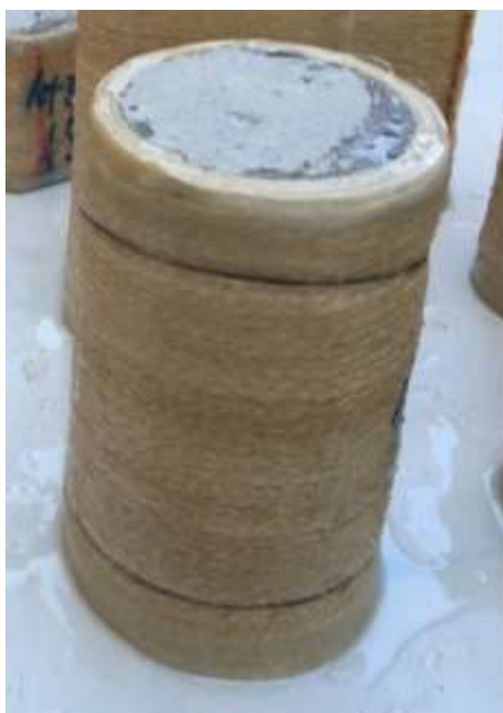
รูปที่ 3.1-42 ชันทดสอบที่ได้เสริมกำลังด้วยเส้นใยป่านศรนารายณ์แล้ว
