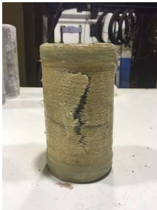
รูปที่ 3.1-50 การวิบัติของเสากลมพันด้วยป่านศรนารายณ์ 2 ชั้น
