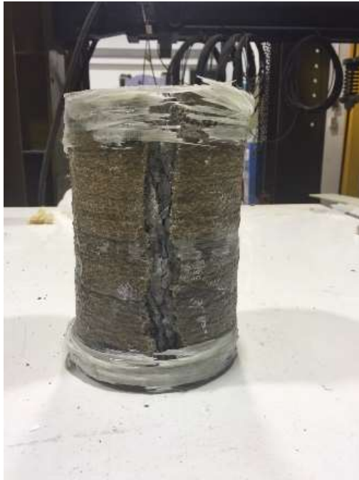
รูปที่ 3.1-53 การหุ้มของเสากลมพันด้วยเส้นใยแก้ว 4 ชั้น
