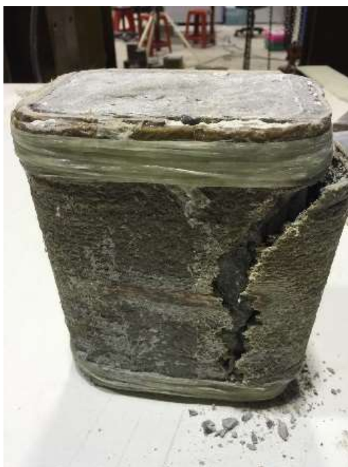
รูปที่ 3.1-61 การหุ้มของเสาสี่เหลี่ยมผืนผ้าพันด้วยเส้นใยแก้ว 4 ชั้น
