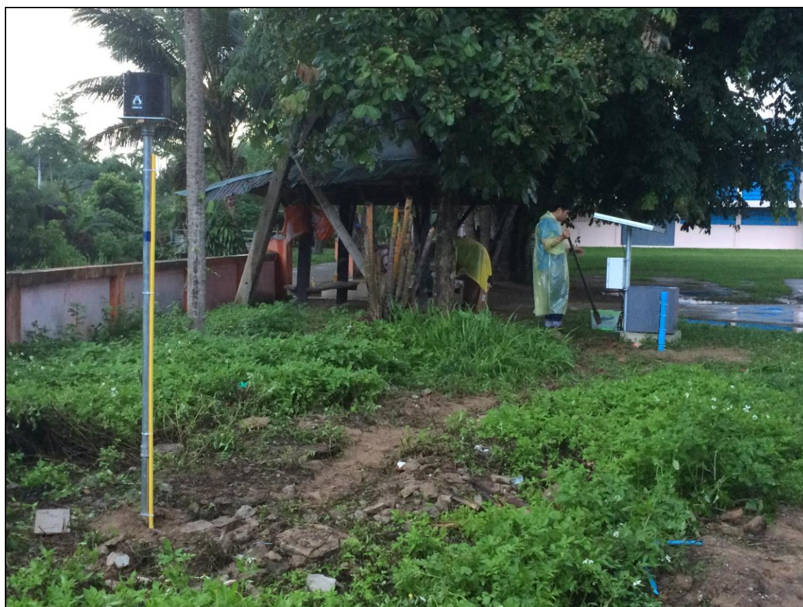
รูปที่ 4-3 สถานีวัดน้ำฝนแบบ real time ณ หลุมเจาะ BH-10
