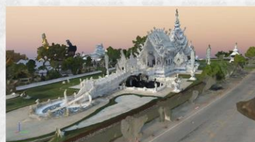
รูปที่ 4 แบบจำลองสามมิติสำหรับการวิเคราะห์โครงสร้างหลัก เพื่อนำไปจำลองโครงสร้างหลักด้วยวิธี Finite Element
