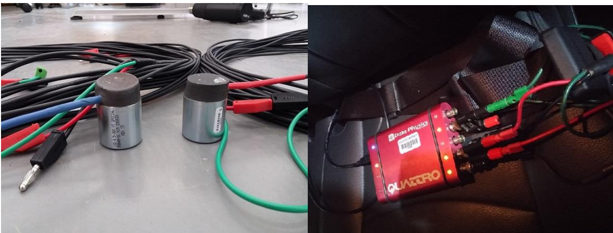
รูปที่ 5-5 ตัวรับสัญญาณคลื่นประเภท 4.5-Hz Geophone และเครื่องประมวลสัญญาณ (Spectrum Analyzer)
