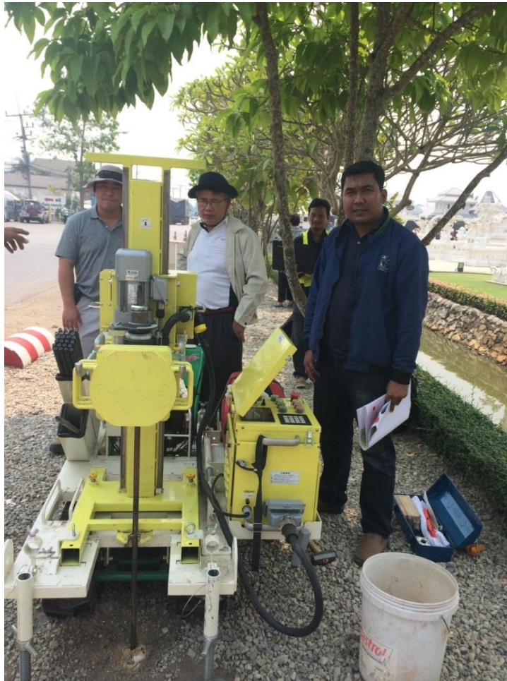
รูปที่ 9-2 เครื่องมือ Screw Driving Sounding (SDS) สำหรับทดสอบ liquefaction ในสนาม
