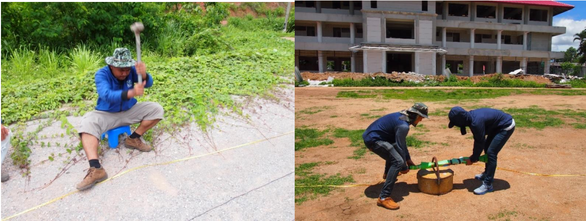
รูปที่ 5-4 แหล่งกำเนิดคลื่นประเภทค้อนปอนด์และค้อนน้ำหนักขนาด 100 กิโลกรัม
