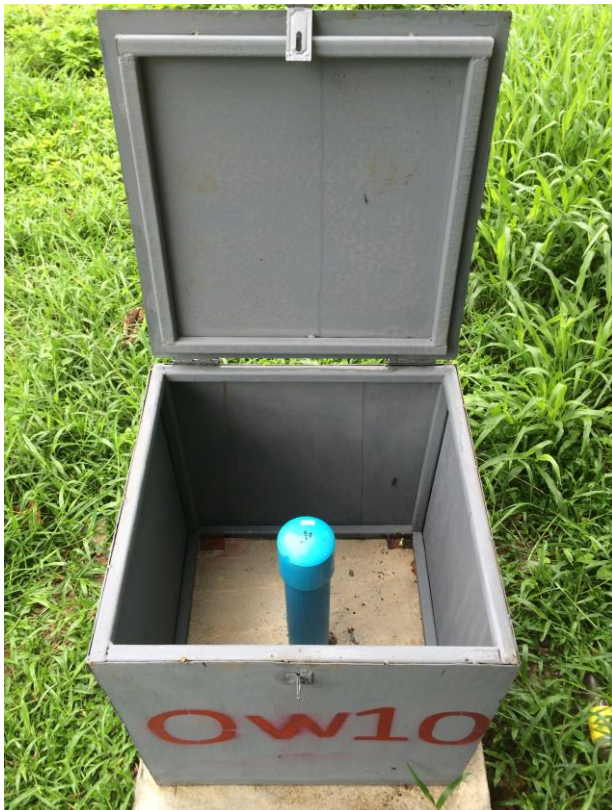
ปิดฝาครอบท่อ PVC และทำโครงเหล็กกัน
