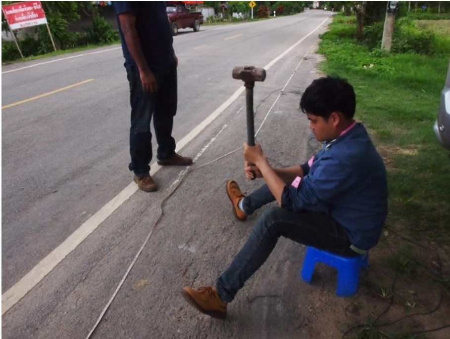
รูปที่ 5-27 ภาพถ่ายการทดสอบ SASW บริเวณไหล่ทางของถนนที่อยู่ด้านทิศใต้ของวัดสันตันม่วง
