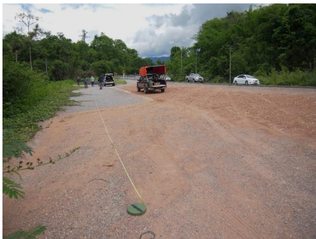
รูปที่ 5-51 ภาพถ่ายการทดสอบ SASW บริเวณถนนสาย 118
