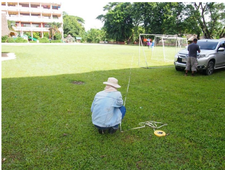
รูปที่ 5-39 ภาพถ่ายการทดสอบ SASW บริเวณโรงเรียนบ้านทรายขาว
