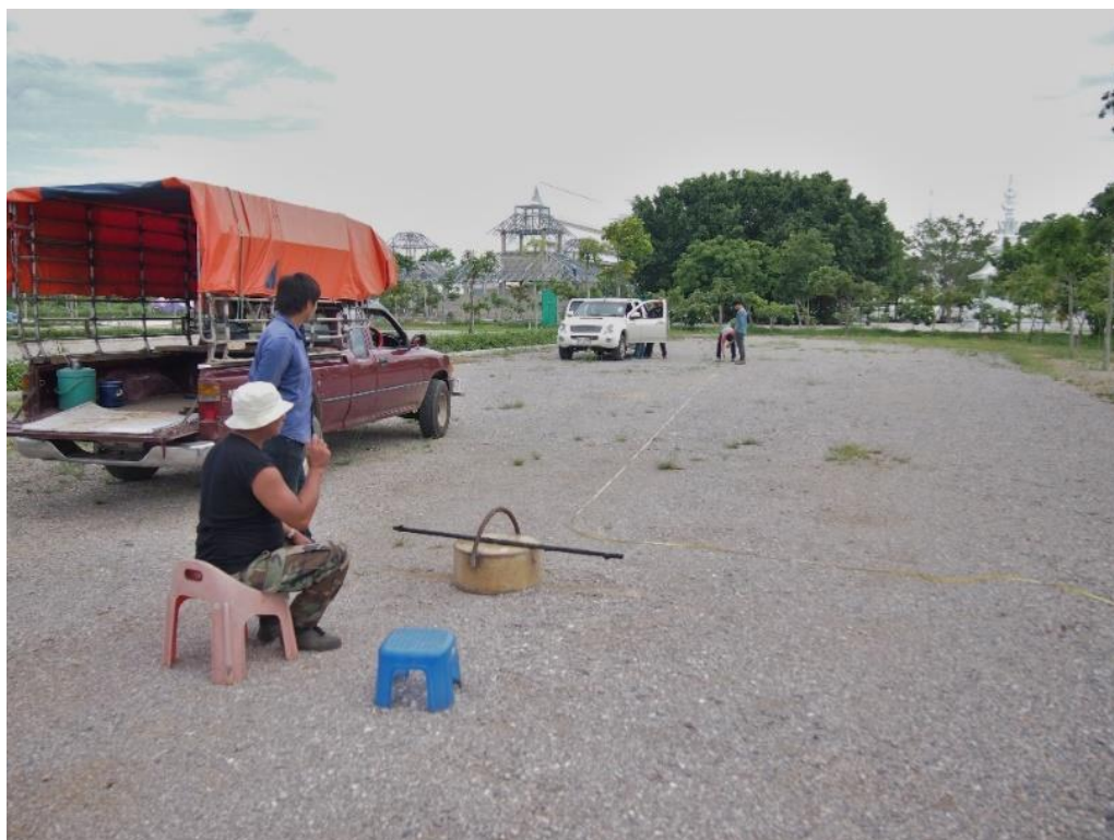
รูปที่ 5-7 ภาพถ่ายภาพการทดสอบ SASW บริเวณลานจอดรถด้านทิศใต้ของวัดร่องขุน
