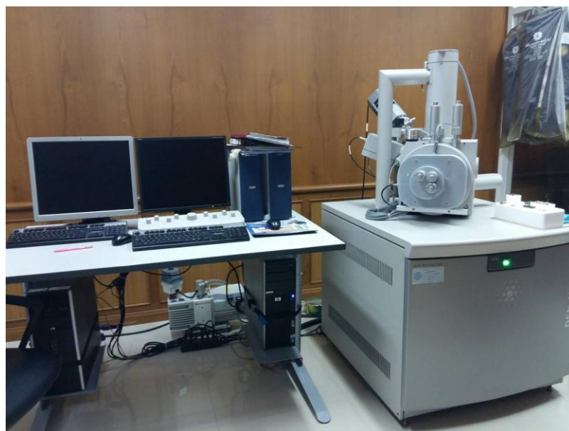
ภาพที่ 3.1 เครื่องวิเคราะห์พื้นผิวด้วยกล้องจุลทรรศน์อิเล็กตรอนแบบส่องกราด (SEM FEI QUANTA 450)
