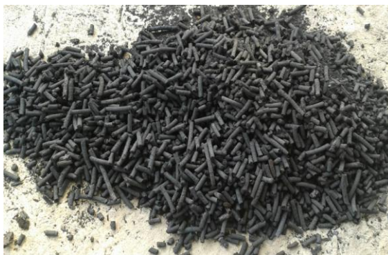
ภาพที่ 3.7 ถ่านชาร์ขานอ้อยที่ได้จากการเผาที่อุณหภูมิ 400 °C, 500 °C และ 600 °C เป็นเวลา 60 นาที
