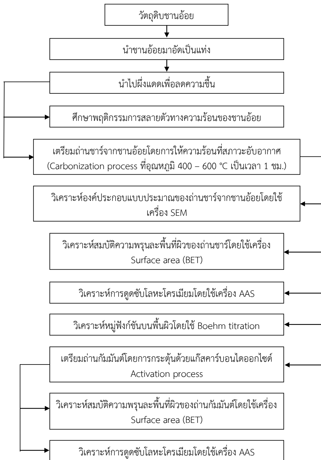
ภาพที่ 3.4 ขั้นตอนในการดำเนินการผลิตถ่านกัมมันต์
