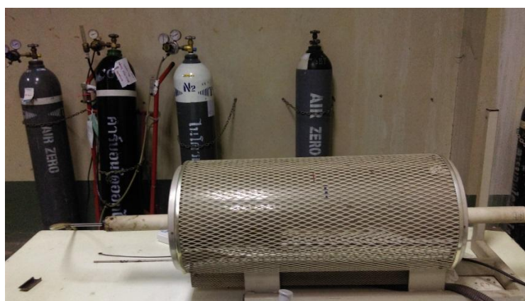
ภาพที่ 3.13 ถ่านชาร์ใส่ในเตาเผา Tube furnace เพื่อกระตุ้นด้วยวิธีทางกายภาพ
