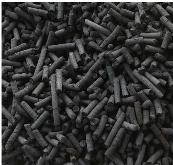
ภาพที่ 3.14 ถ่านกัมมันต์ขานอ้อยหลังจากถูกกระตุ้นที่ 900 °C เป็นเวลา 2 ชั่วโมง
