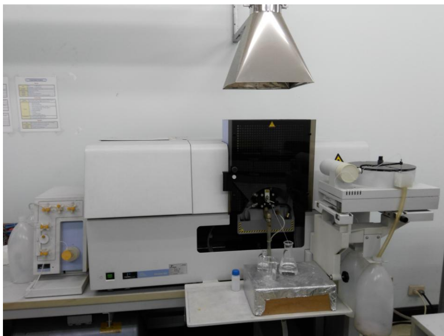
ภาพที่ 3.3 เครื่องวัดปริมาณการดูดซับโลหะหนัก (AAS) (Analyse 800 Perkin)
