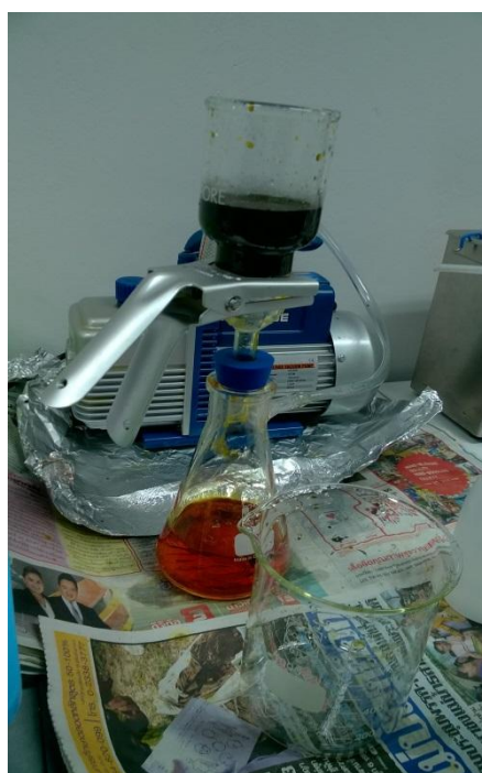
ภาพที่ 3.10 การกรองถ่านออกจากสารละลายโครเมียมด้วยเครื่องกรองสารระบบสุญญากาศ
