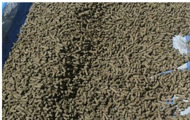
ภาพที่ 3.5 ขานอ้อยอัดเป็นแท่งสำหรับการนำไปเผาเป็นถ่านชาร์
