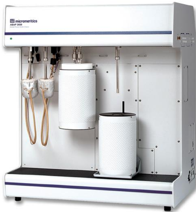
ภาพที่ 3.2 เครื่องวัดพื้นที่ผิวจำเพาะและขนาดรูพรุน (micromeritics, ASAP 2010)
