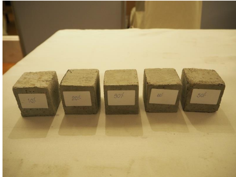
ภาพที่ 3.24 ผลผลิตคอนกรีตที่ผลิตจากขี้เถ้าขานอ้อย (ขี้เถ้าขาว) และถ่านชาร์ (ขี้เถ้าดำ) ที่ได้จากการทดลอง
