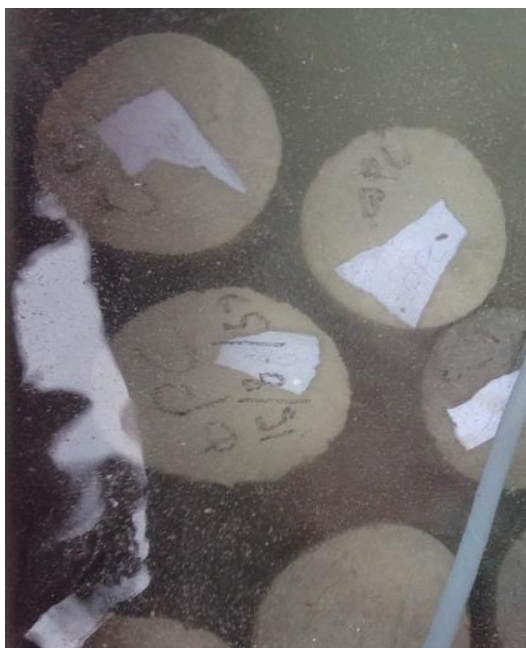
ภาพที่ 3.14 คอนกรีตหลังจากแกะแบบและปัมน้ำ
