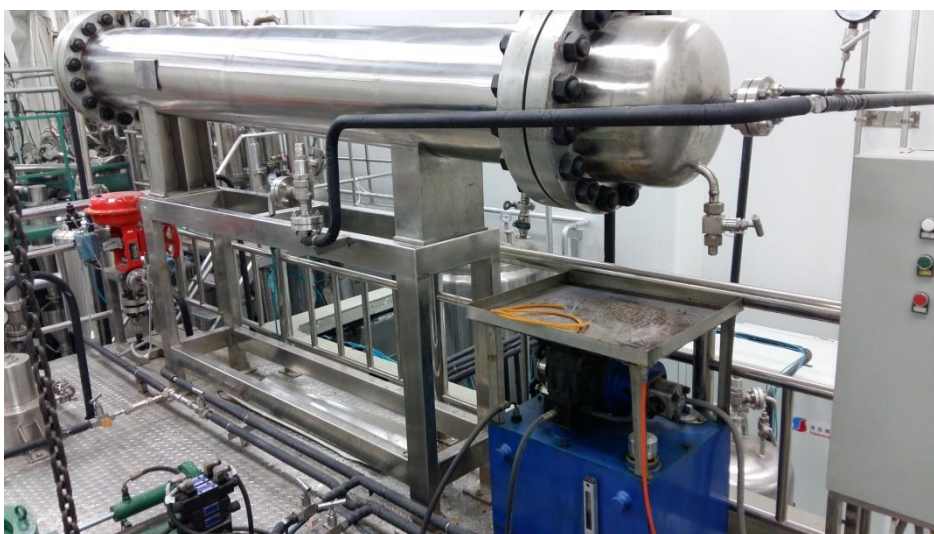
ภาพที่ 33 เครื่อง Supercritical CO 2 Extraction ส่วนอุปกรณ์แลกเปลี่ยนความร้อน
