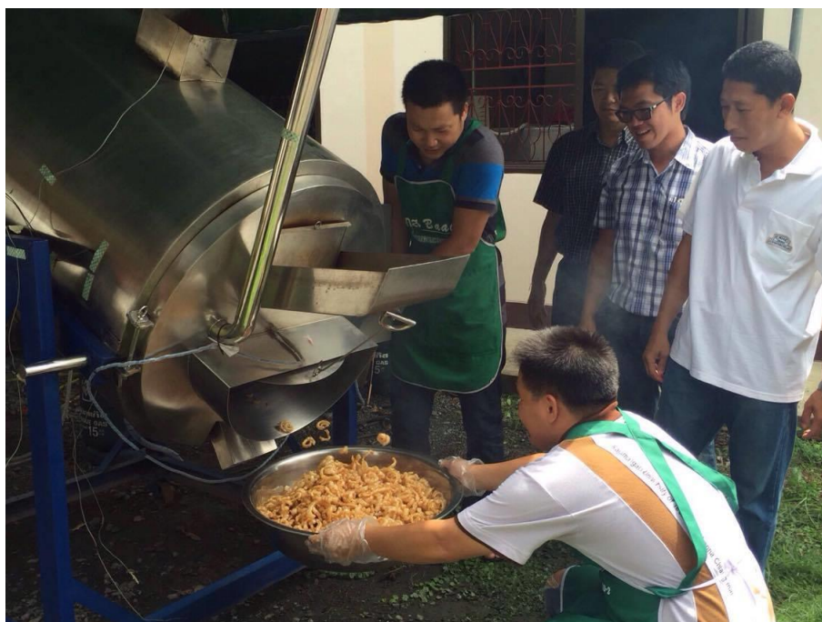
รูปที่ ฉ.4 การอธิบายหลักการทำงานและขั้นตอนการอบพองแคบหมู ที่อุณหภูมิ 220 °C ความเร็วรอบ 24 rpm เวลา 5 min
