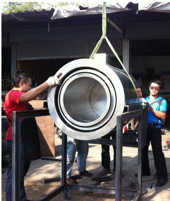
รูปที่ 3.12 ชุดถัง (ถังอบพองแคบหมู ถังหมุน ถังชั้นนอก และฝาหน้าเครื่อง)
