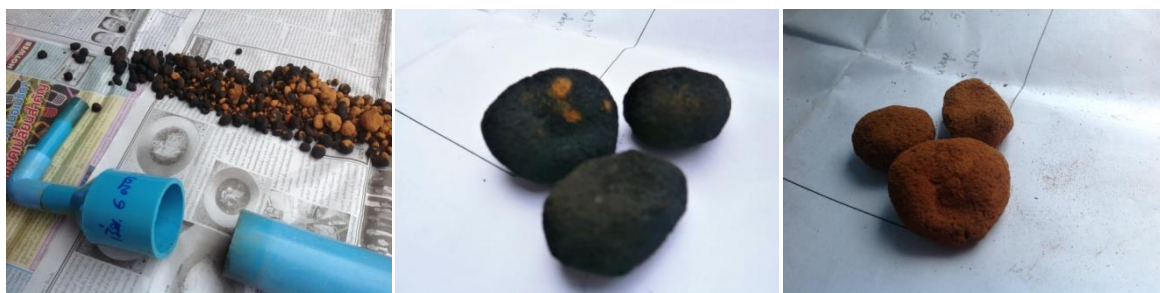
ภาพ 1-3 (1) คอลัมน์การบรรจุตัวกำจัดภายหลังใช้งาน 15 วัน, (2) ตัวกำจัดที่ทำปฏิกิริยากลายเป็น \text{Fe}_2\text{S}_3 และ (3) ตัวกำจัดที่คืนสภาพเดิม ( \text{Fe}_2\text{O}_3 ) ภายหลังได้รับอากาศ 3 ชั่วโมง (เจษฎา มิ่งฉาย และคณะ, 2556)
