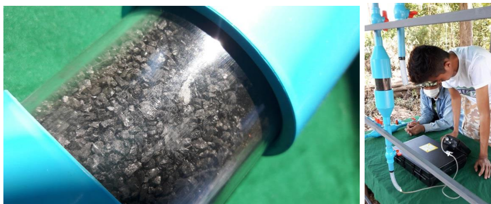
ภาพ 41-42 การทดลองชุดกำจัดก๊าซไฮโดรเจนซัลไฟด์ในก๊าซชีวภาพด้วยถ่านกัมมันต์ (T1)
