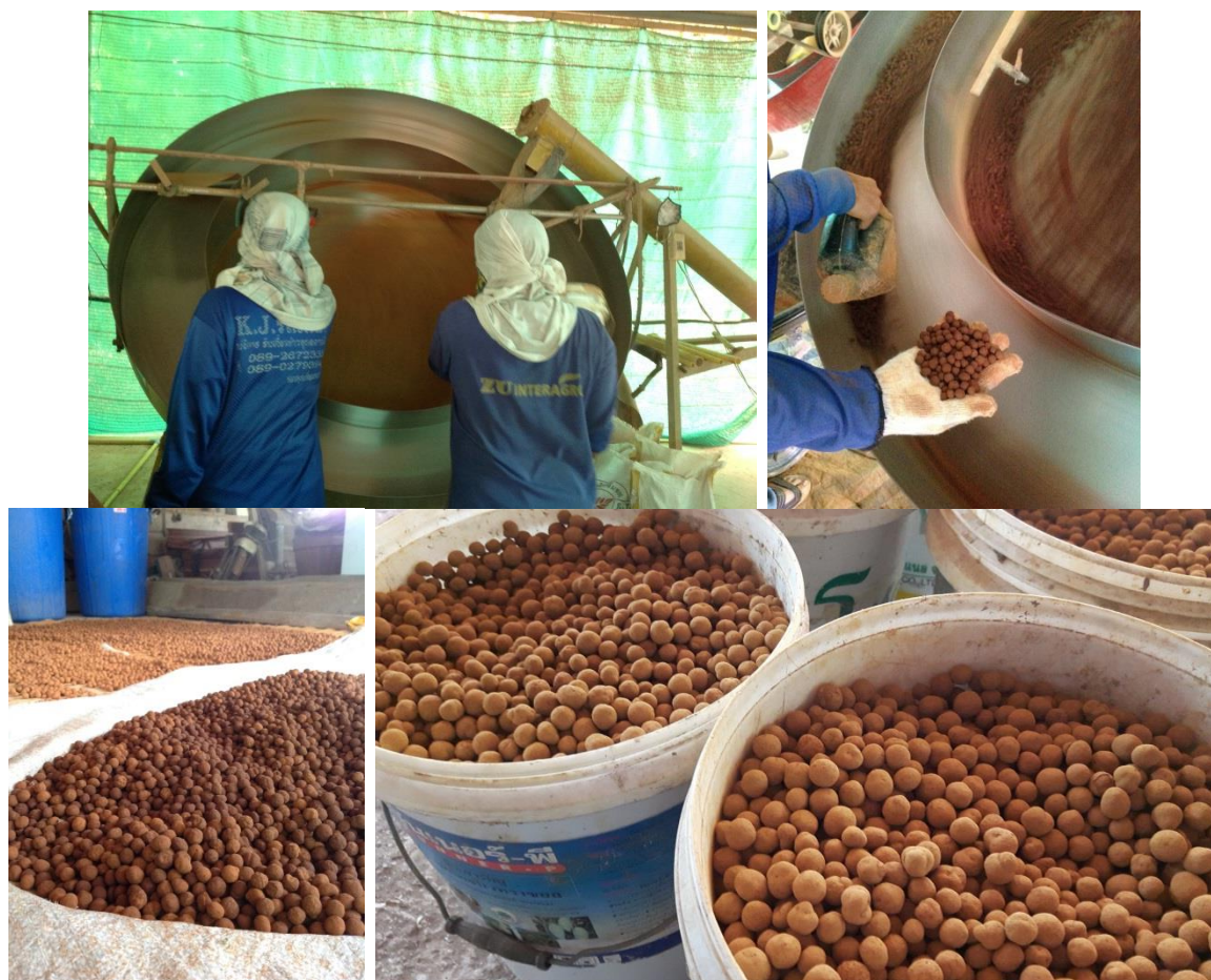
ภาพ 26-29 การขึ้นรูปวัตถุดิบและการคัดแยกคุณภาพเม็ดผลึกออกไซด์
