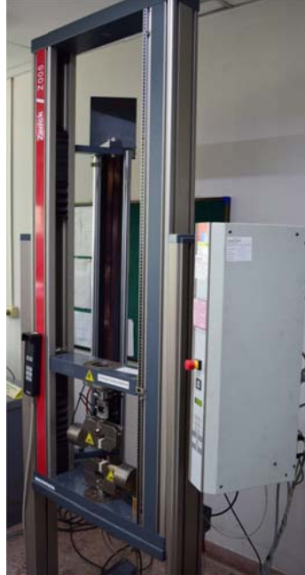
รูปที่ 2.1 Tensile testing machine Zwick Z005 equipped with Optical extensometer สำหรับวัดความต้านแรงดึงและความยืดเมื่อขาดของถุงมือยาง
