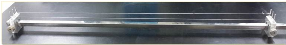
รูปที่ 2.4 อุปกรณ์สำหรับการทดสอบการยืดอยู่ตัว (Tension set)
