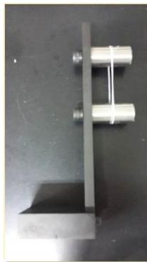
รูปที่ 2.2 เครื่องม้วนเป็นวง (Loop forming machine)
