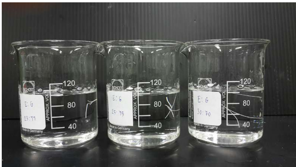
รูปที่ 3.3 เส้นด้ายยาง C1/90 ที่ทดสอบตาม ISO 2321:2006 Method A
