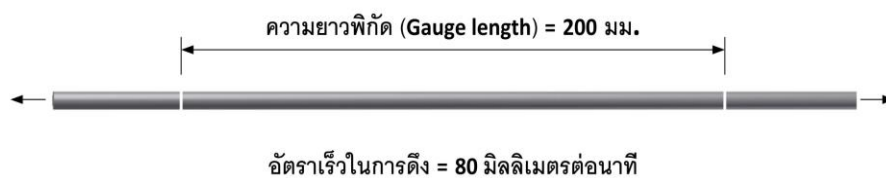
รูปที่ 2.8 ขั้นตอนทดสอบเส้นลวดและตำแหน่งการทำเครื่องหมายความพิกัด
