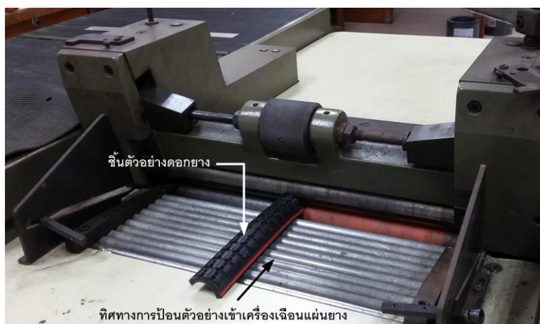
รูปที่ 2.12 การเตรียมชิ้นทดสอบแผ่นบางจากยางนอกรถจักรยานด้วยเครื่องเจียนแผ่นยาง
