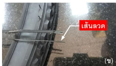
รูปที่ 2.7 (ก) ตัดขอบยางออกตามแนวเส้นรอบวง (ข) แยกเส้นลวดออกจากเนื้อของยาง
