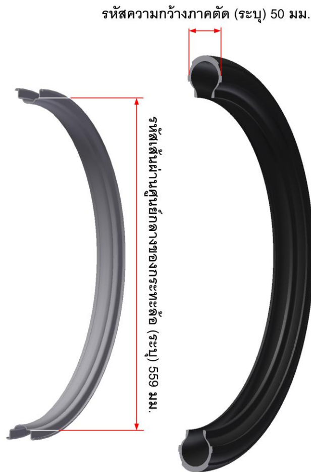
รูปที่ 3.1 ชื่อขนาดยางนอกรถจักรยานแบบขอบตรง 50-559
