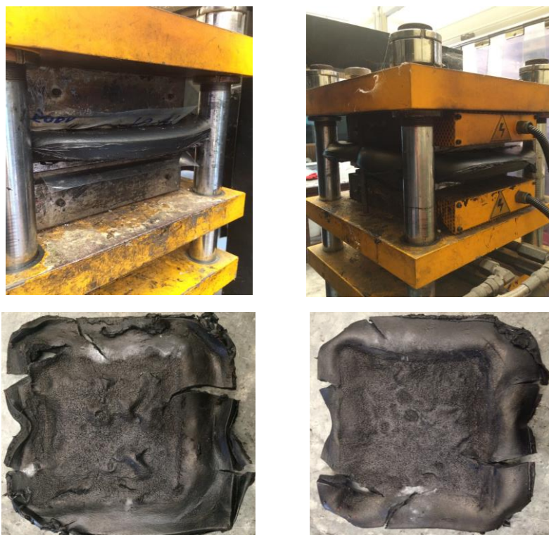
รูปที่ 4.8 ชิ้นงานวัสดุเชิงประกอบยางธรรมชาติ และวัสดุเชิงประกอบยางธรรมชาติผสมผงซีลีเนียม ที่เติมสารตัวเติมชนิดกรดบอริกที่ความหนา 10 มิลลิเมตร
