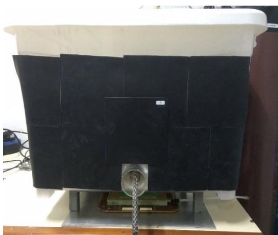
รูปที่ 3.19 ทดสอบวัสดุเชิงประกอบยางธรรมชาติที่มีสารตัวเติมป้องกันรังสีทดลองใช้กำบัง อนุภาคนิวตรอน
